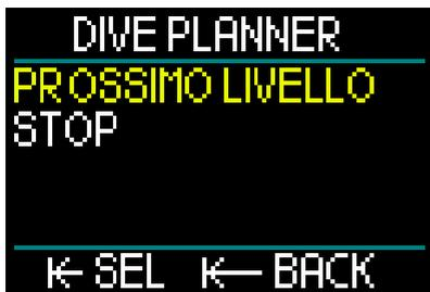
Al termine del tempo di simulazione, è possibile proseguire al prossimo livello di profondità e tempo o arrestare la simulazione. Se il tempo di simulazione non è ancora trascorso, non è possibile passare al prossimo livello, si può solo arrestare il pianificatore immersione (premendo il pulsante a rotella e ritornando al menu Principale).
