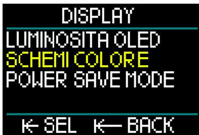
HUD consente di regolare la luminosità dello schermo OLED e di scegliere tra gli schemi colore per la visualizzazione dei dati di immersione.
