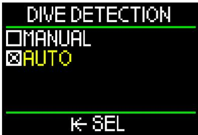
Se impostato su AUTO, HUD si accende automaticamente quando l'apposito sensore rileva la pressione dell'acqua.
