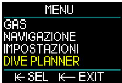
Con il pianificatore è possibile pianificare l'immersione successiva in base al livello di saturazione di azoto presente nel proprio corpo. Inoltre è utile per familiarizzare con il funzionamento di HUD durante l'immersione.
