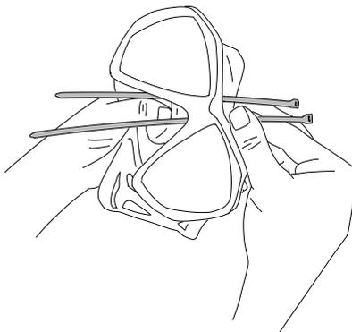
Dirigere una fascetta lungo il lato sinistro del naso e una lungo il lato destro. Al termine, ricontrollare che le fascette siano state inserite correttamente.
