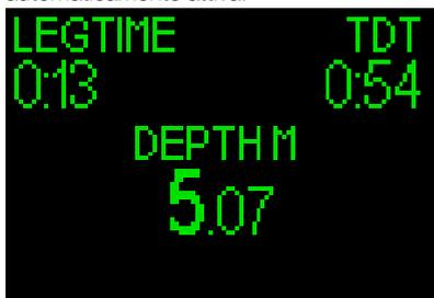
Il Legtime, indicato nell'angolo superiore sinistro della schermata mostrata sopra, funziona come un cronometro, visualizzando Min:Sec. Premendo il pulsante a rotella, è possibile avviarlo o azzerarlo.
