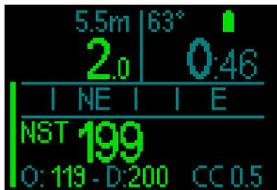
Esempio di una schermata che indica sulla riga inferiore a destra l'SP1 e a sinistra l'ossigeno/diluente.
