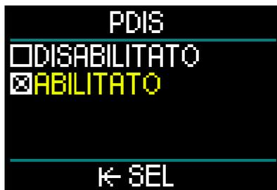
Questa funzione di HUD calcola una sosta intermedia in base alla quantità di azoto assorbito dal corpo, tenendo conto dell'immersione attuale, di quelle precedenti e delle miscele utilizzate. L'attivazione della funzione PDIS è possibile unicamente se ci si immerge con l'algoritmo ZHL-ADT. Quando si preme per salvare la selezione, il dispositivo ritorna alla schermata del menu Impostazioni immersione.
