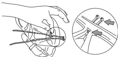
Se la maschera non richiede la sfera, proseguire con il passaggio 6. Se la richiede, inserirla dall'interno, nel punto più alto sopra la sagomatura per il naso, direttamente sotto il telaio in plastica rigida. Premerla nel silicone dietro le fascette, che dovrebbero mantenerla in sede e livellare l'eventuale eccesso di silicone.
