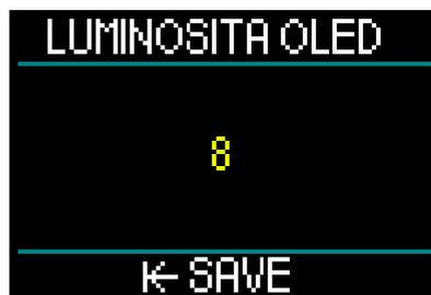
Ruotandolo è possibile selezionare l'impostazione di luminosità dello schermo da 0 (bassa) a 10 (massima) secondo le proprie preferenze.
