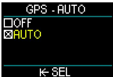
In modalità GPS AUTO, dalla schermata Superficie, ruotando il pulsante a rotella è possibile visualizzare l'ora attuale, la data e le coordinate GPS. Inoltre è visualizzata la rotta reale (True Heading, TH) verso il waypoint attualmente impostato e la distanza totale (Total Distance, TD) da quel waypoint.
