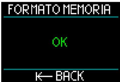
☞ *NOTA: se la comunicazione di HUD viene interrotta durante il processo di scrittura della memoria flash o se la batteria si scarica mentre la memoria flash è in uso, il contenuto di quest'ultima può risultare danneggiato. Anche in tale eventualità è possibile usare la funzione di formattazione della memoria.*
