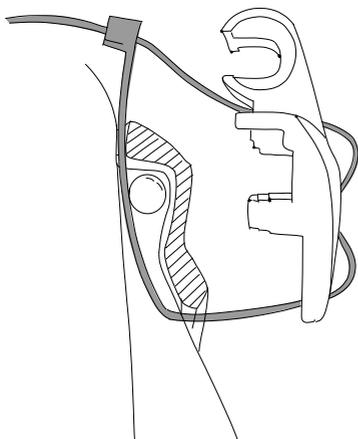
9. Per il serraggio finale, servirsi della pinza. Tirare in direzione verticale per evitare lo spostamento della testa della fascetta. Controllare che il supporto sia fissato saldamente e sia stabile e sicuro.
