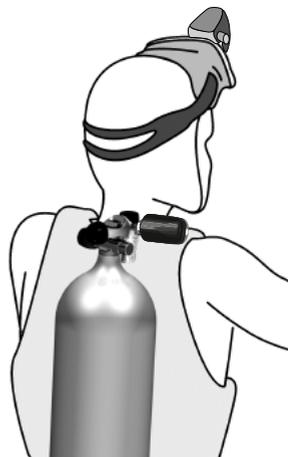
Affinché HUD visualizzi il segnale di pressione proveniente da una sonda Smart, occorre prima stabilire un collegamento codificato e privo di interferenze. Questo passaggio va eseguito solo una volta per ciascuna sonda.
