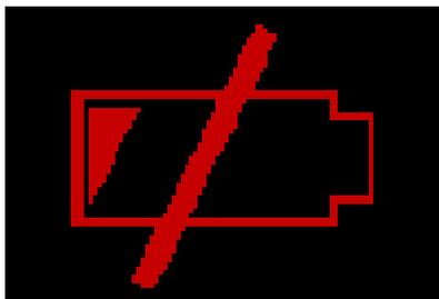
👉 **NOTA:** se HUD si spegne durante un'immersione a causa della batteria scarica, quando si ritorna in superficie e si collega il cavo di alimentazione per accenderlo, resterà bloccato in Modo Gauge per 48 ore. Non immergersi durante questo periodo perché le informazioni di decompressione dell'immersione precedente non sono disponibili.
