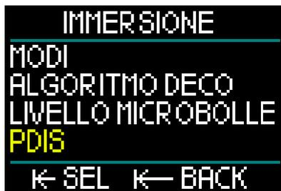
Dal menu Impostazioni immersione, selezionando PDIS e premendo il pulsante a rotella si accede alla schermata di attivazione delle Soste intermedie basate sul profilo d'immersione.
