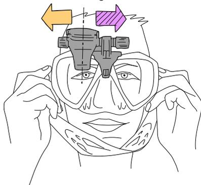
Nell'esempio in figura HUD va spostato a destra (freccia viola) per essere allineato alla linea visiva del subacqueo. Ciò significa che occorre ridurre la distanza tra HUD e il supporto. La regolazione si esegue facilmente spostando la posizione dei distanziatori (se è necessario muovere HUD a sinistra, freccia arancione, lo spostamento dei distanziatori avverrà in direzione opposta).
