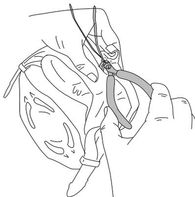
**NOTA:** se è necessario sostituire una fascetta, usarne una da 3,5 x 200 mm.
