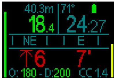
Esempio di una schermata che indica sulla riga inferiore a destra l'SP2 e a sinistra l'ossigeno/diluente.
