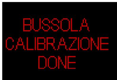
☞ **NOTA:** generalmente la bussola di HUD non ha bisogno di ricalibrazione. Tuttavia, se si nota una deviazione significativa permanente della direzione della bussola, eseguire la procedura di calibrazione.
