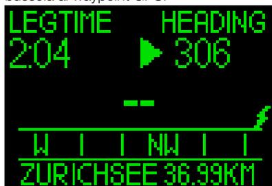
In Modo GPS viene visualizzata l'icona di un fulmine sul lato destro della schermata, proprio sopra la bussola, a indicare che il collegamento GPS è attivo.
