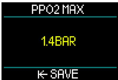
L'impostazione della  $ppO_2$  max determina il limite per la pressione parziale di ossigeno. È la stessa per tutti i gas. HUD consente di impostare la  $ppO_2$  max da 1,3 bar a 1,6 bar (1,4 bar è l'impostazione di fabbrica).
