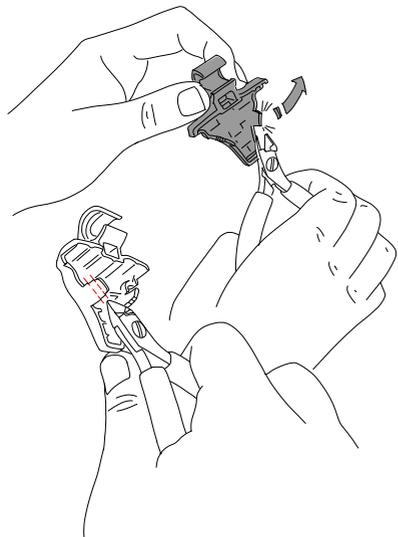
3. Una volta rifilati i piedini, ricontrollare il montaggio.
