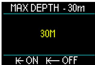
☞ *NOTA: quando l'allarme è attivo e impostato, la riga superiore indica MAX DEPTH 30 M. Quando l'allarme è disattivato, la riga superiore indica semplicemente MAX DEPTH.*
