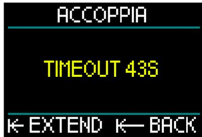
8. Mentre il conteggio è in esecuzione, aprire il rubinetto della bombola. Al momento della pressurizzazione la sonda Smart invierà a HUD una sequenza di accoppiamento.
