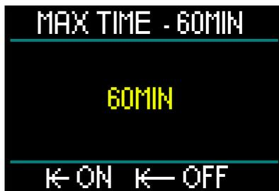
☞ *NOTA: quando l'allarme è attivo e impostato, la riga superiore indica TEMPO MASSIMO 60 MIN. Quando l'allarme è disattivato, la riga superiore indica semplicemente TEMPO MASSIMO.*
