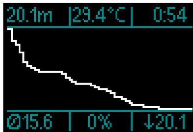
**Temperatura.** HUD visualizza la temperatura dell'acqua durante l'immersione e quella dell'aria in superficie.
