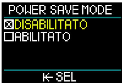
Per preservare l'autonomia della batteria durante l'immersione, è possibile abilitare la Modalità risparmio energetico (Power Save Mode).
