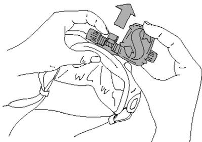
3. Ruotare lo schermo di HUD in una posizione in cui è possibile vederlo attraverso le lenti della maschera.
