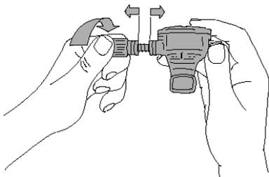
2. Inserire HUD nel supporto e serrare la manopola. Durante il serraggio i distanziatori vengono spinti in sede negli incavi delle ganasce del supporto.
