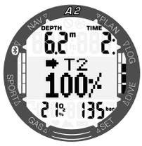
Per confermare il cambio gas, premere SEL/ESC. Una volta confermato il cambio gas, sullo schermo appare per 5 secondi il messaggio: **SWITCH TO T2** (CAMBIO A T2).
