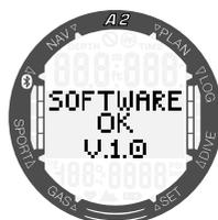
Ad aggiornamento riuscito, A2 visualizza il messaggio "Software OK", che si può eliminare premendo il pulsante SEL/ESC. A questo punto A2 può essere utilizzato normalmente.
