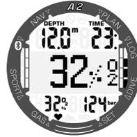
Der Sauerstoffanteil des Gasgemisches, gleich wie auf der unteren Zeile, aber in einem größeren Format.
