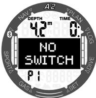
Die SP-Wechseltiefe wird vom Tauchcomputer auf dieselbe Art empfohlen, wie die Gaswechsel beim Tauchen mit offenem Kreislauf (vorausgeplanter Gaswechsel). Die Wechsellpunkte werden aus den äquivalenten Sauerstoffanteilen des offenen Kreislauf-Modus bestimmt. So erfolgt der Gaswechsel während der Abtauchens, wenn die Sauerstoffanteil auf dieser Tiefe die äquivalente Konzentration im Diluent-Gas erreicht. Mit SP1 auf 0,5
