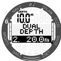
Der Wert des zweiten Alarms kann auf dieselbe Art eingerichtet werden, wie der erste Alarm. Oben links auf dem Display wird die Tiefe des ersten Alarms angezeigt.
