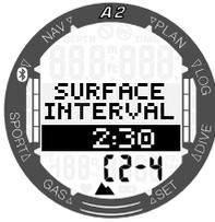
Der verbotene Höhenbereich wird nach der aktuellen Höhe auf der unteren Zeile angezeigt. Für weitere Informationen über das Tauchen in der Höhe mit dem A2 siehe Kapitel: **4.9 Tauchen in Höhenlagen**. Sollte der A2 eine Tauchverbotswarnung anzeigen, wird die verbleibende Dauer des Verbots als empfohlenes Oberflächenintervall angezeigt (aufgerundet auf die nächsten fünfzehn Minuten).
