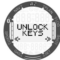
Entsperren durch erneutes, gleichzeitiges Drücken und Halten der Tasten SEL/ESC und -/DOWN.
