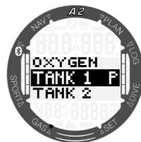
Verwenden Sie die Tasten +/UP oder -/DOWN, um den Tank auszuwählen, den Sie dem Sender zuordnen wollen und bestätigen Sie anschließend mit der Taste SEL/ESC. Der aktuelle Tankdruck des gepaarten Tanks wird auf der untersten Zeile entweder in BAR oder PSI angezeigt.
