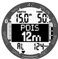
Bei einem Nullzeittauchgang wird, sobald Sie während eines Aufstiegs diese Tiefe erreichen, ein 2 Minuten dauernder Countdown angezeigt.
