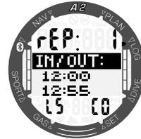
Anzahl der Wiederholungstauchgänge (Rep 1 ist der erste Tauchgang), Start- und Endzeit, MB-Level (L5) und der Höhenbereich (C0) des Tauchgangs. Durch Drücken von +/UP im oben abgebildeten Display werden die Tankinformationen für den ausgewählten Tauchgang angezeigt:
