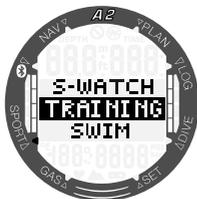
Auf der mittleren Zeile läuft die Zeit. Der Zähler kann gestoppt und neu gestartet werden, indem Sie die Taste +/UP drücken und halten. Die aktuelle Zeit wird oben auf dem Display angezeigt, der Stopp-Timer in der Mitte, die Temperatur unten links und der Puls unten rechts.
