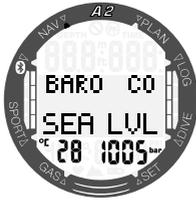
Durch Drücken der Tasten +/UP oder -/DOWN können Sie ein weiteres Display öffnen, auf dem der atmosphärische Druck auf Meereshöhe angezeigt wird.
