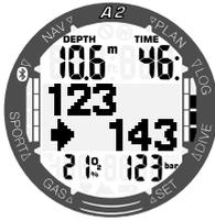
Bestätigen Sie den Tankwechsel durch Drücken der Taste SEL/ESC.
