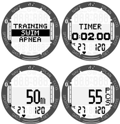
Bei aktiviertem Schwimmmodus wird die Dauer Ihres Schwimmtrainings auf dem zweiten Display angezeigt. Die Distanz wird auf dem dritten Display gezeigt, und das letzte Display zeigt die Anzahl der Schwimmzüge an. Die Wassertemperatur erscheint unten links auf dem Display. Wenn die Pulsmesserfunktion aktiviert ist, werden die Werte auf dem Display unten rechts angezeigt. Wechseln Sie zwischen
