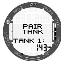
Wurde der Tank nicht verbunden zeigt der A2 anstelle des Druckwertes „nOP“. Wenn T1 mit dem A2 verbunden wurde, A2 jedoch kein Signal empfangen hat, wird anstelle des Druckwertes „- -“ angezeigt.
