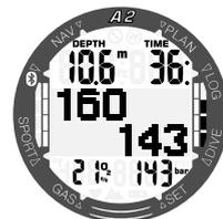
Wenn der ausgewählte Druckunterschied zwischen den Tanks (im Beispiel unten unter 20 bar) erreicht wird, schlägt der A2 vor, auf einen Tank mit einem höheren Druck zu wechseln.
