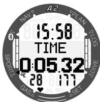
Die Informationen auf der mittleren Zeile können durch Drücken der Tasten +/UP oder -/DOWN durchgeblättert werden. Einmaliges Drücken der Taste +/UP wechselt die Daten der oberen Zeile in der folgenden Reihenfolge:
