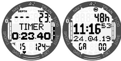
Während eines Tauchgangs im GAUGE-Modus zeigt der A2 die Tiefe und Tauchzeit in der obersten Zeile, einen Timer in der Mitte und die Wassertemperatur auf der untersten Zeile. Der Timer kann gestoppt und neu gestartet werden, indem Sie die Taste +/UP drücken und halten. Wenn der Timer gestoppt ist, kann er durch Drücken und Halten der Taste -/DOWN auf null zurückgesetzt werden. Die alternativen Displays in der Mitte können durch Drücken der Tasten +/UP oder -/DOWN durchgeblättert werden.
