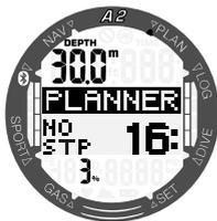
**HINWEIS:** Die Mindesttiefe für den Tauchplan beträgt 9 m. Der Tauchplan erlaubt nur Tiefen in Übereinstimmung mit dem maximalen  $ppO_2$ . Der Sauerstoffanteil und die Einstellungen des maximalen  $ppO_2$  befinden sich im Menü **GAS**.
