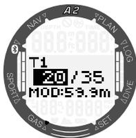
Durch Drücken der Taste SEL/ESC in diesem Display kann der Sauerstoffanteil des Diluent-Tanks von 21 % bis 40 % eingestellt werden:
