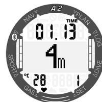
Die Displays zeigen während des Tauchgangs im Apnoe-Modus die Hauttemperatur, den Puls, die aktuelle Tauchzeit, die Tiefe, die Wassertemperatur und die Tauchgangnummer der Wiederholungstauchgänge der aktuellen Trainingseinheit an.
