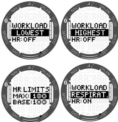
Sie können die Arbeitsleistung auch anhand der Atmung messen lassen, indem Sie „respiratory“ (respiratorisch) auswählen oder anhand von einer Kombination von Puls und Atmung; dabei werden beide Parameter gemessen und jeweils der höhere oder der tiefere Parameter vom Algorithmus wird verwendet.
