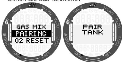
Nachdem der Smart-Sender unter Druck gesetzt wurde, sendet er eine Kopplungssequenz an den A2. Sobald der A2 diese Informationen empfängt, wechselt das Display und zeigt eine Liste von Tankbezeichnungen an (T1, T2, usw.).
