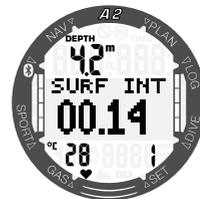
Durch Drücken der Tasten +/UP oder -/DOWN auf dem Display des Oberflächenintervalls werden die Hauttemperatur (37°C) und der Puls (115 bpm), die maximale Tiefe (4 m), die Dauer des letzten Tauchgangs (01:13 min) und die Gesamtdauer der aktuellen Apnoe-Trainingseinheit (00:04) angezeigt.
