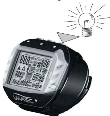
L'écran du TEC peut être éclairé en surface comme sous l'eau. Activez le rétro-éclairage en pressant le bouton
