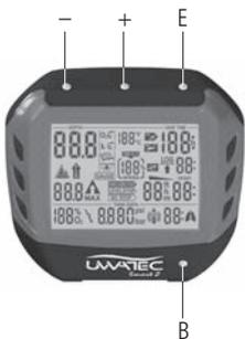
Le Smart Z possède 4 contacts sur le dessus du boîtier (B, E, +, -). Lors des manipulations, il faut mouiller deux doigts puis poser un doigt sur le contact B et l'autre sur l'un des trois autres contacts.
