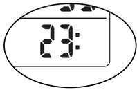
Le RBT indique, pour la profondeur réelle, la durée de plongée restante possible jusqu'au moment où il faudra entamer la remontée. Le RBT est calculé sur la base de la pression actuelle de la bouteille, du rythme respiratoire, et des informations de la plongée enregistrées jusqu'alors. Le RBT se base sur l'hypothèse qu'il doit rester au moins 40 bars de pression dans la bouteille à la fin de la plongée. Des modifications sont possibles avec SmartTRAK. Graphique représentant le RBT page 15.
