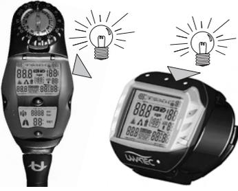
L'écran du Smart peut être éclairé en surface comme sous l'eau. Le rétro-éclairage est activé en appuyant au-dessus de l'écran du Smart PRO, et sur le côté de l'écran du Smart COM. Il s'éteint automatiquement au bout de 8 secondes, ou du temps choisi avec SmartTRAK. Le rétro-éclairage ne peut être allumé que si l'écran est actif.
