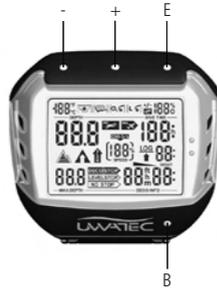
**Contact B:** Contact de base qui doit être actionné lors de chaque utilisation.
