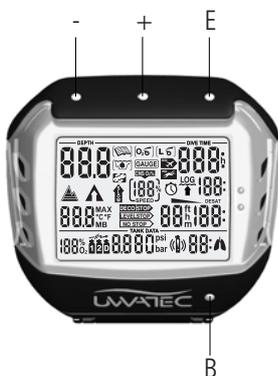
Le TEC possède 4 contacts sur le dessus du boîtier (B, E, +, -). Lors des manipulations, il faut mouiller deux doigts puis poser un doigt sur le contact B et l'autre sur l'un des trois autres contacts.
