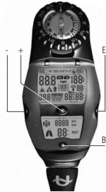
Le Smart possède 4 contacts sur le dessus du boîtier (B, E, +, -). Lors des manipulations, il faut mouiller deux doigts puis poser un doigt sur le contact B et l'autre sur l'un des trois autres contacts.
