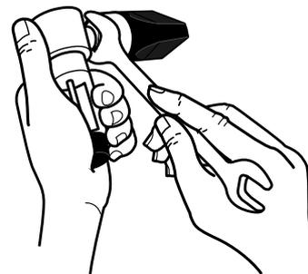
Sender mit einem 19-er Gabelschlüssel festziehen.
