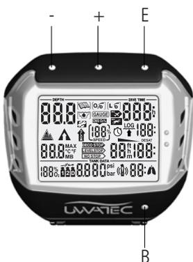
Der TEC verfügt über vier Kontaktstifte B, E, +, – auf der Gehäuseoberfläche. Für die manuelle Bedienung werden jeweils der Basiskontakt B und einer der drei Kontakte oberhalb der Anzeige mit angefeuchteten Fingern überbrückt.
