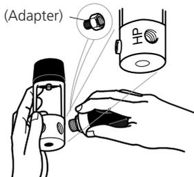
Sender am HP-Ausgang montieren. Wenn die Gewinde nicht übereinstimmen, erhalten Sie im Fachhandel einen passenden Adapter.
