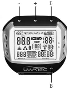
**Kontaktstift B:** Basis-Kontakt, der bei jeder Bedienung berührt werden muss.
