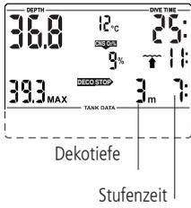
Beim Eintreten in die Dekompressionsphase erlischt der **NO STOP** Pfeil, der **DECOSTOP** feil erscheint und ein akustisches Vorsichtssignal ertönt. Unmittelbar neben dem Pfeil wird die tiefste Dekompressionsstufe in Metern angezeigt. Neben der Dekompressionsstufe erscheint die Dekompressionszeit auf der angegebenen Stufe in Minuten. Die Anzeige <3m 7:> bedeutet also, dass auf 3m Tiefe der erste Dekompressionsstopp von 7 Minuten eingelegt werden muss.
