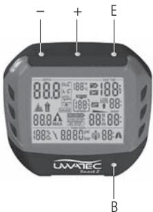
Der Smart Z verfügt über vier Kontaktstifte B, E, +, - auf der Gehäuseoberfläche. Für die manuelle Bedienung werden jeweils der Basiskontakt B und einer der drei Kontakte oberhalb der Anzeige mit angefeuchteten Fingern überbrückt.
