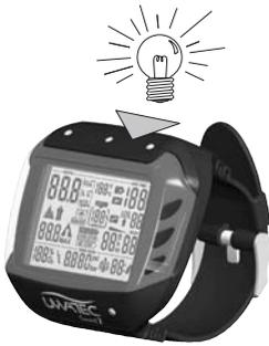
Die Anzeige des Smart Z kann bei Bedarf sowohl im Wasser als auch an der Oberfläche beleuchtet werden.
