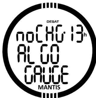
A mudança para MEDIDOR ou para o modo de APNEIA é possível após o tempo de dessaturação de o último mergulhoscuba com cilindro tenha decorrido.
