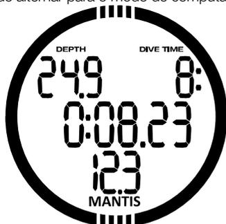
Durante um mergulho no modo MEDIDOR, o MANTIS exibe um cronômetro na linha do meio. O cronômetro pode ser parado pressionando - o botão. -/PARA BAIXO. Quando o cronômetro é parado, pode ser repostado e reiniciado pressionando e segurando o botão -/PARA BAIXO.
