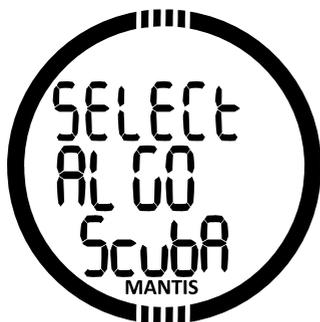
Os modos MEDIDOR e APNEIA não estão acompanhando a saturação do tecido e há um intervalo de bloqueio antes de uma mudança para o modo SCUBA ser possível. No modo MEDIDOR o intervalo de bloqueio é de 48h após o último mergulho no modo MEDIDOR. No modo de APNEIA há intervalo de 12h de bloqueio com mergulhos mais rasos do que 5m/16 pés e intervalo de 24 horas de bloqueio com mais profundos do que 5m/16 pés no modo APNEIA.
