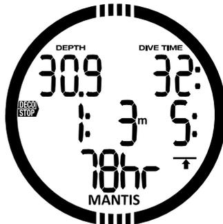
O MANTIS pode ativar um aviso quando a primeira parada de descompressão obrigatória aparecer. Isto alerta o mergulhador para o fato de que uma subida direta para a superfície já não é possível. Quando o tempo de no-stop terminar e uma parada obrigatória for necessária antes de chegar à superfície, o MANTIS emite uma sequência de apitos sonoros e o símbolo DECO STOP pisca, ambos por 12 segundos.
