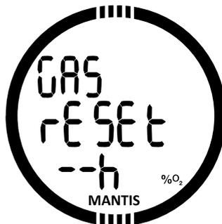
Se você geralmente mergulha com ar e quer voltar para essa configuração após o mergulho ocasional nitrox, você pode programar um tempo padrão quando seu MANTIS irá repor de volta ao ar.
