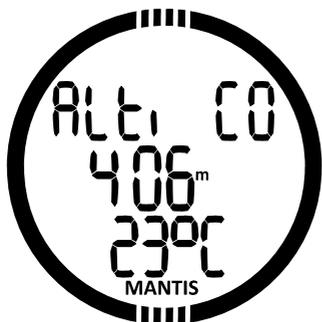
Ao pressionar e segurar o botão -/PARA BAIXO o visor muda e mostra na linha de baixo, a pressão barométrica ao nível do mar. Ou, pressione e segure o botão +/PARA CIMA e você obtém a pressão barométrica em mbar na altitude atual. Este recurso do Barômetro permite a você prever o tempo se aproximando nas próximas horas se a sua altitude permanece a mesma.
