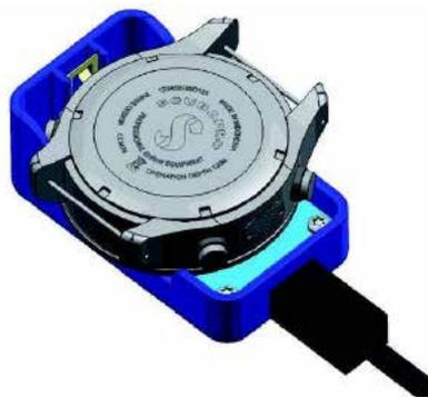
A comunicação entre o MANTIS e o suporte é estabelecida através do contato na caixa. Portanto, se o contato com a água ou o contato de mola do suporte tiver sujeira na superfície, esta deve ser limpa com um pedaço de tecido antes de usar. Para evitar arranhar seu MANTIS, primeiro junte os contatos e, em seguida, clique o MANTIS ao suporte.
