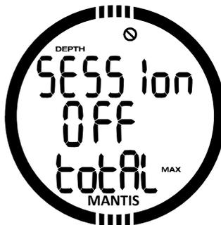
Para dar uma escala de mudanças de pressão total durante uma sessão de mergulho de apnéia, MANTIS inclui um contador de profundidade total. Quando a sua profundidade total for alcançada, o MANTIS notifica-o à superfície com um tom audível e um símbolo piscando "sem mergulho" para que você saiba que é para encerrar a sessão e fazer uma pausa.
