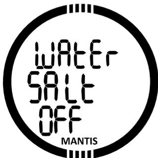
MANTIS determina a profundidade através da medição da pressão usando a densidade da água, como uma constante. A profundidade de 10m/33pés na água salgada corresponde aproximadamente à 10,3m/34pés em água doce.
