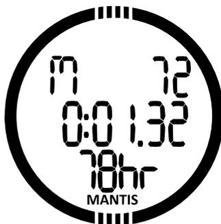
En el modo SWIM y durante el ejercicio en la superficie, MANTIS muestra el recuento de patadas o la frecuencia cardíaca en la fila inferior, el tiempo transcurrido en la fila central y la distancia total cubierta en la fila superior.
