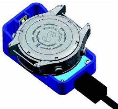
La comunicación entre MANTIS y la base se establece mediante contactos con la caja. Por tanto, si el contacto de agua o el contacto con resorte de la base están sucios en la superficie, debería limpiarlos con un paño antes del uso.
