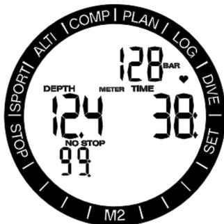
M2が負荷の大幅な増加を検知すると、無限圧潜水時間が急に短くなったり、減圧停止時間が短時間で増加します。M2は、ピープ音とハート記号の表示でこの状況を警告します。
