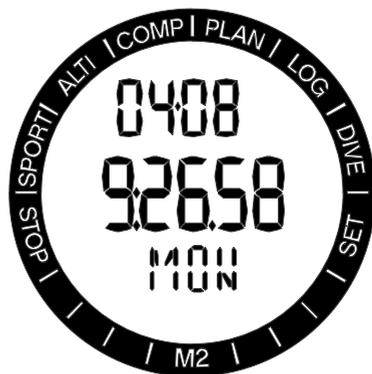
コンピューターのダイヤルリングに異なるモードが表示され、現在の機能モードは3つの矢印で示されます。各モードにはサブ機能とメニューがあります。SELボタンを押すとモードが起動し、矢印が点滅を始めます。
