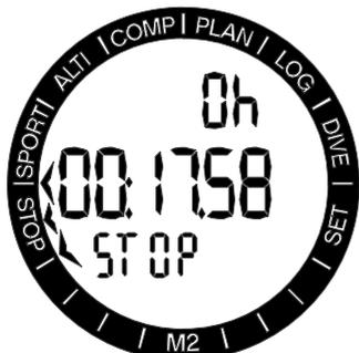
ストップウォッチが停止している状態で-/DOWNボタンを押すと、記録されたラップタイムを確認できます。
