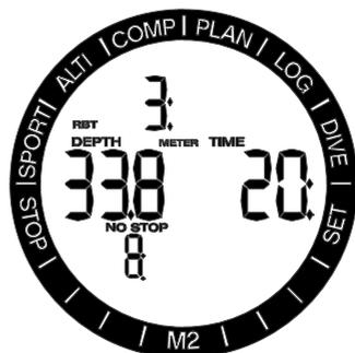
RBTが0分に達した場合、M2の計算によると、今すぐ浮上を開始して最適浮上速度を保つとタンク残量ぴったりで水面に到達することができますが、それより浮上が遅くなると、水面に到達する前にガス供給が枯渇するリスクが高まります。
