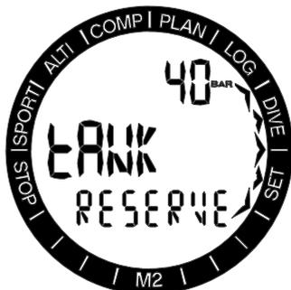
SELボタンを押すと、圧力値が点滅を始め、+/UPボタンまたは-/DOWNボタンを押すことにより、20~120barの間で5bar刻みで値を設定することができます(50psi刻みで299~1749psi)。SELボタンを押して、設定を確定します。
