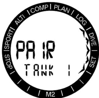
+UPボタンまたは-/DOWNボタンを使用して、トランスミッターに割り当てたいタンクを選び、SELを押します。ペアリングされたタンクの現在の圧力が、上の行に表示されます。
