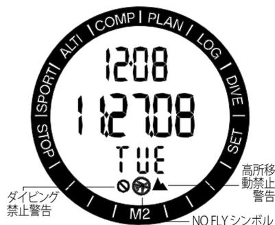
ダイビング禁止警告がコンピューター画面に表示されている場合は、ダイビングを行わないでください。（CNS O<sub>2</sub>が40%を超えたことではなく）マイクロバブルの蓄積によりこの警告が発生し、この警告を無視してダイビングを行うと、無減圧限界時間が短くなるか、減圧停止時間が長くなります。さらに、ダイビング終了時のマイクロバブル警告の発生時間が大幅に長くなります。
