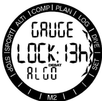
ゲージモードまたはアプネアモードへの変更は、前回のスクーバダイブが終了してから体内残留窒素排出時間が経過した後で可能になります。
