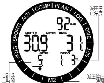
最初の減圧停止義務が発生したときに警告するようにM2を設定できます。この警告により、水面に直接浮上できなくなったことが通知されます。
