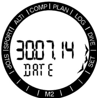
SELボタンを押すと、日付を示す先頭の2桁の数字が点滅を始めます。24hモードでは日付、12hモードでは月です。+/UPボタンまたは-/DOWNボタンを押して数字を変更できます。SELボタンを押すと、次の2桁の数字が点滅を開始し、+/UPボタンまたは-/DOWNボタンを押して変更できます。再びSELボタンを押すと、年が点滅を始めます。SELボタンを押すと、日付が確定します。
