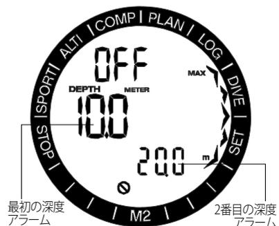
このメニューでSELボタンを押すと、on/off選択が点滅を始めます。+/UPボタンまたは-/DOWNボタンを押して、SELボタンを押して確定することにより、これを編集することができます。その後、最初の深度が点滅を開始します。+/UPボタンまたは-/DOWNボタンを押して、最初の深度アラームを5～100m(20～330フィート)の間で選択します。SELを押すと、最初の値が確定し、2番目の深度が点滅を始めます。最初のアラ
