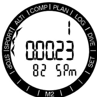
中央の行で、時間のカウントが行われます。このカウンターは、-/DOWNボタンを押して開始/再開することができます。上の行または下の行の情報は、+/UPボタンを押して選択することができます。+/UPボタンを押すと、上の行に表示される情報が以下の順序で変わります。
