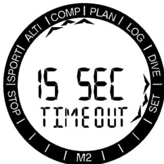
コンパスのタイムアウトとは、起動した後でコンパスがどれくらいの時間表示されるのかを示す時間です。コンパスタイムアウトは、ダイブ、スポーツなど、すべてのモードでのコンパス表示で有効です。タイムアウト設定は、SELボタンを押してから、+/UPまたは-/DOWNボタンを押して5、10、15、30、60秒の値またはPUSH (on/off) をスクロールします。SELボタンを押すと、値が確定します。
