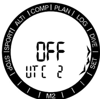
デュアルタイムはメインクロックと同じ「基準時間」を使用します。そのため、「3.1.3 時刻を設定する」のセクションに従って時間を変更すると、デュアルタイムも影響を受けます。デュアルタイムゾーン選択では、メインクロックの時間との差を定義します。タイムゾーン選択を「OFF」にすると、デュアルタイムは無効になります。
