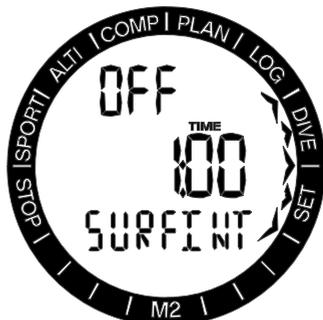
このメニューでSELボタンを押すと機能が点滅を始め、+/UPボタンまたは-/DOWNボタンで「on」か「off」を選択してアラームを有効化または無効化できます。SELボタンを押して選択を確定すると、水面休息時間が点滅を開始します。+/UPまたは-/DOWNを押して、間隔を15秒～10分の間で選択します。もう一度SELを押すと、選択が確定します。
