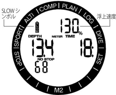
また、最適浮上速度の110%を超えると、アラーム音が鳴ります。アラーム音は、最適浮上速度からの超過率に比例して強くなります。
