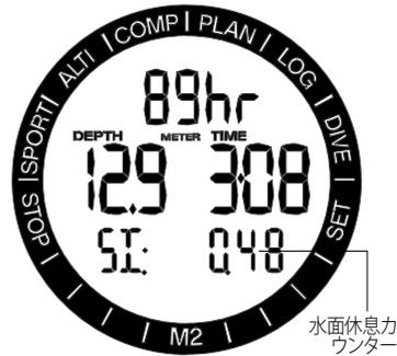
SIFを有効にした場合、陸上では、この時間が終了するまでダイビング禁止警告が表示されます。その後シグナル音が鳴ります。合計セッション深度を有効にしており、上限に達すると、ダイビング禁止警告が点滅表示され、シグナル音が鳴ります。
