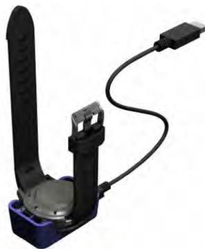
M2とクレードルとの通信は、ケースの接触部で行われます。そのため、クレードルの水検知接点またはスプリング接点の表面が汚れている場合は、使用前に布で拭いてください。
