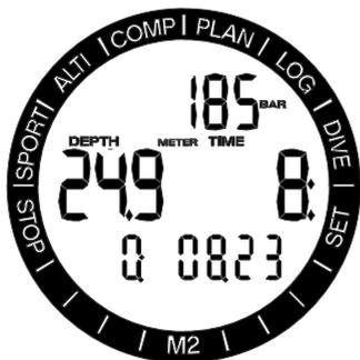
ゲージモードでのダイビング中は、下の行にストップウォッチが表示されます。-/DOWNボタンを押すとストップウォッチが停止します。ストップウォッチが停止した状態で-/DOWNボタンを押し続けると、ストップウォッチがリセットされ、再開します。ゲージモードでは、平均深度をリセットできます。平均深度をリセットするには、+/UPボタンを押し続けます。スクーバモードと同じく、+/UPボタンを押すと、上の行に時刻やその他の情報が表示されます。たとえば以下の図では、時刻を選択しています(14:52)。
