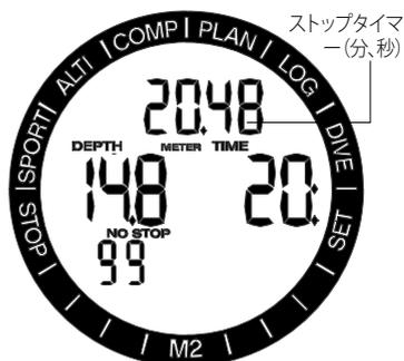
ストップタイマーは水に入れるとカウントが始まるため、ダイビング中にこの機能を初めて呼び出すと、ストップタイマーと潜水時間には同じ時間が表示されます。
