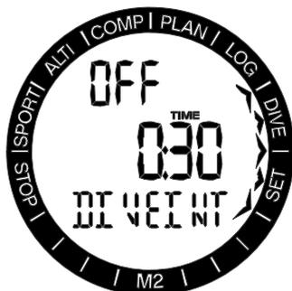
このメニューでSELボタンを押すとon/offが点滅を始め、+/UPボタンまたは-/DOWNボタンで「on」か「off」を選択して機能を有効化または無効化できます。SELボタンを押して選択を確定すると、時間が点滅を開始します。+/UPまたは-/DOWNを押して、間隔を15秒～10分の間で選択します。もう一度SELを押すと、選択が確定します。
