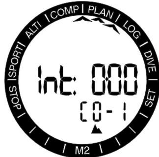
+ / UPボタンまたは - / DOWNボタンを押すと、15分刻みで時間が増減します。禁止高度は下の行に表示され、水面休憩時間を増やすと、許可される高度の制限値は最大限 (レベル4) になります。高地でのダイビングについては詳しくは、「4.10 高地でのダイビング」の章を参照してください。
