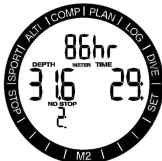
意図せぬ減圧ダイビングを避けるために、無減圧限界時間が2分に達したときに警告するようにM2を設定できます。これは、現在選択されているMBレベル無減圧限界時間に適用されます(MBレベルでのダイビングについては「4.8.2.6 MBレベルでのダイビング」のセクションを参照)。これにより、減圧停止やレベル停止の義務が発生する前に浮上を開始することが可能になります。M2はビープ音を12秒間発し、無減圧限界時間が点滅します。ダイバーが適切な深度まで浮上して無減圧限界時間が6分以上になるか、減圧停止を開始するまで、点滅は続きます。
