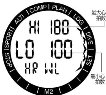
このメニューでSELを押すと最大心拍数 (HI) の値が点滅を始め、+/UPまたは-/DOWNを押して制限を140~220の間で選択できます。SELを押すと最小心拍数 (LO) が点滅を始め、+/UPまたは-/DOWNを押して制限を60~120の間で選択できます。通常のダイブ中の標準的な心拍数を示す基準心拍数を選択する必要があります。SELを押すと、値が確定します。
