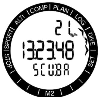
ただし、ダイビング後のスクーバモードでは、次のような画面が表示され、中央の行には残りの体内残留窒素排出時間が、下の行には反復潜水禁止時間と許可される高度クラスが表示されます。
