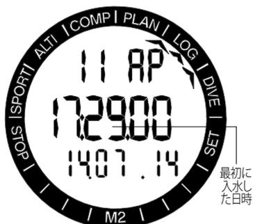
SELボタンを押すと、アプネアダイブセッションが開き、ダイブが順番に(1m以深のダイブを表示)、最大深度(13.4m)と時間(1分28秒)とともに表示されます。上の行には、セッションでのアプネアダイブ数が表示されます。
