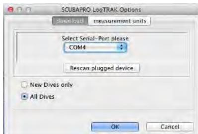
M2のクレードル用に使用するCOMポートを選択します。
