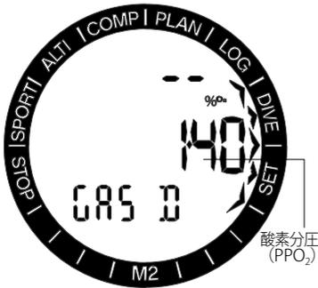
ガス2およびdでのダイビングおよび使用方法について詳しくは、「**4.9 2種類以上の混合ガスでダイビングする**」の章を参照してください。ガスdとガス2の設定方法は、ガス1の場合とほぼ同じです。ガス2は、ガスdが有効に設定されている場合にのみ設定できます。
