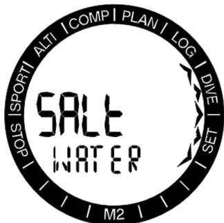
M2は圧力を測定し、水密度を定数として使用して深度を算出します。海水で深度10m(34フィート)の場合、淡水では深度約10.3m(34フィート)となります。
