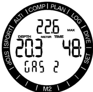
ガスを手で選択することにより、予定していた混合ガスにいつでも切り替えることができます。ガス切り替え手順を開始するには、SEL/ESCボタンを押し続けます。M2の画面に「Gas 2」または「Gas d」というテキストとMODが点滅します。これにより、安全なガスに切り替えていることを確認できます。次に、SEL/ESCボタンを押して、切り替えを確定します。「Gas d」というテキストが点滅なしで表示され、減圧スケジュールが調整されます。
