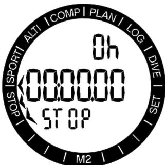
SELボタンを押すと、ストップウォッチが有効になります。ストップウォッチの最初の画面には、ステータス (STOP、RUN、LAP) が表示されます。初めてストップウォッチを起動すると、時間表示は上ようになります。
