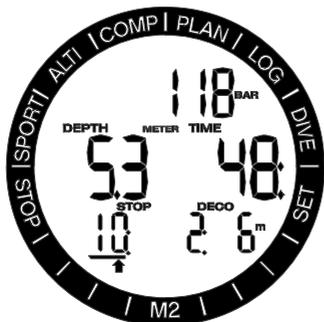
減圧停止が必要であるにも関わらず、指示された停止深度から0.5m (2フィート) 以上ダイバーが浮上すると、M2はアラームを発します。現在の深度と、指示された停止深度が点滅を始め、ピープ音が鳴り始めます。このアラームは、必要な停止深度から0.5m (2フィート) 以上の地点にいる限り続きます。
