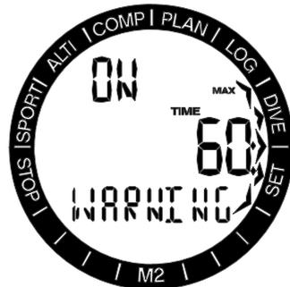
SELボタンを押すと機能が点滅を始め、+/UPボタンまたは-/DOWNボタンを押して「on」または「off」を選択できます。このメニューでSELボタンを押すと、時間の値が点滅を始めます。+/UPボタンまたは-/DOWNボタンを押すと、値を5～195分の間で5分刻みで選択できます。SELボタンを押して選択を確認します。
