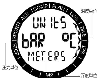
ユーザーは圧力、温度、深度の単位の組み合わせを選択できます。変更は、ダイブモード、ログブック、アラーム設定、高度設定などに反映されます。
