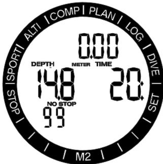
停止して画面に表示した状態で-/DOWNボタンを押し続けると、ストップタイマーはゼロにリセットされます。
