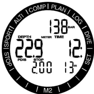
減圧停止が不要な場合、PDI STOPの深度まで浮上すると、PDISシンボルと深度が下の行で点滅を始め、2分間のカウントダウンが始まります。
