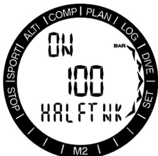
SELボタンを押すと、on/offのステータスが点滅を始めます。+/UPボタンを押してモードを選択できます。SELを押すと、圧力値が
