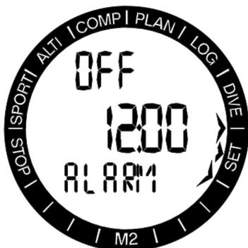
SELボタンを押すとアラームステータスが点滅を始め、+/UPボタンまたは-/DOWNボタンを押して「on」または「off」に変更できます。SELボタンを押すと、アラームの時間設定が点滅を始め、+/UPボタンまたは-/DOWNボタンを押して、時間設定をスクロールできます。SELボタンを押すと分が点滅を始め、+/UPボタンまたは-/DOWNボタンを押すとスクロールできます。左下長押し (SEL) を押すと、設定が確定します。
