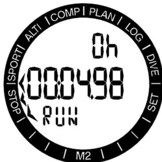
+UPボタンを押すと、ストップウォッチのカウントが始まり、実際の状態「RUN」が表示されます。+UPボタンをもう一度押すと、ストップウォッチのカウントが終わり、実際の状態「STOP」が表示されます。カウント時間は画面に表示されたままになります。
