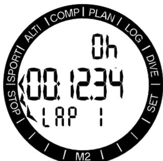
ストップウォッチのカウント中に-/DOWNボタンを押すと、ラップをマークできます。これにより、画面が5秒間フリーズされ、M2にラップ時間が表示されます。カウントは自動的に続行され、画面下部にはラップ数が表示されます。
