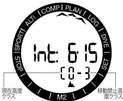
下の行の左側には現在の高度クラスが、右側には禁止高度が表示されます。上の例では、現在ダイバーは高度クラス0にいて、3時間15分が経過するまで、3000m以上の高度(クラス6)に移動してはいけません。中央の行で時間を増やすと、現在の高度クラスで時間が経過したことによって体内残留窒素が排出され、許可される高度が高くなります。
