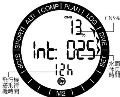
上の行には残りのCNS%が、下の行には飛行機搭乗待機時間が、この制限が解除されるまで表示されます。
