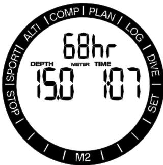
下の行では、水面休息時間カウンターが15分までカウントします。反復潜水を行わなければ、M2はアブネアメニュー表示に戻ります。
