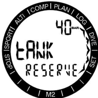
Premendo SEL, il valore della pressione comincia a lampeggiare ed è possibile impostarlo tra 20 e 120 bar con incrementi di 5 bar (299..1749 psi con incrementi di 50 psi) con una pressione breve dei pulsanti +/UP o -/DOWN. Premere nuovamente SEL per confermare le impostazioni.
