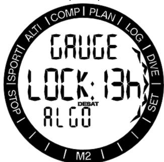
Il passaggio alla modalità Profondimetro (GAUGE) o APNEA è possibile dopo che il tempo di desaturazione dall'ultima immersione SCUBA è trascorso.
