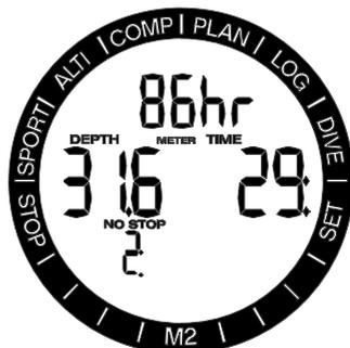
Se si desidera evitare di effettuare involontariamente un'immersione con decompressione, M2 può attivare un avviso quando il limite di non decompressione raggiunge i 2 minuti. Questo vale per le
