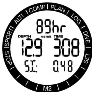
Quando il SIF è attivato, il simbolo "non immergersi" (no-dive) viene visualizzato in superficie finché quel periodo non è trascorso, dopodiché viene emesso un segnale acustico. Quando è attivata la profondità totale della sessione e il limite viene raggiunto, appare il simbolo "non immergersi" (no-dive) lampeggiante e viene emesso un segnale acustico.
