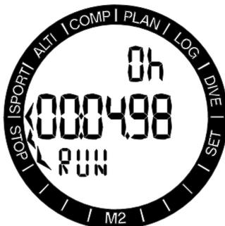
Premendo il pulsante +/UP, il cronometro inizia il conteggio mostrando lo stato attuale: in esecuzione (run). Premendo nuovamente il pulsante +/UP, il cronometro arresta il conteggio e indica lo stato attuale: stop. Il tempo trascorso rimane sul display. Il cronometro si azzerà quando si tiene premuto il pulsante +/UP.
