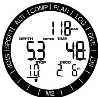
Se si risale 0,5 m/2 ft oltre una sosta di decompressione richiesta, M2 attiva un allarme: il valore della profondità attuale e quello della profondità della sosta lampeggiano e viene emessa una sequenza di bip sonori. L'allarme continua per tutto il tempo in cui si rimane a 0,5 m/2 ft o più al di sopra della sosta richiesta.
