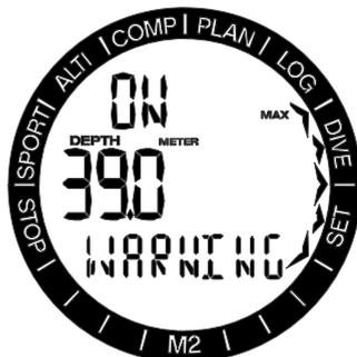
Premendo il pulsante SEL, la funzione comincia a lampeggiare e si può selezionare On oppure Off tramite il pulsante +/UP o -/DOWN. Premendo il pulsante SEL in questo menu, il valore della profondità comincia a lampeggiare. Premendo i pulsanti +/UP o -/DOWN, il valore può essere selezionato tra 5 e 100 m (20 e 30 ft) con un incremento di 1 m (5 ft). La selezione viene confermata premendo SEL.
