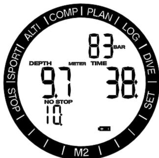
Durante l'immersione, M2 segnala la situazione precaria della batteria nei due modi illustrati di seguito.
