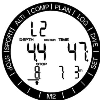
Quando si è impostato un livello MB superiore a L0 e si risale a più di 1,5 m sopra la sosta di livello MB richiesta oppure si rimane a una profondità inferiore dopo aver ignorato l'avvertenza di livello MB, M2 riduce il livello MB prescelto a quello più vicino possibile. L'allarme sonoro rimane attivo per 12 secondi e il nuovo livello MB lampeggia sulla riga superiore per 1 minuto.
