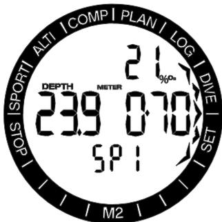
In tal modo, quando la modalità CCR è stata attivata, premendo il pulsante SEL in questa schermata il contenuto di ossigeno della bombola del diluente comincia a lampeggiare. Premendo i pulsanti +/UP o -/DOWN, è possibile scorrere i valori da 21% a 40%. Premendo il pulsante SEL, il contenuto è confermato e il valore di riferimento 1 (setpoint, SP1) della  $ppO_2$  comincia a
