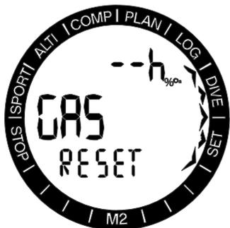
Se ci si immerge prevalentemente con aria e si desidera tornare a questa impostazione dopo un'immersione occasionale con nitrox, è possibile impostare un tempo predefinito trascorso il quale M2 ripristina l'aria.
