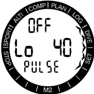
Premendo SEL in questo menu, la funzione del limite minimo di frequenza cardiaca comincia a lampeggiare e premendo +/UP o -/DOWN è possibile selezionare tra attivare o disattivare l'allarme con l'impostazione On/Off. Dopo aver confermato la selezione con il pulsante SEL, il valore basso di frequenza cardiaca comincia a lampeggiare. Premendo i pulsanti +/UP o -/DOWN, è possibile selezionare i valori da 25 a 100 bpm. Premendo il pulsante SEL, la selezione viene confermata.
