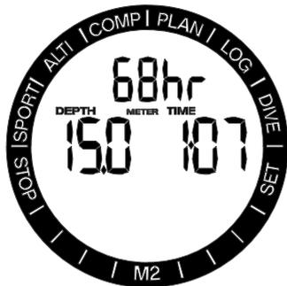
Sulla riga inferiore, il contatore dell'intervallo di superficie conteggia fino a 15 minuti. Se non viene eseguita alcuna immersione ripetitiva, M2 torna alla schermata del menu della modalità APNEA.
