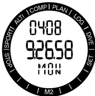
Le diverse modalità sono mostrate sul quadrante ad anello del computer e quella attualmente in funzione è indicata da tre frecce. Ciascuna di esse può avere sottofunzioni e menu. Premendo il pulsante SEL, si attiva la modalità e, per segnalarlo, le frecce cominciano a lampeggiare.
