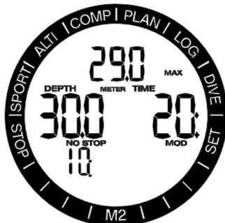
Se si supera la MOD, ne viene visualizzato il valore lampeggiante nella riga superiore con il simbolo MAX in modo da poter controllare di quanto è stata superata. Inoltre, M2 emette un bip sonoro continuo. Sia il lampeggiare del valore della MOD che il segnale sonoro proseguono per tutto il tempo in cui si rimane a una profondità superiore alla MOD.
