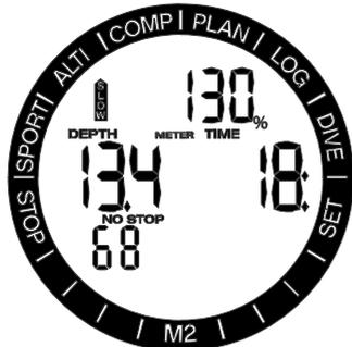
M2 attiva anche un allarme acustico in caso di velocità di risalita superiore al 110%: l'intensità dell'allarme aumenta in proporzione diretta al grado di superamento della velocità di risalita ideale.
