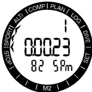
Sulla riga centrale compare il conteggio del tempo, che può essere arrestato e riavviato premendo il pulsante -/DOWN. Le informazioni sulla riga superiore o inferiore possono essere selezionate premendo il pulsante +/-UP. La pressione breve del pulsante +/-UP modifica le informazioni sulla riga superiore nell'ordine indicato di seguito:
