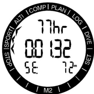
In modalità Nuoto (SWIM) e durante gli esercizi di superficie, M2 visualizza il conteggio delle pinneggiate o la frequenza cardiaca sulla riga superiore, il tempo trascorso su quella centrale e la distanza totale convertita su quella inferiore.
