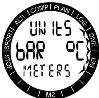
È possibile scegliere la combinazione di unità di misura (units) che verranno utilizzate per indicare profondità, temperatura e pressione. Questa scelta si riflette sulla modalità Immersione, sul logbook, sulle impostazioni di allarme, su quelle di altitudine, ecc.
