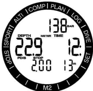
Se non è richiesta alcuna sosta di decompressione, quando si risale alla profondità di un PDI stop, il relativo simbolo e il valore della profondità lampeggiano sulla riga inferiore e inizia un conto alla rovescia di 2 minuti.
