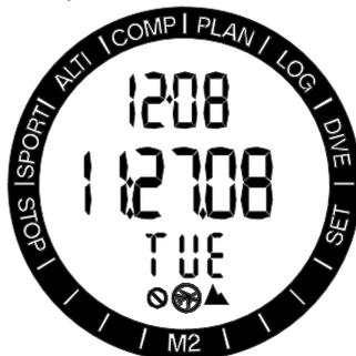
Non effettuare altre immersioni fino a quando l'avviso di non immergersi (no-dive) non scompare dallo schermo del computer. Se l'avvertenza è indotta da accumulo di microbolle (in contrapposizione a un valore di CNS O<sub>2</sub> oltre il 40%) e ci si immerge in ogni caso, si avranno limiti di non decompressione più brevi o tempi di decompressione più lunghi. Inoltre, la durata dell'avvertenza relativa alle microbolle alla fine dell'immersione può aumentare notevolmente.
