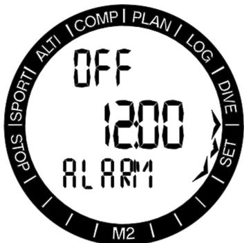
Premendo il pulsante SEL, lo stato dell'allarme comincia a lampeggiare e può essere alternato tra On e Off con i pulsanti +/UP o -/DOWN. Premendo il pulsante SEL, le cifre dell'ora dell'allarme cominciano a lampeggiare. Premendo i pulsanti +/UP o -/DOWN, è possibile scorrere l'impostazione delle ore. Premendo il pulsante SEL, cominciano a lampeggiare i minuti tra i quali è possibile scorrere tramite il pulsante +/UP o -/DOWN. Premere il pulsante SEL per confermare la selezione.
