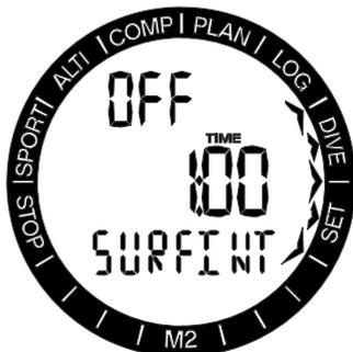
Premendo il pulsante SEL in questo menu, la funzione comincia a lampeggiare ed è possibile attivare o disattivare l'allarme selezionando On/Off tramite i pulsanti +/UP o -/DOWN. Dopo aver confermato la selezione con il pulsante SEL, il tempo di intervallo di superficie comincia a lampeggiare. Premendo +/UP o -/DOWN, è possibile selezionare un intervallo tra 15 secondi e 10 minuti. Premendo nuovamente il pulsante SEL, la selezione viene confermata.
