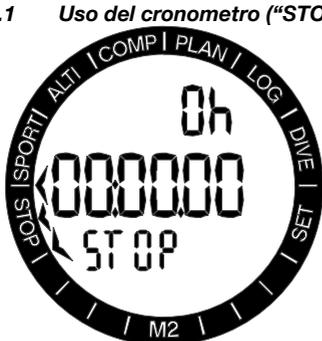
Premendo il pulsante SEL, si attiva il cronometro. Nella prima schermata del cronometro è mostrato lo stato con le alternative possibili: arresto (stop), in esecuzione (run) e tempo parziale (lap). Quando si attiva il cronometro per la prima volta, la schermata dell'ora appare come mostrato sopra.
