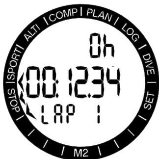
I tempi parziali possono essere rilevati premendo il pulsante -/DOWN durante il conteggio. In questo modo, il display si blocca per 5 secondi e M2 indicherà il tempo parziale. Il conteggio continuerà automaticamente e la funzione di tempo parziale mostrerà i relativi dati nella parte inferiore dello schermo.
