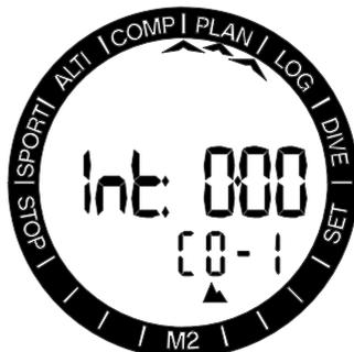
Premendo il pulsante +/UP o -/DOWN, il valore può essere impostato con incrementi di 15 minuti. La classe di altitudine proibita è indicata sulla riga inferiore e, aumentando l'intervallo di superficie, il limite consentito raggiunge il valore massimo (livello 4). Per saperne di più sulle immersioni in altitudine con M2, consultare la sezione **Immersioni in altitudine**.
