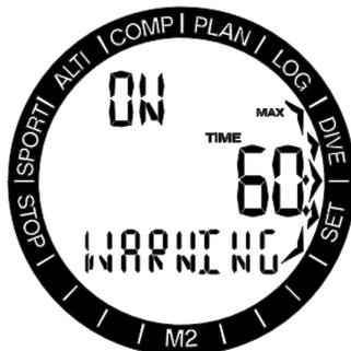
Premendo il pulsante SEL, la funzione comincia a lampeggiare e si può selezionare On oppure Off tramite il pulsante +/UP o -/DOWN. Premendo il pulsante SEL in questo menu, il valore del tempo comincia a lampeggiare. Premendo i pulsanti +/UP o -/DOWN, il valore può essere selezionato tra 5 e 195 minuti con incrementi di 5 minuti. La selezione viene confermata premendo SEL.
