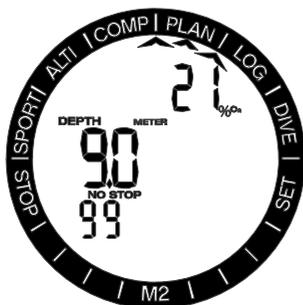
Una volta inserito l'intervallo di superficie, oppure se non è presente una desaturazione residua, il valore della profondità del pianificatore comincia a lampeggiare. Premendo i pulsanti +/UP o -/DOWN, è possibile impostare la profondità con incrementi di 3 m/10 ft. La profondità minima per la pianificazione è 9 m/30 ft.
