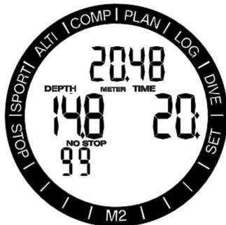
Durante un'immersione, il timer si avvia al momento in cui il subacqueo si immerge. Quindi, quando è visualizzato per la prima volta nel corso dell'immersione, mostra lo stesso valore del tempo di immersione.
