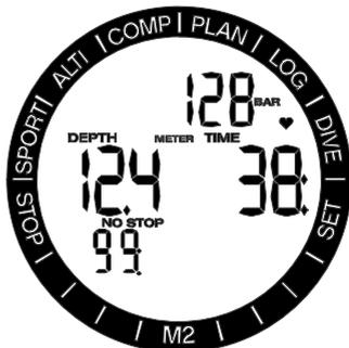
Se M2 rileva un sufficiente aumento del carico di lavoro, può ridurre i limiti di non decompressione e aumentare le soste di decompressione. M2 avverte di questa situazione con dei bip sonori e mostra il simbolo del cuore.
