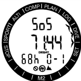
Il display mostra le stesse informazioni visualizzate in presenza di desaturazione, ma sulla riga superiore compare la dicitura SOS.
