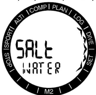
M2 determina la profondità misurando la pressione usando la densità dell'acqua come costante. La profondità di 10 m/33 ft in acqua salata corrisponde approssimativamente a 10,3 m/34 ft in acqua dolce.
