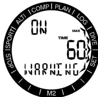
Durch Drücken des Knopfs SEL beginnt die Funktion zu blinken und Sie können über +/UP oder -/DOWN on oder off auswählen. Durch Drücken des Knopfs SEL in diesem Menü, beginnt der Zeitwert zu blinken. Durch Drücken des Knopfs +/UP oder -/DOWN kann der Wert in Schritten von 5 Minuten zwischen 5 und 195 Minuten eingestellt werden. Diese Auswahl wird über den Knopf SEL bestätigt.
