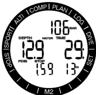
Nachdem die PDIS-Tiefe erreicht worden ist, sollten Sie in einem Bereich von +0,5 bis -3,0m/+2ft. bis -10ft. um die angezeigte PDIS-Tiefe verweilen. Wenn Sie unterhalb dieses Bereichs abtauchen, wird der PDIS-Zähler deaktiviert und M2 berechnet eine neue PDIS-Tiefe.
