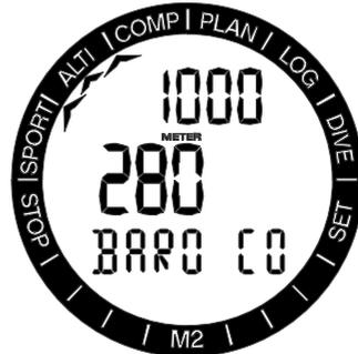
Durch Drücken und Halten des -/DOWN Knopfs wechselt das Display und zeigt nun den Barometerdruck auf Meereshöhe auf der oberen Zeile an. Oder bei einmaligem Drücken und Halten des +/UP Knopfs wird der Barometerdruck der aktuellen Höhe in mbar angezeigt. Mit dieser Barometerfunktion können Sie eine Wetterprognose für die kommenden Stunden erstellen, sofern Sie auf derselben Höhe bleiben.
