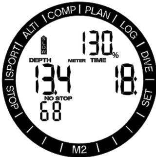
M2 bietet zudem einen akustischen Alarm, wenn die Aufstiegs geschwindigkeit 110 % übersteigt: Die Intensität des Alarms nimmt in direkter Proportion mit dem Überschreiten der Aufstiegs geschwindigkeit zu.
