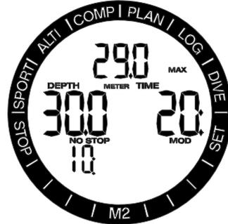
Wenn die MOD überschritten wird, blinkt in der oberen Zeile MOD und das Symbol MAX wird angezeigt, damit Sie sehen, um wie viel Sie sie überschritten haben. Zudem gibt der M2 einen konstanten Signalton aus. Solange Sie sich unterhalb der MOD befinden, blinkt der MOD-Wert und erklingt der Signalton unaufhörlich.
