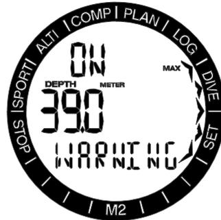
Durch Drücken des Knopfs SEL beginnt die Funktion zu blinken und Sie können über +/UP oder -/DOWN on oder off auswählen. Durch Drücken des Knopfs SEL in diesem Menü, beginnt der Tiefenwert zu blinken. Durch Drücken des Knopfs +/UP oder -/DOWN kann der Wert in Schritten von 1 m (5 ft.) zwischen 5 und 100 m (20 bis 330 Fuß) eingestellt werden. Diese Auswahl wird über den Knopf SEL bestätigt.
