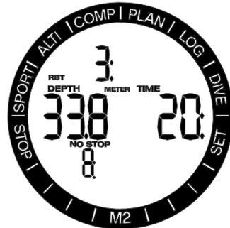
Wenn die RBT 0 Minuten erreicht, wird ein Alarm ausgelöst: Wenn Sie den Aufstieg nun einleiten und mit der idealen Aufstiegs geschwindigkeit aufsteigen, erreichen Sie laut Berechnungen des M2 die Oberfläche mit der Reserve im Tank. Durch sämtliche weiteren Verzögerungen steigt das Risiko, dass das Atemgas ausgeht, bevor Sie die Oberfläche erreicht haben.
