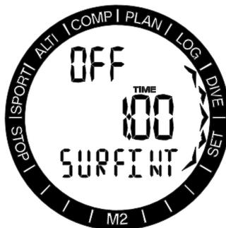
Durch Drücken des Knopfs SEL in diesem Menü beginnt die Funktion zu blinken und Sie können den Alarm aktivieren oder deaktivieren, indem Sie mit den Knöpfen +/UP oder -/DOWN „on“ oder „off“ wählen. Nach dem Bestätigen Ihrer Auswahl mit SEL, beginnt die Oberflächenintervall-Zeit zu blinken. Durch Drücken von +/UP oder -/DOWN können Sie ein Intervall von 15 Sekunden bis zu 10 Minuten einstellen. Durch Drücken des Knopfs SEL wird die Auswahl bestätigt.
