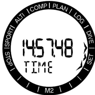
Im oben angezeigten Display wird die aktuelle Zeit auf dem Menü angezeigt. Durch Drücken des Knopfs SEL wird die Zeiteinstellung aktiviert: Stundenziffern blinken und die Sekundenziffern wechseln auf 00. Sie können die Stunden mit den Knöpfen +/UP oder -/DOWN bearbeiten. Durch Drücken des Knopfs SEL ändert sich die Auswahl auf Minuten und Sie können diese nun bearbeiten. Die neue Einstellung wird durch Drücken des Knopfs SEL bestätigt.
