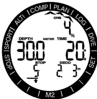
Durch Drücken von SEL für geplante Tiefen, erscheint die Tauchzeit auf der ersten Zeile. Der Startpunkt (jetzt Minimum) ist die Nullzeit. Durch Drücken der Knöpfe +/UP oder -/DOWN können Sie die Zeit in Schritten von 1 Minute verändern. Die Dekompressionszeit und die gesamte Auftauchzeit werden auf der unteren Zeile angezeigt.
