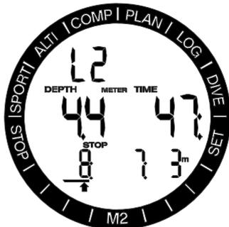
Wenn Sie einen höheren MB-Level als L0 eingestellt haben und Sie mehr als 1,5 m über den erforderlichen MB-Level-Stopp auftauchen oder Sie bleiben nach dem Ignorieren einer MB-Level-Warnung auf einer geringeren Tiefe, wird der M2 Ihr MB-Level auf das nächsttiefere Level senken. Der akustische Signalton wird während 12 Sekunden aktiviert und der neue MB-Level blinkt auf der oberen Zeile während 1 Minute.
