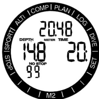
Während eines Tauchgangs beginnt der Stopp-Timer beim Eintauchen zu zählen. Wenn er während des Tauchgangs zum ersten Mal angezeigt wird, sind die Stoppzeit und die Tauchzeit identisch.
