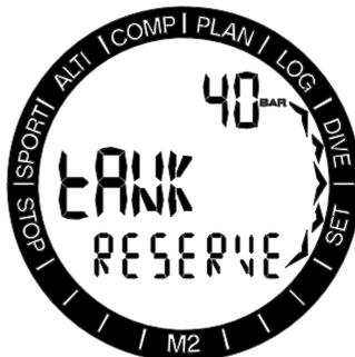
Durch Drücken von SEL beginnt der Druckwert zu blinken und Sie können einen Wert zwischen 20 bis 120 bar in Schritten von 5 bar (299 - 1749 psi in 50-psi-Schritten) über die Knöpfe +/UP oder -/DOWN eingeben. Durch Drücken von SEL werden die Einstellungen bestätigt.
