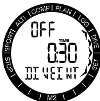
Durch Drücken des Knopfs SEL in diesem Menü beginnt die Funktion zu blinken und Sie können sie aktivieren oder deaktivieren, indem Sie mit den Knöpfen +/UP oder -/DOWN „on“ oder „off“ wählen. Nach dem Bestätigen Ihrer Auswahl mit SEL, beginnt die Zeit zu blinken. Durch Drücken von +/UP oder -/DOWN können Sie ein Intervall von 15 Sekunden bis zu 10 Minuten einstellen. Durch Drücken des Knopfs SEL wird die Auswahl bestätigt.
