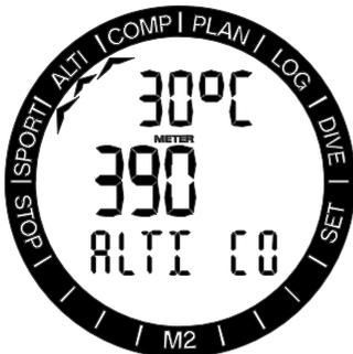
Im Höhenmenü wird die aktuelle Höhe anhand des Barometerdrucks errechnet und auf der mittleren Zeile angezeigt. Die aktuelle Temperatur wird auf der oberen Zeile dargestellt. Der aktuelle Höhenbereich wird auf der unteren Zeile dargestellt.
