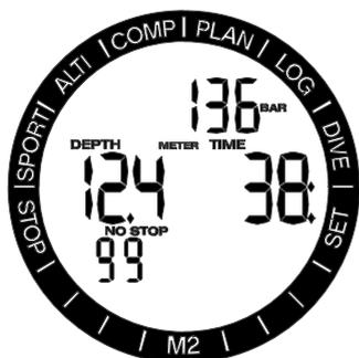
Zudem verwendet der M2 die obere Zeile zum Anzeigen von zusätzlichen Tauchdaten. Durch Drücken des Knopfs +/- UP wird folgende Sequenz angezeigt:
