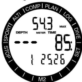
Nach einem Tauchgang zeigt die Oberflächenanzeige des GAUGE-Modus die Tauchzeit auf der mittleren Zeile an. In der unteren Zeile läuft die Stoppuhr ab Beginn des Tauchgangs oder ab letztem manuellen Neustart. Auf der oberen Zeile wird die maximale Tiefe angezeigt. Nach 5 Minuten wechselt das Display auf den GAUGE-Menümodus.
