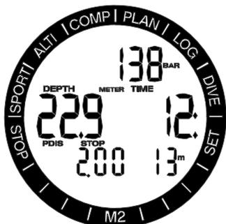
Wenn keine Dekompression erforderlich ist, wenn Sie zu einem PDI-Stopp auftauchen, blinken das PDIS-Symbol und die Tiefe auf der unteren Zeile und ein 2-Minuten-Countdown beginnt zu zählen.
