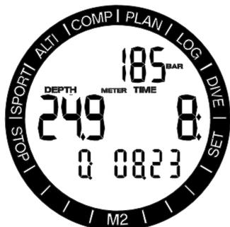
Während eines Tauchgangs im GAUGE-Modus zeigt M2 auf der mittleren Zeile eine Stoppuhr an. Die Stoppuhr kann durch Drücken des Knopfs -/DOWN erneut zurückgesetzt werden. Wenn die Stoppuhr gestoppt ist, kann Sie zurückgesetzt und neu gestartet werden, indem Sie den Knopf -/DOWN drücken und halten.
