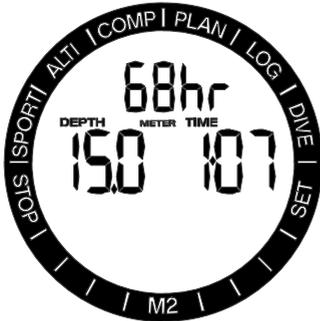
In der unteren Zeile zählt der Oberflächenintervallzähler bis 15 Minuten. Wenn kein Wiederholungstauchgang durchgeführt wird, zeigt der M2 wieder das APNÖE-Menü an.
