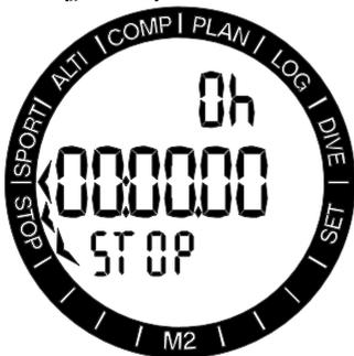
Durch Drücken des Knopfs SEL wird die Stoppuhr aktiviert: Im ersten Display wird der Status der Stoppuhr angezeigt, der die Stoppzeit, Laufzeit oder Intervallzeit sein kann. Wenn die Stoppuhr zum ersten Mal aktiviert wird, erscheint das Zeitdisplay wie oben dargestellt.
