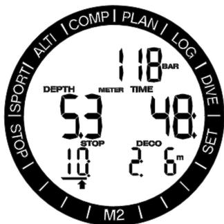
Wenn Sie bei einem Dekompressionsstopp mehr als 0,5 m /2 ft. über die erforderliche Stopptiefe auftauchen, löst M2 einen Alarm aus: Der Wert der aktuellen Tiefe und der Wert der erforderlichen Stopptiefe beginnen zu blinken und es wird eine Reihe von akustischen Signaltönen ausgegeben. Diese werden so lange fortgesetzt, wie Sie sich 0,5 m/2 ft. oder mehr über der erforderlichen Stopptiefe befinden.
