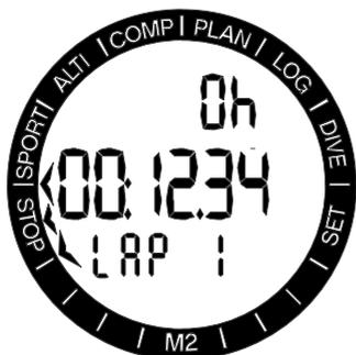
Die Intervallzeiten können durch Drücken von -/DOWN festgehalten werden, während die Stoppuhr läuft. Das Display bleibt während 5 Sekunden fix und M2 zeigt die Intervallzeit. Die Messung wird automatisch weitergeführt und der Intervallzähler zeigt den Wert des Intervalls unten auf dem Display an.
