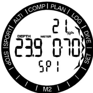
Nachdem CCR aktiviert worden ist, beginnt nach dem Drücken von SEL auf diesem Display der Sauerstoffgehalt des Verdünnungsgases zu blinken. Durch Drücken von +/UP oder -/DOWN können Sie von 21 bis 40% durch die Werte blättern.
