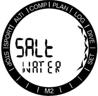
M2 ermittelt die Tiefe durch das Messen des Wasserdrucks, wobei er die Wasserdichte als Konstante berücksichtigt. 10 m/33 ft. Tiefe in Salzwasser entsprechen ungefähr 10,3/34 ft. in Süßwasser.
