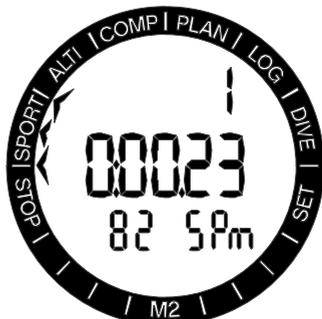
Auf der mittleren Zeile läuft die Zeit. Die Zeit kann durch Drücken des Knopfs -/DOWN erneut zurückgesetzt werden. Die Informationen in der oberen oder unteren Zeile können durch Drücken des Knopfs +/UP ausgewählt werden.
