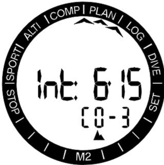
Der aktuelle Höhenbereich wird links auf der unteren Zeile und die verbotene Höhe rechts angezeigt. Im oben aufgezeigten Beispiel befindet sich der Taucher auf einem Höhenbereich 0 und darf den Höhenbereich über 3000 m (Bereich 3) während eines Zeitintervalls von 6 Stunden und 15 Minuten nicht erreichen.
