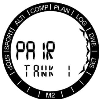
Verwenden Sie die Knöpfe +/UP oder -/DOWN, um den Tank auszuwählen, den Sie dem Sender zuordnen wollen und drücken Sie anschließend auf SEL. Der aktuelle Tankdruck des gepaarten Tanks wird auf der obersten Zeile angezeigt.
