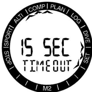
Kompass-Timeout ist die Zeit, während der der aktivierte Kompass angezeigt wird. Das Kompass-Timeout ist in allen Modi für das Kompass-Display gültig. Tauchen, Sport usw. Sie können das Timeout durch SEL und durchblättern der Wert mit den Knöpfen +/UP oder -/DOWN zwischen 5, 10, 15, 30 und 60 Sekunden einstellen oder mit PUSH ein- oder ausschalten. Durch Drücken des Knopfs SEL wird der Wert bestätigt.
