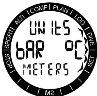
Sie können aus verschiedenen Kombinationen von Tiefen-, Temperatur- und Druckeinheiten auswählen. Das wirkt sich auf die Anzeige im Tauchmodus, im Logbuch, die Alarminstellungen, die Höheneinstellungen usw. aus.
