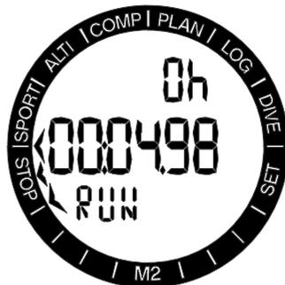
Durch Drücken des +/UP Knopfs startet die Stoppuhr und zeigt den aktuellen Status „run“ an. Durch erneutes Drücken des +/UP Knopfs stoppt die Stoppuhr und zeigt den aktuellen Status „stop“ an. Die gemessene Zeit bleibt auf der Anzeige. Die gemessene Zeit wird durch Drücken und Halten des Knopfs +/UP zurückgesetzt.
