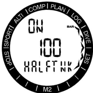
Durch Drücken von SEL beginnt die Auswahl on/off zu blinken. Wählen Sie den Modus über den Knopf +/UP aus. Durch Drücken von SEL beginnt der Druckwert zu blinken und Sie können einen Wert zwischen 50 bis 200 bar in Schritten von 5 bar (749 - 2999 psi in 50-psi-Schritten) über die Knöpfe +/UP oder -/DOWN eingeben. Durch Drücken von SEL werden die Einstellungen bestätigt.
