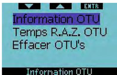
En appuyant sur haut ou bas, vous choisissez entre Informations OTU, temps de remise à zéro OTU et effacer OTU. En appuyant sur **entrée** lorsque vous êtes sur les informations OTU, vous allez au choix suivant.
