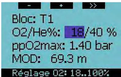
Lorsque le curseur surligne la partie O<sub>2</sub>, vous pouvez éditer le pourcentage en oxygène du mélange avec les boutons + et -. La gamme de réglages possibles pour le réglage de O<sub>2</sub> est affichée au bas de l'écran, avec un arrière-plan noir. En appuyant sur >>, vous sélectionnez la valeur actuelle et passez au pourcentage de l'hélium.
