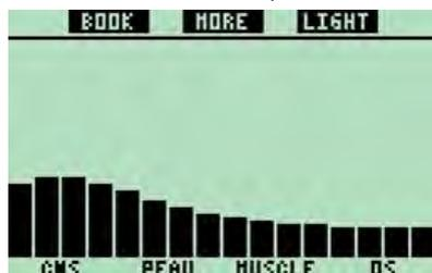
L'écran de saturation des tissus affiche 16 bars alors que le logiciel standard Galileo s'arrête à 8 bars.
