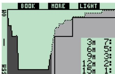
Lorsque la plongée indiquée commence la phase de remontée, la décompression augmente encore, comme on le constate sur le tableau d'informations à droite. Les compartiments rapides commencent à rejeter les gaz absorbés, et l'effet est montré sur le diagramme de la barre de saturation ci-dessous.
