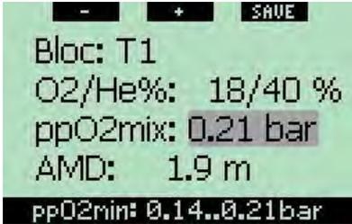
Lorsque la valeur de la  $ppO_2$  est surlignée, vous pouvez éditer la pression partielle d'oxygène minimale du mélange avec les boutons + et -. La gamme de réglages possibles pour le réglage de la  $ppO_2$  min est affichée au bas de l'écran, avec un arrière-plan noir. En appuyant sur >>, vous sélectionnez la valeur actuelle et enregistrez la modification pour cette bouteille.
