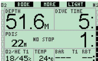
Sur l'affichage principal, le champ réservé au contenu en gaz est au format O<sub>2</sub>/He pour chacun des gaz lorsque Tec SW est activé.
