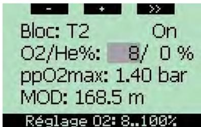
Avec les bouteilles 2..10, la fraction minimale d'oxygène est de 8 %.
