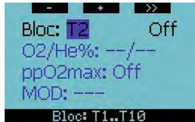
Lorsque le numéro de la bouteille est surligné (T2..T10), vous pouvez faire défiler les bouteilles avec les boutons + et -. Le bouton >> permet de choisir la bouteille à modifier.
