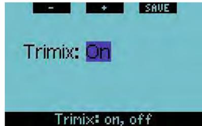
Avec les boutons + et -, vous pouvez faire alterner l’activation (on) et la désactivation (off). En choisissant « on », vous activez l’hélium dans les réglages de la bouteille, et vous l’autorisez à être utilisé dans les calculs.
