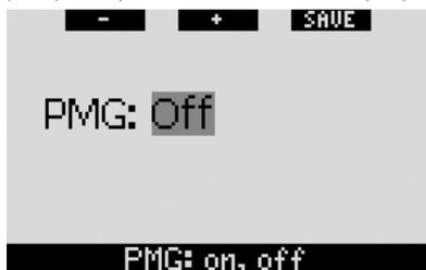
Quando **PMG** è su **OFF**, Galileo si comporta esattamente come un computer a una sola miscela. Quando **PMG** è su **ON**, Galileo cambia sotto molti aspetti:
