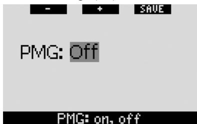
Cuando el **PMG** está en **OFF**, Galileo se comporta de la misma manera que la versión para un solo gas. Cuando el **PMG** está en **ON**, Galileo cambiará en varios aspectos:
