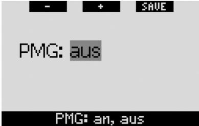
Wenn **PMG AUS** ist, funktioniert Galileo genauso wie die Einzelgas-Version. Wenn **PMGEIN** ist, ändert sich die Funktionsweise von Galileo in folgenden Aspekten:
