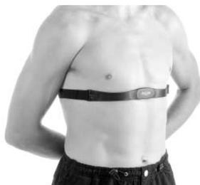
L'émetteur codé Polar T31 possède une pile dont la durée de vie est d'environ 2500 heures. L'émetteur est activé par le contact de l'humidité, par conséquent le laisser sur une serviette humide, par exemple, utilisera de l'énergie de la pile. Si vous pensez que la pile est épuisée, contactez un Centre d'entretien agréé Polar pour obtenir un émetteur de remplacement. Polar recycle les émetteurs usagés.
