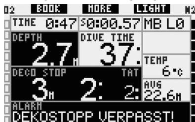
In der Konfiguration **FULL** wird die Alarmmeldung **DEKOSTOPP VERPASST!** während 12 Sekunden in der untersten Zeile und die Tiefe in umgekehrten Farben (weiß auf schwarzem Grund) solange angezeigt, wie sich der Taucher oberhalb der vorgeschriebenen Stoptiefe befindet. Das akustische Signal wird ausgegeben, bis der Taucher bis auf oder unter die vorgeschriebene Tiefe abtaucht.
