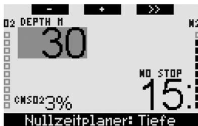
Sie können jederzeit auf >> **drücken**, um für die angezeigte Tiefe zum Dekompressionstauchgang-Planer zu wechseln. Galileo addiert zur Nullzeit eine Minute hinzu und zeigt die entsprechenden Dekompressionsverbindlichkeiten an.
