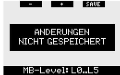
Wenn mehrere Einstellungen in einem Menü geändert werden können, wird der rechte Knopf mit **>>** bezeichnet, anstatt mit **SAVE**. Durch **Drücken** von **>>** wird das hervorgehobene Segment zum nächsten Element bewegt, das geändert werden kann. Wenn das hervorgehobene Segment das letzte veränderbare Element ist, wechselt die Bezeichnung des rechten Knopfs wieder auf **SAVE**. Für die Untermenüs gilt der gleiche Vorgang.
