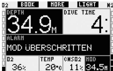
Bei der Konfiguration **LIGHT** wird für 12 Sekunden die Alarmmeldung **MOD ÜBERSCHRITTEN** angezeigt und anschließend in einem Intervall von 4 Sekunden wiederholt, anstatt der Nullzeitinformationen. Zudem wird die aktuelle Tiefe in umgekehrten Farben (weiß auf schwarzem Grund) solange angezeigt, bis der Taucher auf 1 m über die MOD aufsteigt. Das akustische Signal wird ausgegeben, bis der Taucher auf 1 m über die MOD aufsteigt.
