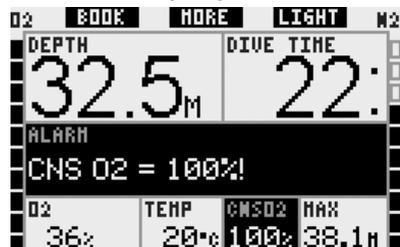
In der Konfiguration **LIGHT** wird die Alarmmeldung **CNS O<sub>2</sub> = 100%** für 12 Sekunden anstelle der Nullzeitinformationen angezeigt. Während dieser Zeit ertönt das akustische Signal. Zudem wird nach dem Erlöschen der Textmeldung der eingestellte Wert CNS O<sub>2</sub> in umgekehrten Farben (weiß auf schwarzem Grund) in der unteren linken Ecke angezeigt. Dies bleibt bestehen, solange
