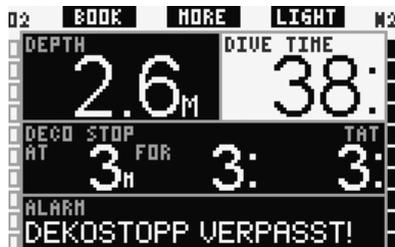
In der Konfiguration **LIGHT** wechselt das Display bei einem verpassten Dekostopp kurzfristig auf die Konfiguration **CLASSIC** und der Alarm wird wie oben beschrieben ausgegeben. Kehrt der Taucher auf die vorgeschriebene Tiefe zurück, wird wieder die Konfiguration **LIGHT** angezeigt.
