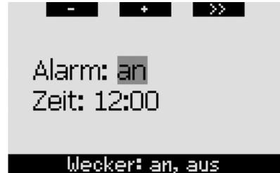
In diesem Menü können Sie einen Weckalarm einstellen. Die Zeit des Alarms wird in Format angezeigt, das im Menü **Zeit** festgelegt wurde (entweder in **12h** oder **24h**). Wenn der Alarm auf **EIN** eingestellt ist, wird ein Glockensymbol auf dem **Tageszeit**-Display angezeigt.
