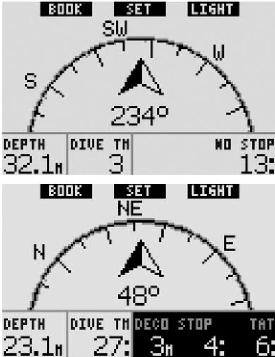
In diesem Layout unterscheiden sich die Knopffunktionen etwas. Der mittlere Knopf wird nun als **SET** gekennzeichnet. Durch **Drücken** dieses Knopfes wird die Peilung eingestellt. Die Kompasspeilung stellt die Richtung dar, in der die Vorderseite des Computers ausgerichtet ist. Sie wird in Grad von 0 bis 359 ausgedrückt, wobei 0 Grad Norden, 90 Grad Osten, 180 Grad Süden, 270 Grad Westen und alle dazwischen liegenden Richtungen die entsprechenden Zwischenwerte bedeuten.
