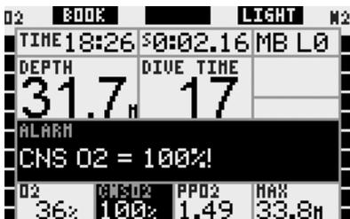
In allen Konfigurationen werden die Alarmmeldung und das akustische Signal während 5 Sekunden in Intervallen von einer Minute nach dem ersten Auftreten wiederholt, bis der CNS O<sub>2</sub>-Wert unter 100% fällt oder bis der ppO<sub>2</sub> unter 0,5 bar fällt (siehe Abschnitt 3.1 für eine Liste von Tiefen, bei denen ppO<sub>2</sub> für einige übliche Nitroxgemische 0,5 bar entspricht).
