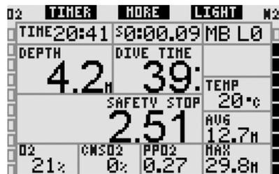
Im Kompassmodus arbeitet der Safety-Stop-Timer auf die gleiche Weise wie in den Konfigurationen **CLASSIC**, **LIGHT** und **FULL**. Wenn der Safety-Stop-Timer aktiv ist, wenn Sie von einer Konfiguration zur anderen wechseln, werden die Timer-Informationen einfach von den verschiedenen Displays übernommen.
