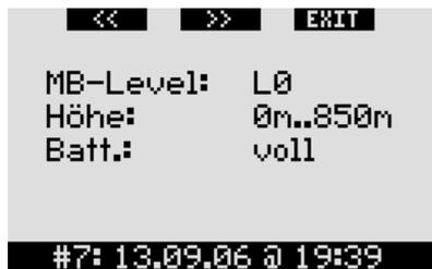
Die vierte Seite zeigt den MB-Level an, mit dem der Tauchgang begonnen wurde, ob eine MB-Level-Reduktion vorlag und den MB-Level am Ende an. Sie zeigt zudem den Höhenbereich und den tiefsten Batteriestand während des Tauchgangs.
