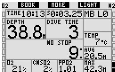
Galileo hat auch einen Gauge-Modus mit der entsprechenden Konfiguration **GAUGE**. Damit arbeitet der Computer als digitaler Tiefenmesser und führt keine Dekompressionsberechnungen durch.
