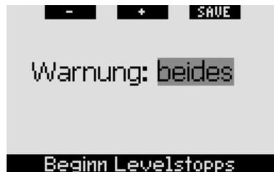
Wenn während eines Tauchgangs die Level-Stopp-Phase beginnt und die Warnung entweder auf **OPTISCH** oder **BEIDES** eingestellt ist, zeigt Galileo für 12 Sekunden die Meldung **BEGINN LEVELSTOPPS** auf dem Display an. Die folgenden Abbildungen zeigen das Display in den Konfigurationen **CLASSIC**, **LIGHT** und **FULL**.
