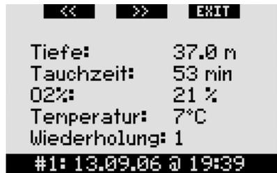
Die erste Seite enthält die Informationen über Tiefe, Zeit, Sauerstoffkonzentration, minimale Wassertemperatur und die Laufnummer des Tauchgangs dieses Tages. Durch **Drücken** von >> gelangen Sie auf die zweite Seite, durch **Drücken** von << auf die letzte (fünfte) Seite des Logbuchs.
