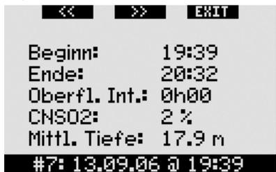
Die dritte Seite zeigt die Startzeit des Tauchgangs, die Endzeit des Tauchgangs, das Oberflächenintervall vor diesem Tauchgang, den CNS O<sub>2</sub>-Level am Ende des Tauchgangs und seine durchschnittliche Tiefe an.
