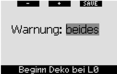
Wenn während eines Tauchgangs die Dekompressionsphase beginnt und die Warnung entweder auf **OPTISCH** oder **BEIDES** eingestellt ist, zeigt Galileo für 12 Sekunden die Meldung **BEGINN DER DEKO BEI L0** auf dem Display an. Die folgenden Abbildungen zeigen das Display in den Konfigurationen **CLASSIC**, **LIGHT** und **FULL**.
