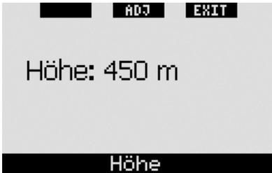
Für die Einstellung der Höhe **drücken** Sie zuerst auf **ADJ**, um das Menü **HÖHE EINSTELLEN** zu öffnen. Verwenden Sie in diesem Menü die Knöpfe **+** oder **-**, bis Sie den entsprechenden Wert eingestellt haben. Jedes Mal, wenn Sie **+** oder **- drücken**, wird die angezeigte Höhe um 10 m verändert. **Drücken** Sie auf **SAVE**, um Ihre Auswahl zu bestätigen und zum Menü **Höhenmesser** zurückzukehren.
