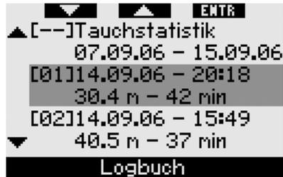
Nachdem Sie das **Logbuchmenü** geöffnet haben, wird eine Übersichtseite angezeigt, die jeden Tauchgang in einem zweizeiligen Format darstellt. Die zwei Zeilen enthalten:
