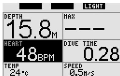
Galileo puede emitir una alarma si su frecuencia cardíaca\* desciende por debajo de un nivel definido. La alarma se puede configurar entre 35 y 100 bpm, con incrementos de 1 bpm. Si su frecuencia cardíaca\* desciende hasta el nivel definido para la alarma, se emitirá una secuencia sonora continua y la frecuencia cardíaca\* se mostrará con contraste de colores (blanco sobre fondo negro).
