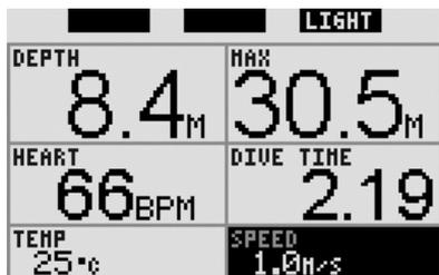
La velocidad de ascenso en el modo apnea se calcula como la media en un período de 4 segundos y se muestra en m/s. La alarma de velocidad de ascenso se puede configurar entre 0,1 y 5,0 m/s con incrementos de 0,1 m/s. Si, durante un ascenso, la velocidad es mayor que el valor definido, se emitirá una secuencia sonora continua y la velocidad se mostrará con contraste de colores (blanco sobre fondo negro).
