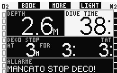
Nel formato **FULL**, il messaggio di allarme **MANCATO STOP DECO!** viene visualizzato per 12 secondi nella riga inferiore e la profondità viene visualizzata a colori invertiti (bianco su sfondo nero) fino a quando il sub permane al di sopra della profondità prescritta per la sosta. Il segnale sonoro persiste fino a quando il sub non scende alla profondità prescritta o oltre.
