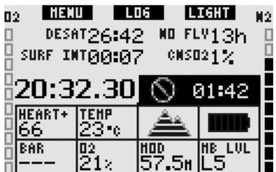
Non effettuare altre immersioni fino a quando l'avviso non immergersi non scompare dallo schermo del computer. Se l'avviso è stato attivato da un accumulo di microbolle (anziché da un livello della CNS O<sub>2</sub> superiore al 40%) e si decide di immergersi comunque, si avranno tempi di no-stop più brevi o tempi di decompressione più lunghi. Inoltre, la durata dell'avviso microbolle al termine dell'immersione potrà aumentare considerevolmente.
