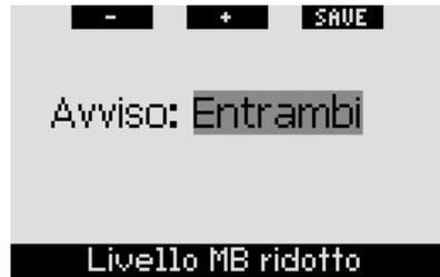
Se nel corso dell'immersione si supera di oltre 1,5m la profondità di uno stop MB suggerito e l'avviso è impostato su **VISIVO** o **ENTRAMBI**, Galileo visualizza per 12 secondi il messaggio **LIVELLO MB RIDOTTO**. Inoltre, a prescindere dall'impostazione dell'avviso, il nuovo livello MB viene visualizzato a colori invertiti (bianco su sfondo nero) come segue:
