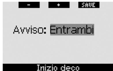
Nel corso dell'immersione, se ci si avvicina alla fase di decompressione e l'avviso è impostato su **VISIVO** o **ENTRAMBI**, Galileo visualizza per 12 secondi il messaggio **INIZIO DECO**. Le immagini seguenti mostrano la schermata visualizzata nei formati **CLASSIC** e **FULL**. Se è attivo il formato **LIGHT**, a questo punto dell'immersione Galileo passa automaticamente al formato **CLASSIC** per visualizzare tutti i dati.
