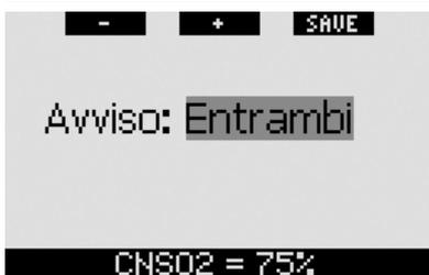
Se un avviso è impostato su **VISIVO** o **ENTRAMBI** e viene attivato mentre Galileo è in modalità bussola, il display torna automaticamente alla schermata standard (in formato **CLASSIC**, **LIGHT** o **FULL**) per visualizzare correttamente il messaggio dell'avviso.
