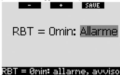
Per le immersioni con una sola miscela di gas, un RBT pari a 0 minuti attiva un allarme non disattivabile (descritto nella sezione 3.2.5): Galileo ha calcolato che iniziando subito la
