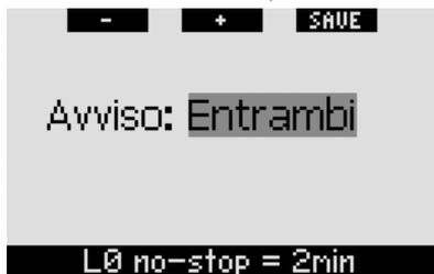
Se nel corso dell'immersione il tempo di no-stop L0 sottostante raggiunge i 2 minuti e l'avviso è impostato su **VISIVO** o **ENTRAMBI**, Galileo visualizza per 12 secondi il messaggio **L0 NO STOP = 2MIN**. Le immagini seguenti mostrano la schermata visualizzata nei formati **CLASSIC** e **FULL**.
