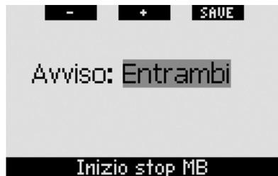
Durante l'immersione, quando ci si avvicina alla fase di stop MB, se l'avviso è impostato su **VISIVO** o **ENTRAMBI**, Galileo visualizza per 12 secondi il messaggio **INIZIO STOP MB**. Le immagini seguenti mostrano la schermata visualizzata nei formati **CLASSIC** e **FULL**. Se è attivo il formato **LIGHT**, a questo punto dell'immersione Galileo passa automaticamente al formato **CLASSIC** per visualizzare tutti i dati.
