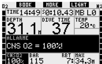
In tutti i formati di visualizzazione, il messaggio di allarme e il segnale sonoro vengono ripetuti per 5 secondi a intervalli di un minuto dopo la prima occorrenza e fino a quando la CNS O<sub>2</sub> non scende sotto il 100% oppure fino a quando la ppO<sub>2</sub> non scende sotto gli 0,5 bar (vedi sezione 3.1 per un elenco di profondità a cui la ppO<sub>2</sub> corrisponde a 0,5 bar per alcune miscele Nitrox tipiche).
