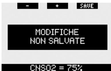
Quando è possibile modificare più di un elemento di un singolo menu, il pulsante destro assume la descrizione >> anziché **SAVE**. Se si preme >>, la barra di selezione si sposta sul successivo elemento modificabile. Quando la barra di selezione raggiunge l'ultimo elemento modificabile, il pulsante destro assume nuovamente la descrizione **SAVE**. Il processo non cambia in presenza di sottomenu.
