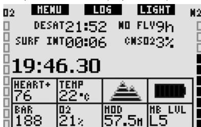
Il **tempo di desaturazione (DESAT) residuo** viene calcolato dal modello di decompressione del computer. Ogni immersione iniziata in presenza di desaturazione residua sul computer viene considerata un'immersione ripetitiva, pertanto Galileo tiene conto del carico di azoto già presente nell'organismo del sub.
