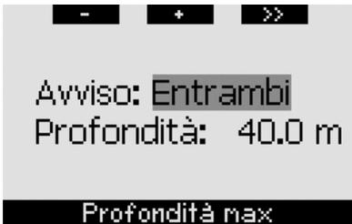
Durante l'immersione, se si scende oltre la profondità impostata e l'avviso è impostato su **VISIVO** o **ENTRAMBI**, Galileo visualizza per 12 secondi il messaggio **PROF. MAX RAGGIUNTA** invece dei dati di no-stop o decompressione.
