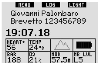
Se il computer presenta desaturazione residua da un'immersione recente, nella parte superiore dello schermo vengono invece visualizzate le informazioni seguenti: tempo di desaturazione, tempo di non volo, intervallo di superficie e CNS O<sub>2</sub> (se pertinente).
