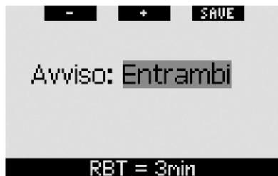
Se nel corso dell'immersione l'RBT scende a 3 minuti e l'avviso è impostato su **VISIVO** o **ENTRAMBI**, Galileo visualizza per 12 secondi il messaggio **RBT = 3 MINUTI**. Inoltre, a prescindere dall'impostazione scelta, il valore dell'RBT viene visualizzato a colori invertiti (bianco su sfondo nero). Le immagini seguenti mostrano la schermata visualizzata nei diversi formati (**CLASSIC**, **LIGHT** e **FULL**).
