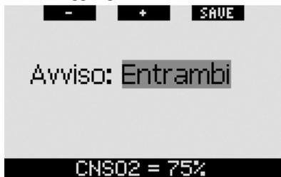
Durante l'immersione, se il valore della CNS O<sub>2</sub> calcolato raggiunge il 75% e l'avviso è impostato su **VISIVO** o **ENTRAMBI**, Galileo visualizza per 12 secondi il messaggio **CNS O<sub>2</sub> = 75%** invece dei dati di no-stop o decompressione.
