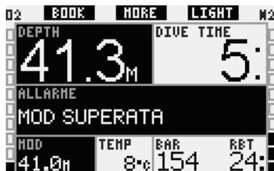
Nel formato **LIGHT**, il messaggio di allarme **MOD SUPERATA** viene visualizzato per 12 secondi al posto dei dati di no-stop. Inoltre, la profondità attuale viene visualizzata a colori invertiti (bianco su sfondo nero) e resta visualizzata fino a quando il subacqueo non risale superando la MOD di almeno 1 metro. Anche il segnale sonoro persiste fino a quando il subacqueo non risale superando la MOD di almeno 1 metro.
