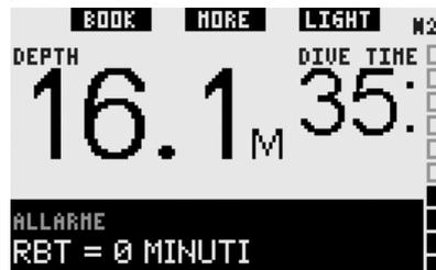
Nel formato **FULL**, il messaggio di allarme **RBT = 0 MINUTI** viene visualizzato per 12 secondi al posto
