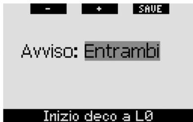
Se nel corso dell'immersione il sub si avvicina alla fase di decompressione e l'avviso è impostato su **VISIVO** o **ENTRAMBI**, Galileo visualizza per 12 secondi il messaggio **INIZIO DECO A L0**. Le immagini seguenti mostrano la schermata visualizzata nei formati **CLASSIC** e **FULL**.
