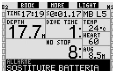
Oltre a monitorare le condizioni della propria batteria, Galileo può controllare anche la batteria delle sonde **T1**, **T2** e **TD** e avvisare il sub se una batteria è scarica e necessita la sostituzione. Sulla riga centrale del display, a intervalli di 4 secondi, appare il messaggio **BATT. T1** (o **T2** o **TD**) **SCARICA**. Nel formato **LIGHT**, il display passa al formato **CLASSIC** per consentire la visualizzazione di tutte le informazioni rilevanti.
