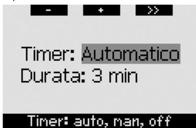
Se durante il processo di modifica di un'impostazione, il computer non riceve alcun input per 3 minuti, torna automaticamente alla schermata dell'**ora** senza salvare alcuna modifica.
