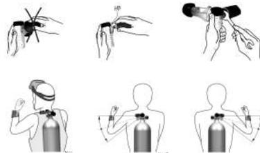
De manière à ce que Galileo affiche le signal de pression provenant d'un émetteur Smart, il faut d'abord établir une communication codée sans interférences. Cette étape ne doit être effectuée qu'une fois pour chaque émetteur, ou lorsque la pile de l'émetteur est remplacée.
