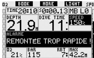
Galileo déclenche aussi une alarme sonore dans le cas de vitesses de remontée excédant les 110 % : l'intensité de l'alarme augmente en fonction directe du niveau de dépassement de la vitesse idéale de remontée.
