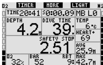
En mode compas, le compteur palier (compte à rebours de palier de sécurité) fonctionne de la même manière que dans les configurations **CLASSIC**, **LIGHT** et **FULL**. Si le compte à rebours de palier de sécurité est actif lorsque vous passez d'une configuration à l'autre, les informations de compte à rebours passeront sans problèmes d'un affichage à l'autre.
