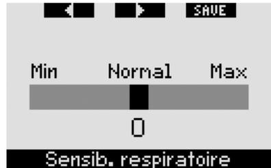
La sensibilité du calcul de l'effort aux modifications dans le schéma respiratoire peut être ajustée suivant 25 paliers : cela a un effet sur la manière dont l'algorithme prend en compte les modifications du schéma respiratoire dans le calcul de la décompression (cela n'a aucun effet si le réglage de l'**EFFORT** à la section 2.9.5 est sur **CARDIO-FRÉQ** ou sur **OFF**).
