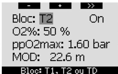
Lorsque **BLOC** est surligné, utilisez les boutons - et + pour choisir la bouteille pour laquelle vous voulez régler la concentration en oxygène. **Appuyez sur >>** pour surligner **ON** ou **OFF**, et utilisez les boutons - et + pour passer de l'un à l'autre. **Appuyez sur**
