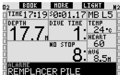
En plus de surveiller l'état de sa propre pile, Galileo surveille aussi l'état des piles des émetteurs **T1**, **T2** et **TD** et vous alerte lorsqu'une pile est faible et doit être remplacée. Le message **T1** (ou **T2** ou **TD**) **PILE FAIBLE** est affiché sur la rangée du milieu de l'écran, par intervalles de 4 secondes. En configuration d'écran **LIGHT**, l'affichage passe en mode **CLASSIC** pour permettre aux informations nécessaires d'être affichées.
