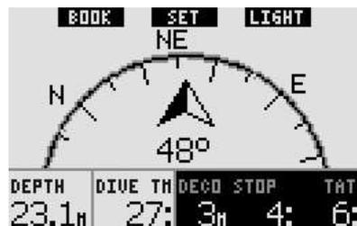
Dans cette disposition, les fonctions des boutons changent légèrement. Le bouton du milieu est maintenant indiqué **SET**. En **appuyant** sur ce bouton vous ferez une prise de cap. Le cap pris par le compas représente la direction vers laquelle pointe l'avant de l'ordinateur. Il est exprimé en
