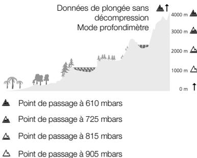
Galileo prend cette altitude en compte automatiquement : il surveille la pression atmosphérique toutes les 60 secondes, même lorsqu'il est éteint, et s'il détecte une baisse de pression suffisante, il effectue les opérations suivantes :
