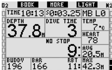
Galileo a aussi un mode profondimètre, avec la configuration **PROFONDIMÈTRE** correspondante, dans ce cas l'ordinateur fonctionne comme un profondimètre numérique et n'effectue aucun calcul de décompression.
