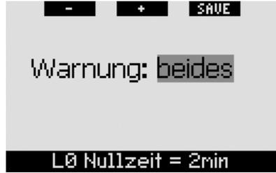
Wenn die Dekozeit während eines Tauchgangs 2 Minuten erreicht und die Warnung entweder auf **OPTISCH** oder **BEIDES** eingestellt ist, zeigt Galileo für 12 Sekunden die Meldung **L0 NULLZEIT = 2 MIN** auf dem Display an. Die folgenden Abbildungen zeigen das Display in den Tauchkonfigurationen **CLASSIC** und **FULL**.
