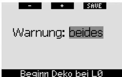
Wenn während eines Tauchgangs die Dekompressionsphase beginnt und die Warnung entweder auf **OPTISCH** oder **BEIDES** eingestellt ist, zeigt Galileo für 12 Sekunden die Meldung **BEGINN DEKO BEI L0** auf dem Display an. Die folgenden Abbildungen zeigen das Display in den Tauchkonfigurationen **CLASSIC** und **FULL**.
