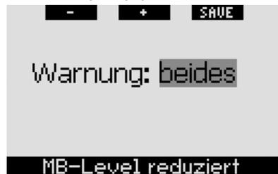
Steigen Sie während eines Tauchgangs über 1,5 m/5 ft über die vorgeschriebene MB-Stoptiefe und die Warnung ist entweder
