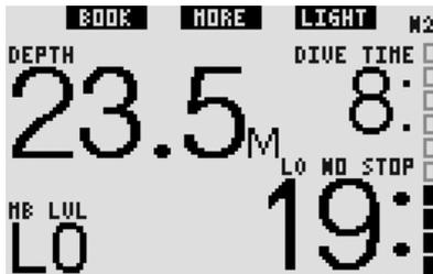
Bei der Konfiguration **FULL** wird die zugrunde liegende L0-Informationen in der Reihenfolge direkt nach dem **PARTNER** Flaschedruck und vor dem CNS O<sub>2</sub>-Wert angezeigt. Dies wird anstelle der MB-Level-Nullzeit oder Dekompressionsinformationen angezeigt und nach 5 Sekunden wieder von den Informationen zum aktiven MB-Level ersetzt.
