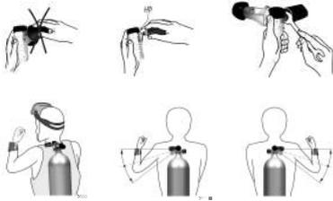
Damit Galileo die Druckinformationen vom Smart-Sender anzeigen kann, muss zuerst eine codierte, interferenzfreie Kommunikationsverbindung hergestellt werden. Dieser Vorgang muss für jeden Sender nur einmal ausgeführt werden oder nachdem die Batterie des Senders ersetzt wurde.
