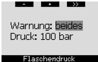
Wenn während des Tauchgangs der im Menü eingestellte Wert erreicht wird und die Warnung entweder auf **OPTISCH** oder **BEIDES** eingestellt ist, zeigt Galileo die Meldung „Wert“ BAR (oder PSI) **ERREICHT** für 12 Sekunden auf dem Display an. Die folgenden Abbildungen zeigen das Display in den verschiedenen Tauchkonfigurationen (**CLASSIC**, **LIGHT** und **FULL**).
