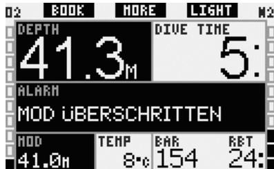
Bei der Konfiguration **LIGHT** wird für 12 Sekunden die Alarmmeldung **MOD ÜBERSCHRITTEN** angezeigt, anstatt der Nullzeitinformationen. Zudem wird die aktuelle Tiefe in umgekehrten Farben (weiß auf schwarzem Grund) solange angezeigt, bis der Taucher auf 1 m/3 ft über die MOD aufsteigt. Das akustische Signal wird ausgegeben, bis der Taucher auf 1 m/3 ft über die MOD aufsteigt.
