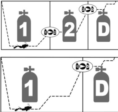
Galileo kann den Flaschendruck jedes Tanks anzeigen, wenn die entsprechende 1. Stufe mit einem UWATEC Smart-Sender versehen ist und beide wie im Abschnitt 1.11 beschrieben gepaart wurden. Beachten Sie, dass Galileo sowohl mit als auch ohne Sender für das Tauchen mit mehr als einem Gasgemisch programmiert und genutzt werden kann.
