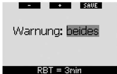
Wenn die RBT während eines Tauchgangs 3 Minuten erreicht und die Warnung entweder auf **OPTISCH** oder **BEIDES** eingestellt ist, zeigt Galileo für 12 Sekunden die Meldung **RBT = 3 Minuten** auf dem Display an.
