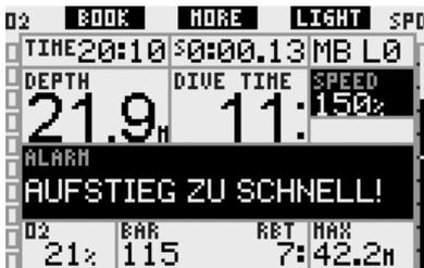
Galileo bietet zudem einen akustischen Alarm, wenn die Aufstiegs geschwindigkeit 110% übersteigt. Die Intensität des Alarms nimmt in direkter Proportion mit dem Überschreiten der Aufstiegs geschwindigkeit zu.
