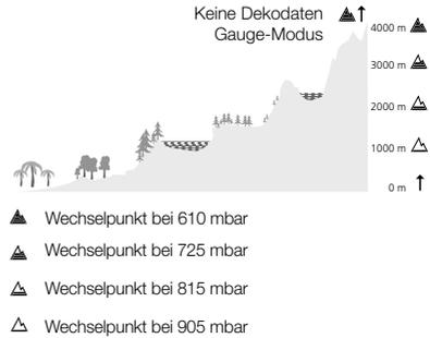
Galileo berücksichtigt die Höhe automatisch: Er überwacht den atmosphärischen Druck alle 60 Sekunden, auch wenn er ausgeschaltet ist. Erkennt er einen genügend hohen Druckabfall, geschieht Folgendes:
