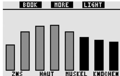
Wenn Sie Bilder in Galileo hochgeladen haben, können Sie diese durch **Drücken** von **MORE** ansehen, während die einzelnen Kompartimentsättigungen angezeigt werden. Jedes Mal wenn Sie **MORE drücken**, während ein Bild angezeigt wird, wird das nachfolgende Bild aus dem Speicher von Galileo abgerufen. Jedes Bild wird nur für zwölf Sekunden am Bildschirm angezeigt. Sie können jederzeit auf den Tauchcomputer-Bildschirm zurückkehren, indem Sie den rechten Knopf **drücken und halten**.
