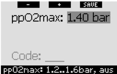
Schalten Sie den Wert ppO<sub>2</sub>max. auf **AUS**, erhalten Sie keine MOD-Warnungen. Wählen Sie **AUS**, müssen Sie eine zusätzliche Bestätigung in Form eines Sicherheitscodes eingeben. Der Sicherheitscode lautet **313**. Dadurch wird ein unbeabsichtigtes Ausschalten des Werts ppO<sub>2</sub>max. auf **AUS** verhindert. Um den Code einzugeben, verwenden Sie die Knöpfe + und -, um das erste Zeichen einzugeben (**3**). **Drücken** Sie anschließend auf **>>**, um es zu bestätigen.
