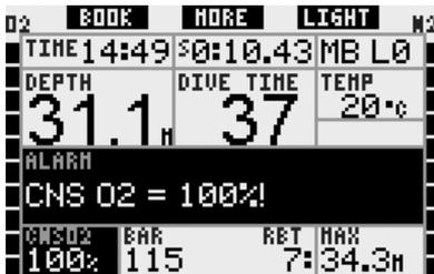
In allen Konfigurationen werden die Alarmmeldung und das akustische Signal während 5 Sekunden in Intervallen von einer Minute nach dem ersten Auftreten wiederholt, bis der CNS O<sub>2</sub>-Wert bei oder über 100% beträgt oder bis der ppO<sub>2</sub> unter 0,5 bar fällt (siehe Abschnitt 3.1 für eine Liste von Tiefen, bei denen ppO<sub>2</sub> 0,5 bar für einige übliche Nitroxgemischen entspricht).
