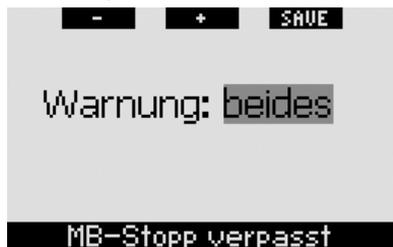
Wenn die vorgegebene Tiefe eines MB-Stops beim Aufstieg während eines Tauchgangs unterschritten wird und die Warnung entweder auf **OPTISCH** oder **BEIDES** eingestellt ist, zeigt Galileo die Meldung **MB-STOP IGNORIERT** während
