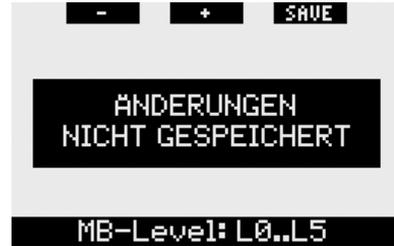
Wenn mehrere Einstellungen in einem gleichen Menü geändert werden können, wird der rechte Knopf mit **>>** bezeichnet, anstatt mit **SAVE**. Durch **Drücken** von **>>** wird das hervorgehobene Segment zum nächsten Element bewegt, das geändert werden kann. Wenn das hervorgehobene Segment das letzte veränderbare Element ist, wechselt die Bezeichnung des rechten Knopfs wieder auf **SAVE**. Für die Untermenüs gilt der gleiche Vorgang.
