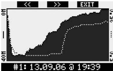
Auf der dritten Seite können Sie die Tiefenprofile zusammen mit den Pulsfrequenzprofilen einsehen. Wenn der Pulsmesser **AUS**geschaltet ist, wird diese Seite ausgelassen.
