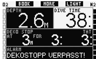
In der Konfiguration **FULL** wird die Alarmmeldung **DEKOSTOPP VERPASST!** während 12 Sekunden in der untersten Zeile und die Tiefe in umgekehrten Farben (weiß auf schwarzem Grund) solange angezeigt, wie sich der Taucher oberhalb der vorgeschriebenen Stoptiefe befindet. Das akustische Signal wird ausgegeben, bis der Taucher bis auf oder unter die vorgeschriebene Tiefe abtaucht.
