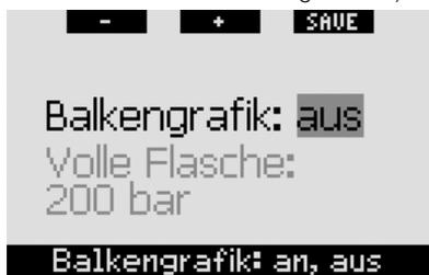
Das Balkendiagramm der Sauerstofftoxizität kann durch eine grafische Darstellung des Tauchgerätedrucks (nur **CLASSIC** und **FULL**) ersetzt werden. Wenn Sie diese Funktion **AN**schalten, wechselt die Beschriftung des Balkendiagramms von **O<sub>2</sub>** auf **TNK**. Um diese Funktion verwenden zu können, müssen Sie einen Druckwert eingeben, wenn der Tank voll ist. Jedes Segment im linken Balkendiagramm stellt
