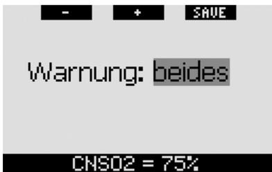
Erreicht der Wert CNS O<sub>2</sub> während des Tauchgangs 75% und die Warnung ist entweder auf **OPTISCH** oder **BEIDES** eingestellt, zeigt Galileo für 12 Sekunden die Meldung **CNS O<sub>2</sub> = 75%** anstelle der Nullzeiten- oder Dekompressionsinformationen.
