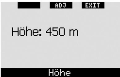
Für die Einstellung der Höhe **drücken** Sie zuerst auf **ADJ**, um das Menü **HÖHE EINSTELLEN** zu öffnen. Verwenden Sie in diesem Menü die Knöpfe **+** oder **-**, bis Sie den entsprechenden Wert eingestellt haben. Jedes Mal, wenn Sie **+** oder **- drücken**, wird die angezeigte Höhe um 10 m/50 ft verändert. **Drücken** Sie auf **SAVE**, um Ihre Auswahl zu bestätigen und zum Menü **Höhenmesser** zurückzukehren.
