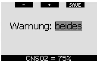
Wenn eine Warnung auf **OPTISCH** oder **BEIDES** eingestellt ist und ausgelöst wird, während Galileo sich im Kompassmodus befindet, schaltet das Display automatisch auf die normale Konfiguration zurück (**CLASSIC**, **LIGHT** oder **FULL**), um die Warnmeldung korrekt anzeigen zu können.
