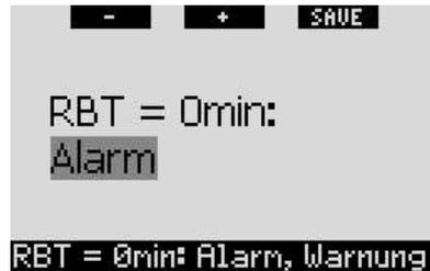
Wenn Sie mit nur einem Gasgemisch tauchen, löst RBT = 0 Minuten einen Alarm aus, der nicht ausgeschaltet werden kann (siehe Abschnitt 3.2.5): Wenn Sie den
