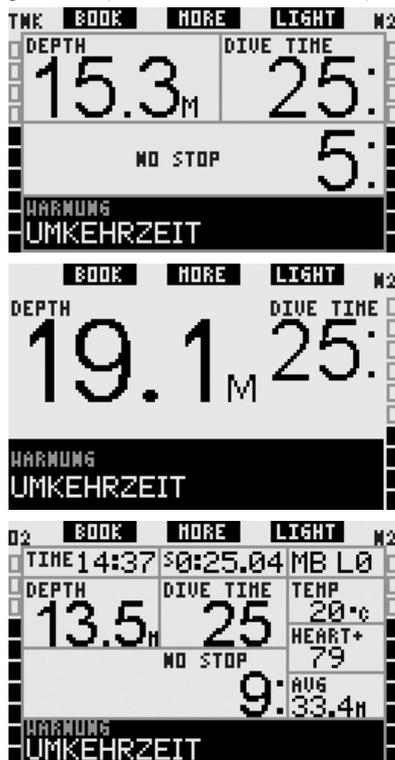
Wenn die eingestellte Tauchzeit abgelaufen ist, wird die Meldung **ZEITLIMIT ERREICHT** während 12 Sekunden angezeigt, und die Grundzeit wird in umgekehrten Farben (weiß auf schwarzem Grund) angezeigt. Die folgenden Abbildungen zeigen das Display in den verschiedenen Tauchkonfigurationen (**CLASSIC**, **LIGHT** und **FULL**).
