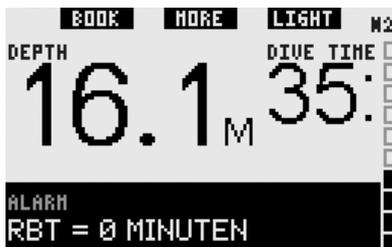
In der Konfiguration **FULL** wird die Alarmmeldung **RBT = 0 MIN** für 12 Sekunden anstelle der Nullzeit- oder Dekompressionsinformationen angezeigt. Während dieser Zeit ertönt das akustische Signal. Zusätzlich wird die RBT in umgekehrten Farben angezeigt (weiß auf schwarzem Hintergrund). Das hörbare Signal setzt nicht aus, bis die RBT wieder 1 Minute oder mehr erreicht oder bis Sie sich auf einer Tiefe von 6,5 m/20 ft oder darüber befinden.
