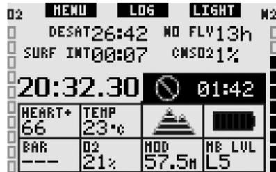
Sie sollten keinen Tauchgang unternehmen, solange die No-Dive-Warnung auf dem Computerbildschirm angezeigt wird. Wird die Warnung aufgrund der Mikroblasen-Ansammlung angezeigt (im Gegensatz zum CNS O<sub>2</sub>-Stand über 40%) und Sie tauchen trotzdem, werden die Nullzeiten verkürzt oder die Dekompressionszeiten ausgedehnt. Zudem wird die Dauer der Mikroblasen-Warnung am Ende des Tauchgangs beträchtlich verlängert.
