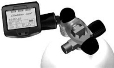
Nachdem der Smart-Sender unter Druck gesetzt wurde, sendet er eine Paarungssequenz an Galileo. Sobald Galileo diese Informationen empfängt, wechselt das Display und zeigt eine Liste von 4 Tankbezeichnungen an. Die
