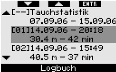
Die erste Seite enthält die Informationen über Tiefe, Zeit, Sauerstoffkonzentration, minimale Wassertemperatur und die laufende Nummer des Tauchgangs dieses Tages. Durch **Drücken** von >> gelangen Sie auf die zweite Seite, durch **Drücken** von << auf die letzte (sechste) Seite des **Logbuchs**.
