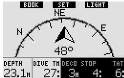
In diesem Layout sind die Knopffunktionen etwas unterschiedlich. Der mittlere Knopf wird nun als **SET** gekennzeichnet. Durch **Drücken** dieses Knopfes wird die Peilung eingestellt. Die Kompasspeilung stellt die Richtung dar, in der die Vorderseite des Computers ausgerichtet ist. Sie wird in Grad von 0 bis 359 ausgedrückt, wobei 0 Grad Norden, 90 Grad Osten, 180 Grad Süden, 270 Grad Westen und alle dazwischen liegenden Richtungen die entsprechenden Zwischenwerte bedeuten.
