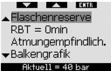
In diesem Menü können Sie die Tauchgeräte-reserve für die RBT-Berechnung einstellen. Sie können auswählen, ob bei RBT = 0 Minuten ein Alarm oder bloß eine Warnung ausgegeben werden soll (gilt nur für Tauchgänge mit
