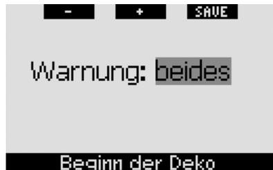
Wenn während eines Tauchgangs die Dekompressionsphase beginnt und die Warnung entweder auf **OPTISCH** oder **BEIDES** eingestellt ist, zeigt Galileo für 12 Sekunden die Meldung **BEGINN DER DEKO** auf dem Display an. Die folgenden Abbildungen zeigen das Display in den Tauchkonfigurationen (**CLASSIC** und **FULL**). Wenn Galileo auf **LIGHT** eingestellt war, wechselt er nun auf das Layout **CLASSIC**, damit alle Informationen angezeigt werden können.
