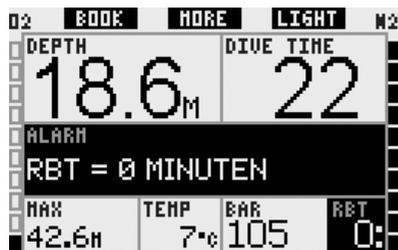
In der Konfiguration **LIGHT** wird die Alarmmeldung **RBT = 0 MIN** für 12 Sekunden anstelle der Nullzeitinformationen angezeigt. Während dieser Zeit ertönt das akustische Signal. Zudem wird nach dem Erlöschen der Textmeldung die RBT in umgekehrten Farben (weiß auf schwarzem Grund) in der rechten unteren Ecke angezeigt. Das hörbare Signal setzt nicht aus, bis die RBT wieder 1 Minute oder mehr erreicht oder bis Sie sich auf einer Tiefe von 6,5 m/20 ft oder darüber befinden.
