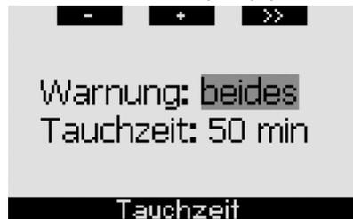
Wenn während eines Tauchgangs die Hälfte der eingestellten Tauchzeit abgelaufen ist und die Warnung entweder auf **OPTISCH** oder
