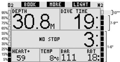
**Stickstoff-Balkendiagramm:** Dies ist das Balkendiagramm auf der rechten Seite des Displays (Konfigurationen **CLASSIC**, **LIGHT** and **FULL**). Es stellt die Stickstoffsättigung in den wichtigsten Gewebekompartimenten dar. Das Balkendiagramm besteht aus zehn Segmenten. Die ersten neun Segmente zeigen eine zunehmende Belastung an, jedoch noch immer innerhalb eines Nullzeit-Tauchgangs. Das zehnte Segment zeigt an, dass ein Dekompressionsstopp erforderlich ist.
