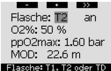
Markieren Sie **FLASCHE** und nutzen Sie die Knöpfe **-** und **+**, um die Flasche auszuwählen, für den Sie die Sauerstoffkonzentration einstellen möchten. **Drücken Sie >>**, um **AN** oder **AUS** zu markieren und nutzen Sie
