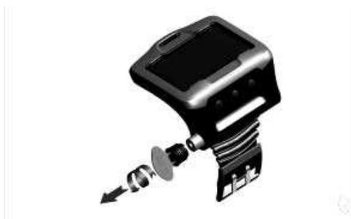
3. 检查电池舱盖上的O形密封圈。如果发现渗水的痕迹或者发现密封圈上有瑕疵或损坏，则要用UWATEC原厂配件(PN 06.202.693)更换O形密封圈。Galileo的电池组件(PN 06.202.872)就包括这个O形密封圈。更换密封圈的时候要确保新密封圈完好无损，涂好润滑油并且要确保密封圈，密封圈凹槽和密封面上没有污垢和灰尘。
