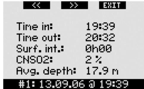
第4页显示潜水的入水时间，出水时间，本次潜水之前的水面间隔时间，本次潜水结束时的氧中毒指数(CNSO<sub>2</sub>)以及本次潜水的平均深度。
