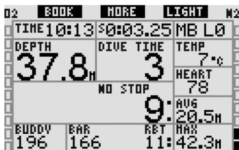
Galileo还有仪表模式的**GAUGE（仪表）**模式设定。在这种模式中潜水电脑只能作为数码深度表，不能进行任何减压运算。
