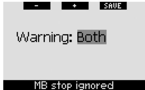
如果升水超过建议的等级停留深度并且这项警告被设定为**视频**或**视声并用**, Galileo将**忽略等级停留**讯息显示12秒钟, 并且以反转的颜色(黑底白字)显示深度, 直到潜水员重新下降到停留深度以下或者降低微泡等级(见2.6.11节和3.5.5节)。下列各图是**经典**和**全功能**画面设定显示的实际情况。
