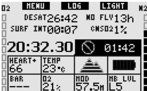
如在屏幕上仍显示不可潜水标志，你不应进行潜水。如果警告来自微泡聚积（相对CNS O<sub>2</sub>氧中毒指数高于40%）而你又继续潜水，你的免停留时间将会缩短或减压时间将会延长。除此之外，潜水结束时的微泡警告时间也会大大增加。
