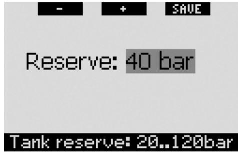
水下可滞留时间是指在当前深度可以滞留的时间, 并可以有充足的气体来进行安全升水和回到水面的时候气瓶还剩余压力。水下可滞留时间的计算基础是当前呼吸率, 计算内包含了所有必须的减压时间以及水中的温度梯度, 并且假定是以理想的速率升水(见3.2.1节)。设定较高的备用瓶压比较保守, 但是会减少潜水时间。设定较低的备用瓶压可以增加潜水时间, 但同时也增加了到达水面之前断气的风险。
