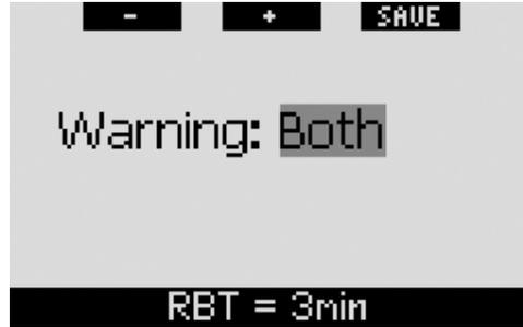
潜水时,如果水下可滞留时间 RBT 只剩 3 分钟并且这项警告被设定为**视频或视声并用**,Galileo 会将水下可滞留=3 分钟讯息显示 12 秒钟。此外,不管在什么格式,水下可滞留时间 RBT 是以反转的颜色来(黑底白字)显示。下列各图是三种画面设定显示的实际情况(经典,简化和全功能)。
