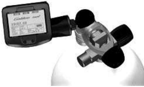
加压之后，气瓶传送器开始向Galileo发送同步序列信号。当Galileo接收到这信息，就开始显示一个有4支气瓶代号组成的列表。4支气瓶分别以**T1**、**T2**、**TD**和**BUDDY**表示。气瓶**T1**永远是你的主气瓶。气瓶**T2**和**TD**是供潜水时，使用超过一个混合气体气瓶时使用的，3.7节有详细描述。气瓶**BUDDY**允许你接收潜伴的瓶压信息，并在屏幕在显示，如果他 also 装有气瓶传送器（详情见第3章）。
