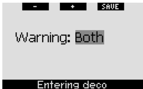
潜水时，如果你将进入减压潜水并且这项警告被设定为**视频或视声并用**，Galileo将**进入减压程序**讯息显示12秒钟。以下2图是**经典**和**全功能**画面设定显示的实际情况。如果Galileo被设定成**简化**画面设定，到这个时候它会自己切换到**经典**画面设定以适应显示信息的需要。
