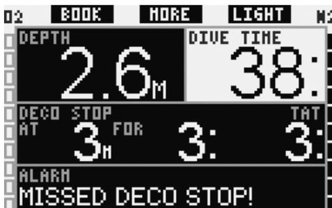
在FULL (全功能) 画面设定中，警报信息忽略减压停留! 在屏幕底行显示12秒钟，深度则以反转色(黑底白字)显示。只要潜水员在规定的停留深度之上，这种情况就会一直延续下去。音频警报也会一直持续，直到潜水员回到规定的停留深度以下。
