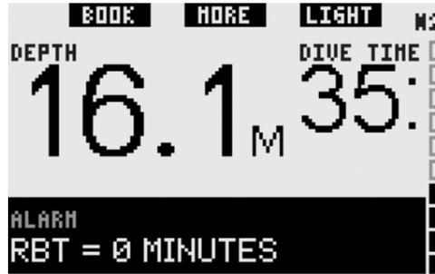
在FULL (全功能) 画面设定中, 警报信息水下可滞留= 0分钟在免停留潜水时间或减压时间的位置显示12秒钟并同时触发音频警报。此外, 水下可滞留时间以反转色(黑底白字)显示。音频警报持续不断, 直到水下可滞留时间恢复到1分钟或者升水到6.5米/20英尺以上。
