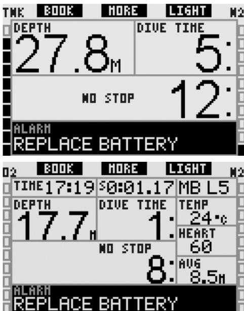
除了监测自己的电池状况之外，Galileo还同时监测气瓶传送器T1、T2和TD中的电池状况并在电量不足的时候，提醒潜水员更换电池。屏幕中间一行以4秒钟的间隔显示T1（或T2或TD）**电量低**。在LIGHT（简化）画面设定中，潜水电脑将自动切换回CLASSIC（经典）画面设定以正确显示相关信息。
