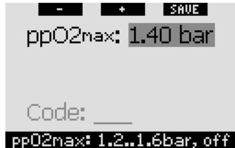
如你把最大氧分压ppO2max设定为关，你将失去MOD最大作业深度的警告。如果选择关，你必须使用密码加以确认。密码是313。其目的是防止误将最大氧分压ppO2max关闭。输入密码的时候，用+和-按钮先输入第一位数字(3)，然后短按>>确认，再输入下一位数字(1)，短按>>确认，然后再输入最后一位数字(3)。输完最后一位，短按SAVE(存储)，最大氧分压ppO2max就被关闭了。屏幕会显示ppO2max SET TO OFF SUCCESSFUL (ppO2max关闭成功) 2秒钟。
