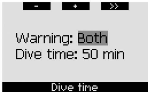
潜水时，如果设定的潜水时间过半并且这项警告被设定为视频)或视声并用，Galileo将已到回程时间讯息显示12秒钟。下列各图是三种画面设定显示的实际情况(经典,简化和全功能)。
