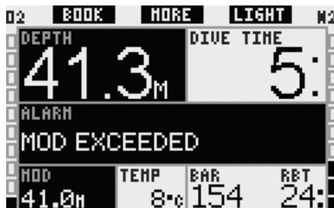
在**LIGHT (简化)**画面设定中，警报信息**超过MOD**在免停留潜水时间的位置显示12秒钟。此外，当前深度会以反转色（黑底白字）显示。这种状况直到潜水员上升到最大作业深度 (即MOD) 以上 1米/3英尺处才会改变。同样音频警报也会延续到潜水员上升到最大作业深度 (即MOD) 以上 1米/3英尺处才会停止。
