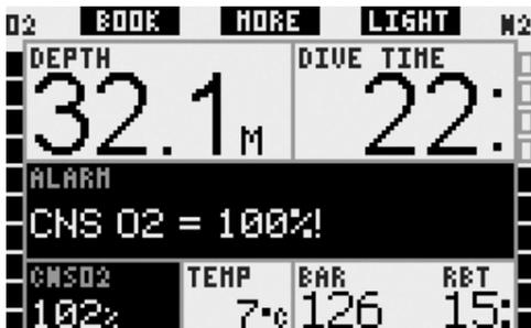
在LIGHT (简化) 画面设定中，警报信息CNS O<sub>2</sub> (氧中毒指数) = 100%在免停留潜水时间的位置显示12秒钟并同时触发音频警报。此外，在文本信息消失之后，中枢神经氧中毒指数CNS O<sub>2</sub>会以反转色(黑底白字)显示屏幕的左下角并以4秒钟的间隔交替显示气瓶压力。只要中枢神经氧中毒指数CNS O<sub>2</sub>在100%以上，这种情况就会继续下去。可以交替显示其它信息，见3.3.3节。
