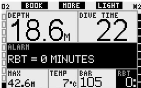
在LIGHT (简化) 画面设定中, 警报信息水下可滞留= 0分钟在免停留潜水时间的位置显示12秒钟并同时触发音频警报。此外, 在文本信息消失之后,
