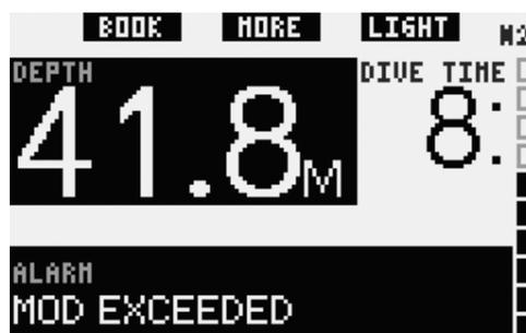
在**FULL (全功能)**画面设定中，警报信息**超过MOD**在免停留潜水时间或减压时间的位置显示12秒钟。此外，当前深度会以反转色（黑底白字）显示，**最大作业深度 (即MOD)** 和其值也会以反转色显示在最大深度的位置。这种状况直到潜水员上升到最大作业深度 (即MOD) 以上 1米/3英尺处才会改变。同样音频警报也会延续到潜水员上升到最大作业深度 (即MOD) 以上 1米/3英尺处才会停止。
