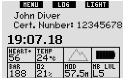
如果潜水电脑在上次潜水的去饱和过程还没有结束, 屏幕的上部将显示以下信息: 去饱和和时间, 禁止飞行时间, 水面间隔时间, 以及CNS O<sub>2</sub>氧中毒指数 (如果适用的话)。
