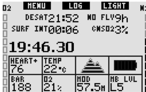
剩余的去饱和时间 (DESAT) 是根据电脑内的减压程式计算出来的。任何潜水开始时电脑上还有剩余的去饱和时间将被被认为是重复潜水, 这意味着Galileo在运算时会包含你体内的剩余氮气负荷。
