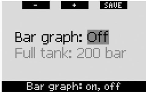
氧中毒条码图表可被换成气瓶压力条码图表（仅在经典和全能画面设定中有效）。如果这个选项设定为开，这个条码图表的标注就从O<sub>2</sub>变成TNK。使用这一功能的时候必须设定满瓶时的气压，这样左边条码图表上的每一段就代表1/10的满瓶值。例如，满瓶时气压是200bar/3000psi，条码图表上的每一段就代表20bar/300psi。随着瓶内的气体消耗，这个条码图表会逐段熄灭。
