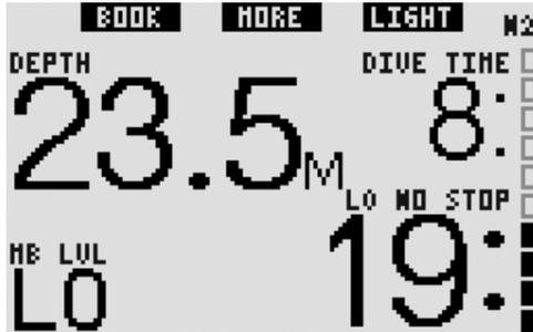
在FULL（全功能）画面设定中，后台L0信息的显示顺序在BUDDY（潜伴）瓶压后面，氧中毒CNS O<sub>2</sub>指数前面，取代微泡等级免停留潜水时间或减压信息，显示5秒钟。然后，屏幕恢复显示与当前微泡等级有关的信息。
