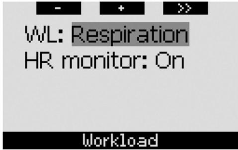
如果WL（工作负荷）被设定为**心跳率或永远最高**，屏幕则显示 **HEART +（心跳率+）**，而不仅仅是HEART（心跳率）。如果WL（工作负荷）被设定为**永远最低**，屏幕则显示 **HEART -（心跳率-）**，而不仅仅是HEART（心跳率）。如果WL（工作负荷）被设定为**呼吸率或关**，而心跳监测器也被关闭，屏幕则显示 **HEART OFF（心跳率关闭）**。
