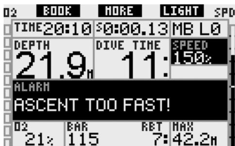
Galileo电脑在升水速度超过110%的时候还会发出音频警报：超出理想升水速度越多，音频警报的密度就越大。
