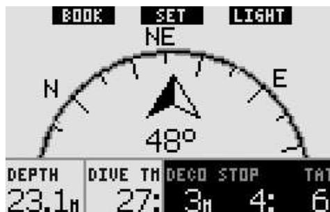
显示指南针的时候，按钮功能稍有变化。中间按钮变成了**SET**(设定)。短按这个按钮可以设定方位。指南针的方位代表电脑的前方指向，以度数为单位，0至359度，0度为北，90度为东，180度为南，270度为西，所有方位都在这个范围之内。一旦设定了方位，屏幕就会显示**方位设定成功**字样，并且在设定的方位上会出现一个圆点。设定方位可以使潜水员潜航时有个参考方向。长按中间按钮可以删除设定的方位。注意，设定的方位存储在内存中，直到设定了新的方位或者删除。所有设定的方位都被存储在潜水记录中，可以通过SmartTRAK软件下载到PC机上查看。
