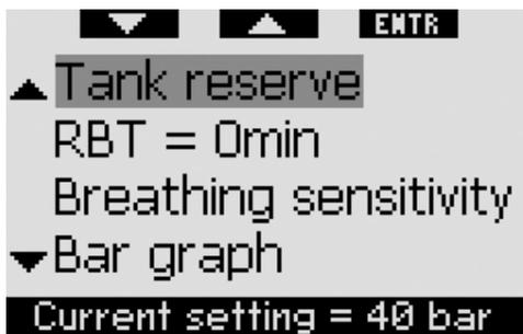
这菜单可以设定计算水下可滞留时间的备用瓶压, 你可选择在水下可滞留时间=0分钟时是警报还是警告(只适用于多气体潜水)。你也可以设定呼吸敏感度以供计算工作负荷(如果工作负荷不是根据心跳率计算, 见2.9.5节), 还可以把氧中毒条码图表更换成气瓶压力图形指示条(仅适用于经典和全功能画面设定)。通过这个菜单还可以调用气体概要表, 详情见1.12节。
