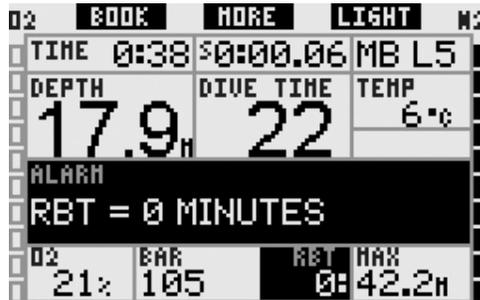
另外, 无论哪种画面设定, 如果气瓶压力降至备用气压, 屏幕就会显示到达备用瓶压12秒钟并且气瓶压力以反转色(黑底白字)显示。
