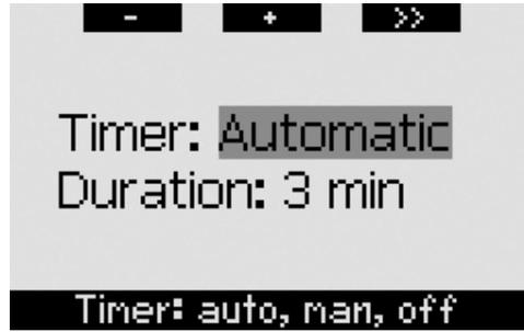
在更改设定的过程当中，如果潜水电脑连续3分钟没有收到任何输入就会自动切换回**当天时间**显示而不存储任何更改。
