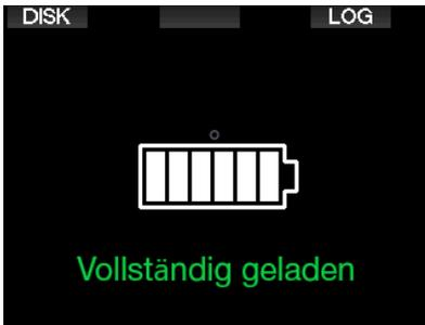
Der G2 wird Sie durch das Anzeigen des Batteriesymbols darauf aufmerksam machen, wenn der Batteriestand zu tief ist.
