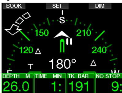
**HINWEIS:** Verwenden Sie den Kompass des G2 nicht in der Nähe eines Magnets, weil das magnetische Feld die Kompasskalibrierung zurücksetzen könnte.
