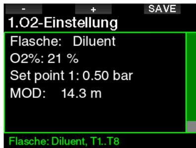
Für Setpoint 2 kann zwischen 1,0 bis 1,6 bar ausgewählt werden. Da höhere Werte an der Oberfläche nicht erreicht werden, wird für diese Einstellung eine AMD berechnet.
