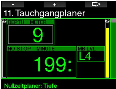
Wenn ein Oberflächenintervall oder keine weitere Sättigung vorliegt, kann der Planer die Tiefe in Intervallen von 3 m anzeigen. Die Nullzeit für diese Tiefe wird angezeigt.
