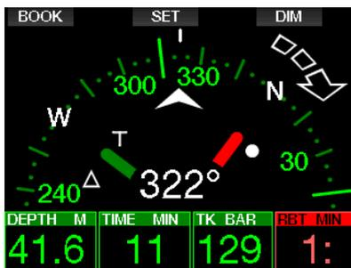
Bei erforderlichen Level-Stopps oder Dekompressionsstopps wird die Anzeige in der unteren rechten Ecke alle 4 Sekunden zwischen der Dekompressionsinformation und dem Flaschendruck zusammen mit der RBT wechseln.
