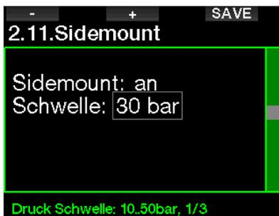
Wenn der Sidemount-Modus des G2 aktiviert ist (AN), werden zwei Flaschendrucke gleichzeitig angezeigt. Siehe Kapitel **Tauchen im Sidemount-Modus**, um mehr über die Konfiguration des Displays in diesem Modus zu erfahren.
