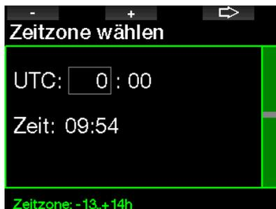
Wählen Sie die Zeitzone mit der linken oder mittleren Taste und bestätigen Sie sie mit der rechten Taste.
