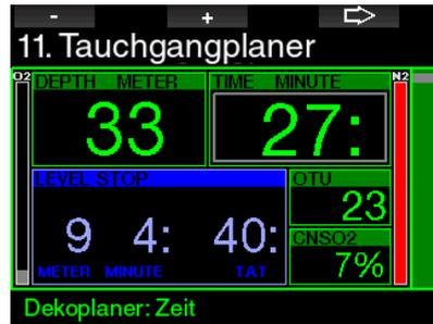
Durch Drücken der PFEIL-Taste für die geplante Tiefe kann die Tauchzeit geändert werden. Der Startpunkt (jetzt Minimum) ist die Nullzeit. Die Zeit kann in Intervallen von 1 Minuten eingegeben werden. Der tiefste Dekompressions- oder MB Level-Stopp wird zusammen mit der gesamten Aufstiegszeit angezeigt.
