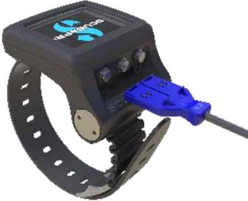
Unten ist die korrekte Methode zum Einstecken des Steckers dargestellt.
