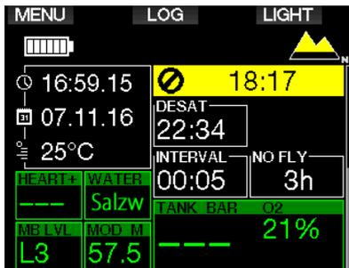
Sie sollten keinen Tauchgang unternehmen, solange die Tauchverbotswarnung auf dem Computerdisplay angezeigt wird. Wird die Warnung aufgrund der Mikroblasen-Ansammlung angezeigt (im Gegensatz zum ZNS  $O_2$ -Stand über 40 %) und Sie tauchen trotzdem, werden die Nullzeiten verkürzt oder die Dekompressionszeiten verlängert. Zudem kann die Dauer der Mikroblasen-Warnung am Ende des Tauchgangs beträchtlich verlängert werden.
