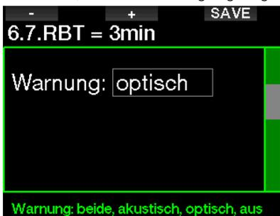
Wenn die RBT 0 Minuten erreicht, wird ein Alarm ausgelöst: Wenn Sie den Aufstieg nun einleiten und mit der idealen Aufstiegsgeschwindigkeit aufsteigen, erreichen Sie laut Berechnungen des G2 die Oberfläche mit der Flaschenreserve in der Flasche. Durch sämtliche weiteren Verzögerungen steigt das Risiko, dass das Atemgas ausgeht, bevor Sie die Oberfläche erreicht haben.
