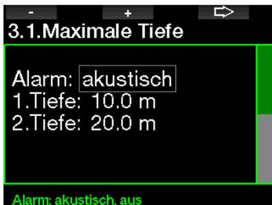
Nach dem Aktivieren des Alarms Maximale Tiefe können die Grenzwerte eingegeben werden. Der erste Tiefenalarm kann zwischen 5 - 100 m eingestellt werden.
