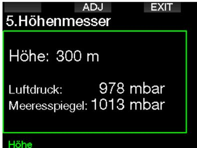
**HINWEIS:** Der Barometerdruck ist variabel und hängt vom Wetter und dem Umgebungsdruck auf dieser Höhenlage ab. Der Tauchalgorithmus verwendet die Höhenbereiche, die direkt vom Barometerdruck abhängig sind. Die Höhe wird vom aktuellen Barometerdruck abgeleitet und ist daher ein relativer Wert.
