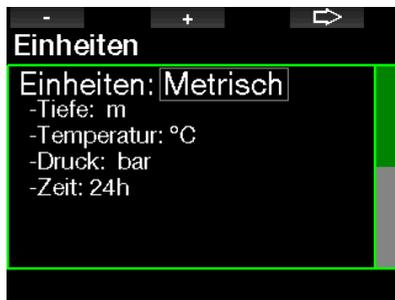
Wählen Sie jede Einheit mit der linken oder mittleren Taste und bestätigen Sie sie mit der rechten Taste.
