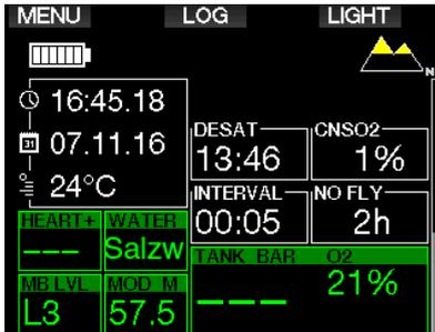
Die erlaubten Höhen werden mit dem Bergsymbol oben rechts auf dem Tageszeit-Display angezeigt. Die verbotenen Höhen (die nach den Berechnungen des G2 nicht kompatibel mit der aktuellen Stickstoffsättigung sind), sind die farbigen Segmente innerhalb des Bergsymbols. Für weitere Details siehe Kapitel: **Höhe und Dekompressionsalgorithmus**
