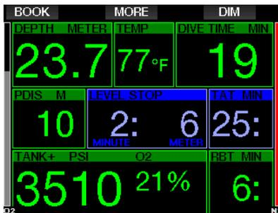
Wenn der berechnete PDI-Stopp tiefer als 8 m liegt, zeigt der G2 ihn auf dem Display an (Fenster mitte links), bis Sie während des Aufstiegs die angezeigte Tiefe erreicht haben. Der angezeigte Wert ändert sich während des Tauchgangs, da der G2 die Stickstoffaufnahme in den 16 Kompartimenten fortlaufend überwacht und zu jedem Zeitpunkt die jeweils optimale PDIS-Tiefe anzeigt.
