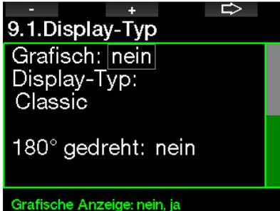
**HINWEIS:** Der Display-Typ *Light* unterstützt keine Tauchgänge mit Level-Stops oder Dekompressionsstops. Wenn Sie den Display-Typ *Light* gewählt haben und Sie Level-Stops und Dekompressionsstops eingeben, wechselt der Display-Typ während des Tauchgangs automatisch auf *Classic*, bis Sie alle Level-Stops und/oder Dekompressionsverbindlichkeiten erfüllt haben.
