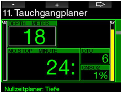
ZNS% und OTU Werte werden angezeigt, wenn für diese Tiefe mit maximaler Nullzeit 1 % erreicht werden.
