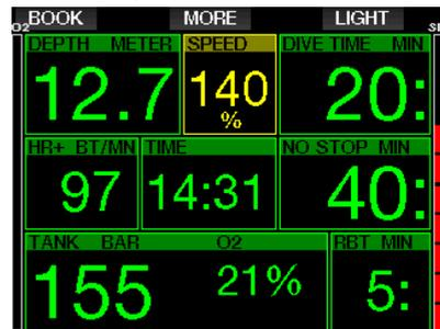
Bei Aufstiegsgeschwindigkeiten von über 140 % wird die Warnung **AUFSTIEG ZU SCHNELL!** angezeigt und das Fenster wird rot.
