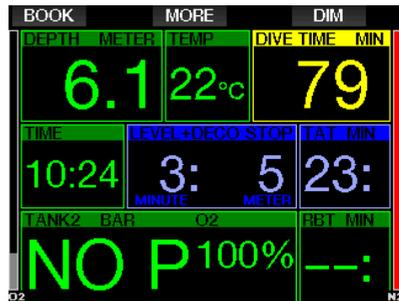
Der G2 wird die Meldung **AUF GAS T1 WECHSELN** anzeigen. Drücken Sie nun die Taste SAVE, um den Wechsel zu bestätigen und die PFEIL-Taste, um ein anderes Gas auszuwählen.
