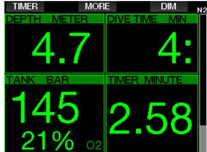
Der Sicherheitsstopp-Timer kann durch Drücken der Taste TIMER erneut zurückgesetzt werden.
