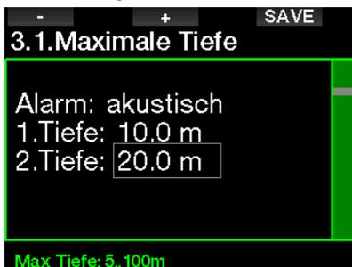
**HINWEIS:** Der erste Alarm ist kurz, um die Aufmerksamkeit zu wecken, und der zweite Alarm ist kontinuierlich. Wenn der erste Alarm tiefer als der zweite gesetzt wird, wird er vom kontinuierlichen Alarm übertönt und Sie können den ersten nicht hören.
