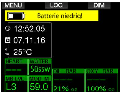
Zusätzlich wird das Batteriesymbol mit dem aktuellen Status über der Tageszeit angezeigt.
