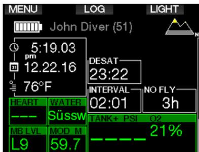
Die verbotenen Höhenbereiche werden durch gelbe Segmente innerhalb des stilisierten Bergsymbols angezeigt (Displayfarben der Werkseinstellung). Diese können mit grauen Segmenten kombiniert sein, welche die aktuelle Höhe anzeigen (Displayfarben der Werkseinstellung). Im oben aufgezeigten Beispiel befindet sich der Taucher auf Höhenbereich 1 und darf den Höhenbereich 4 nicht erreichen oder übersteigen.
