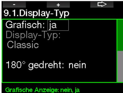
Der Display-Typ **Light** ist die Werkeinstellung. Es zeigt nur die grundlegenden Informationen mit großen Ziffern. Wenn der Tauchgang Dekompression oder die Anzeige weiterer Daten erfordert, wechselt der Display-Typ automatisch auf **Classic**.
