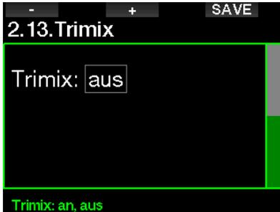
Wenn Trimix an ist, folgt die Darstellung der Gasgehalte dem Standard O<sub>2</sub>/He. Auch die AMD (absolute Minimaltiefe) für jedes Gas wird gezeigt. Siehe Kapitel: **Tauchen im Trimix-Modus**, um mehr über die Anwendung dieser Funktion zu erfahren.
