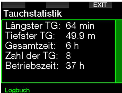
Jeder Tauchgang wird mit einer fortlaufenden Nummer, dem Tauchdatum, der maximalen Tiefe und der gesamten Tauchzeit gespeichert.
