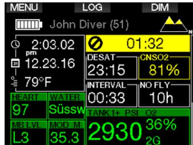
Die CNS O<sub>2</sub> -Uhr steigt, wenn der Sauerstoffpartialdruck höher liegt als 0,5 bar und sinkt, wenn der Sauerstoffpartialdruck tiefer liegt als 0,5 bar. Daher sinkt die CNS O<sub>2</sub>-Uhr jeweils, wenn Sie an der Oberfläche Luft atmen. Während des Tauchgangs sind die Tiefen, bei denen für verschiedene Gemische 0,5 bar erreicht werden, die Folgenden:
