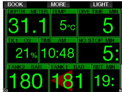
**Verzögerter Gaswechsel:** Sie können einen empfohlenen Flaschenwechsel jederzeit nachholen, indem Sie die Flasche manuell auswählen. Drücken und halten Sie die Taste BOOK, um den Flaschenwechsel einzuleiten. Der G2 wird die Meldung AUF GAS T2 WECHSELN anzeigen. So können Sie prüfen, ob Sie einen Flaschenwechsel zu einer empfohlenen Flasche durchführen. Nun können Sie durch Drücken der Taste SAVE den Wechsel bestätigen. Der G2 wird die Meldung AUF GAS T2 WECHSELN ERFOLGREICH anzeigen.
