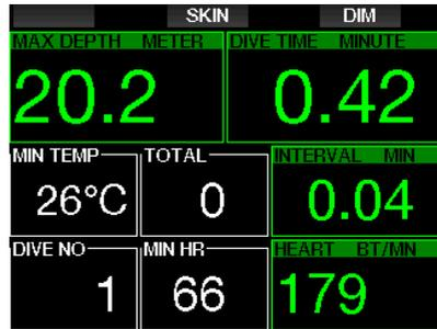
Während des Tauchgangs zeigt der Apnoe-Modus die aktuelle Tiefe, die Tauchzeit oder Abtauchgeschwindigkeit, die Wassertemperatur, die maximale Tiefe und den Puls.
