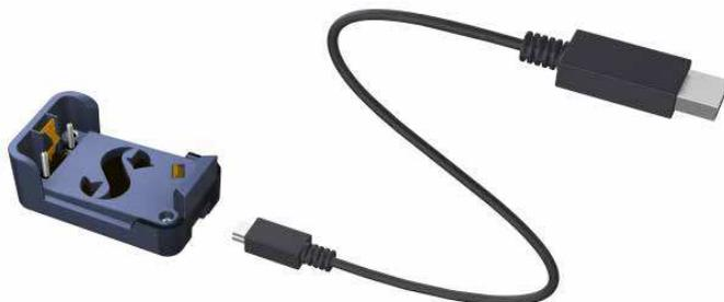
Die Kommunikation zwischen dem Chromis und dem Auslesegerät erfolgt über die Kontakte am Gehäuse. Wenn die Wasserkontakte oder der Federkontakt des Auslesegeräts schmutzig ist, sollten Sie diese vor der Verwendung mit einem Tuch reinigen.
