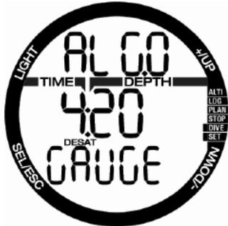
Nach einem SCUBA-Tauchgang kann auf den Gauge- oder APNOE-Modus gewechselt werden, wenn die Entsättigungszeit abgelaufen ist.
