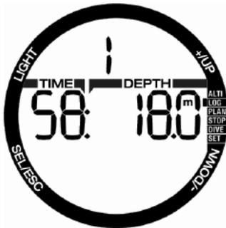
Durch Drücken von + oder - kann durch die Tauchgänge der aktuellen Serie geblättert werden.
