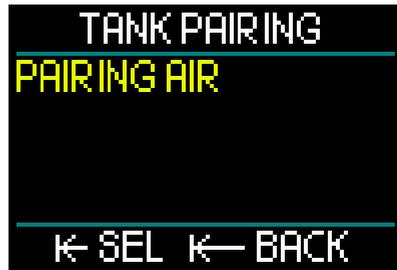
7. 您在第4步中选中的气体将被标亮。按下并释放推轮。这将启动配对过程并开始倒计时。
