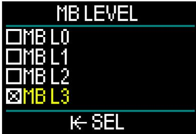
您可以在此处选择在潜水过程中希望使用的从0至5的Microbubble (MB·微气泡) 水平。等级0保守度最低。等级5保守度最高。通过旋转推轮切换至您的选择。通过按下并释放推轮保存选择，您还会自动转回至Dive Setting (潜水设定) 菜单屏幕。只有当您使用ZHL-ADT算法潜水时才能启用MB等级功能。
