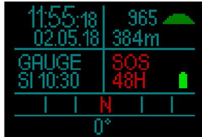
图中所示为SOS（紧急求救）模式显示信息。在原本显示不可飞行时间的位置，显示48小时倒计时。
