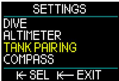
Settings ( 设定 ) 中的下一项是Tank Pairing ( 气瓶配对 )。通过按下并释放推轮，您将进入一项菜单，可以在这里创建Smart传感器和HUD之间的无线连接。
