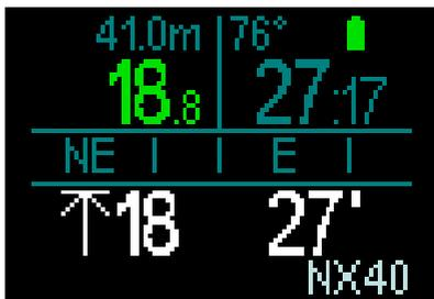
在上升时，当您到达当前使用气体以外气体对应的最大操作深度时，HUD会建议您进行转换。建议的气体会在右下角显示为闪烁的白色。您有20秒钟的时间来回复此信息并作出转换；否则HUD将停止建议气体转换并重新计算您的减压义务和总上升时间。如果您稍后希望使用该气体，将需要进行手动激活。
