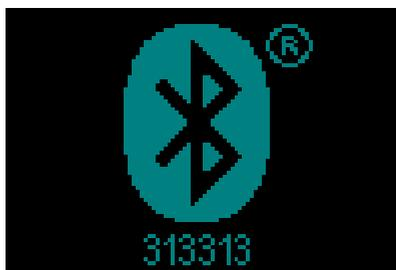
此刻HUD准备好进行Bluetooth通讯。Bluetooth仅在此菜单显示时为激活状态。如需建立Bluetooth连接，将您希望HUD与之通讯的设备（如Apple或Android手持设备）设定为“扫描”模式。第一次连接时需要输入安全码以保证安全通讯。安全码位于屏幕上Bluetooth图标的下方。需连接的设备接受安全码后，通信连接建立，HUD将显示以下屏幕。
