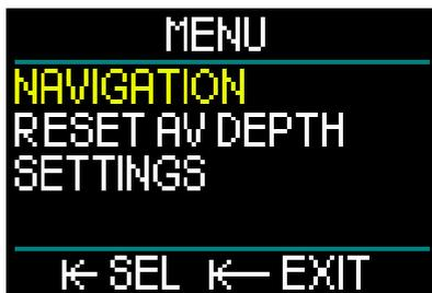
在Gauge ( 仪表 ) 模式下潜水时，HUD在左上角显示平均深度。您可以通过进入Settings ( 设定 ) 菜单并选择Reset Av Depth ( 重置平均深度 ) 来加以重置。
