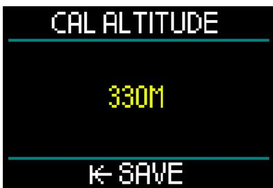
在Altitude ( 海拔 ) 菜单中，现时的海拔是根据大气压计算得出。若已知现时高度，可以调整海拔。( 调整海拔高度，对您的潜水无影响。 )
