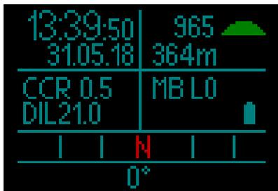
注：如果选中了GF算法，Surface（水面）屏幕将显示微气泡（MB）数据，而非CCR设置。
