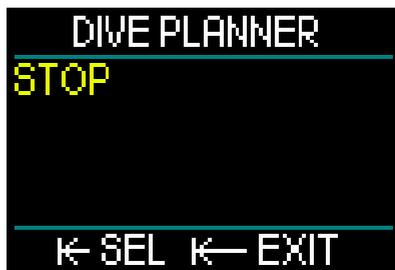
模拟结束后，如果无任何动作长达1分钟，潜水计划表将自动转回至Surface（水面）屏幕。
