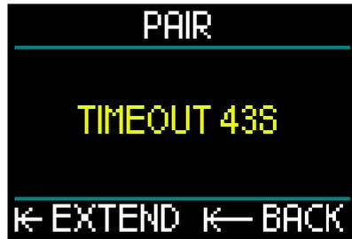
8. 随着倒计时进行，打开气瓶阀门。受压时，Smart传感器将向HUD发送配对序列。
