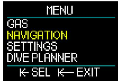
在Navigation（导航）菜单下，您可以设定偏好的罗盘方向和GPS航路点。此菜单在所有潜水模式下均可用。
