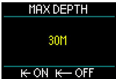
👉 注意：警报设置开启后，顶行将显示 MAX DEPTH 30M (最大深度30米)。警报关闭时，顶行将仅显示 MAX DEPTH (最大深度)。
