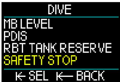
在Dive Settings (潜水设定) 菜单下，通过选择Safety Stop (安全停留) 和按下并释放推轮，您将进入启用/禁用安全停留计时器的屏幕。
