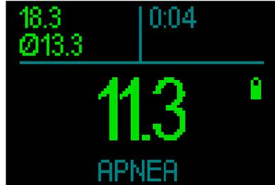
Apnea (闭气潜水) 屏幕显示最大深度、平均深度和时间。
