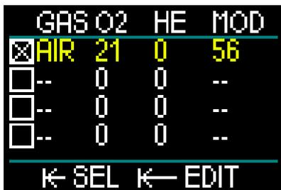
HUD允许您编程或变更多达8种气体。当您设置氧气和氮气水平时，您选中的值的Maximum Operating Depth (MOD·最大操作深度) 将自动加以显示。如需了解更多关于使用高氧潜水以及最大操作深度的相关信息，请见章节：**高氧潜水**
