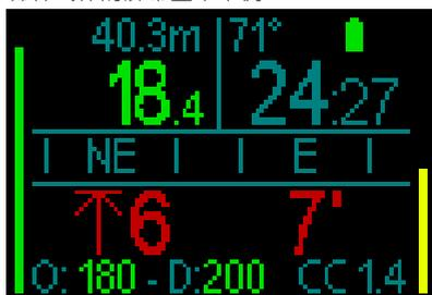
在右侧底行显示SP2和左侧底行显示氧气/稀释气体的屏幕显示示例。
