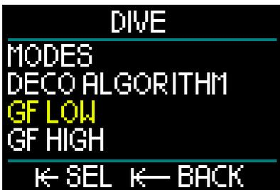
• GF Low (GF低值) 是代表M值 (最大值) 百分比的数字设置，决定了您在潜水上升过程中的第一处停留。不应在停留过程中的任一点超过GF Low (GF低值)。
