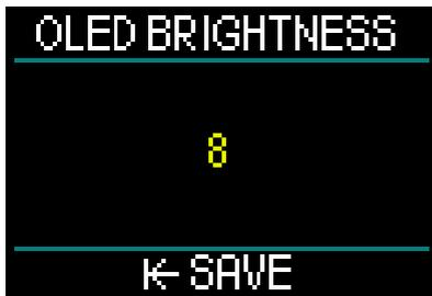
您可以通过旋转推轮选择从0 (最暗) 至10 (最亮) 的适合您视觉偏好的屏幕亮度。然而请记住，显示是能量消耗方面决定充电之间电池使用寿命的主要因素。换言之，您选择的亮度水平将决定在需要重新充电之前您还有多少使用时间。
