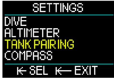
6. 在Settings（设定）菜单下，旋转推轮以向下切换至Tank Pairing（气瓶配对）。按下并释放。
