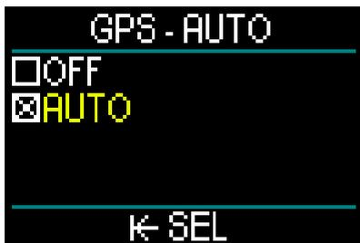
在GPS AUT（自动）模式中，您可以通过在Surface（水面）屏幕下旋转推轮，获取当前的时间、日期，以及您的GPS坐标。相对于当前设定航路点的True Heading（TH·真实航向）和距离该航路点的Total Distance（TD·总距离）同样会加以显示。
