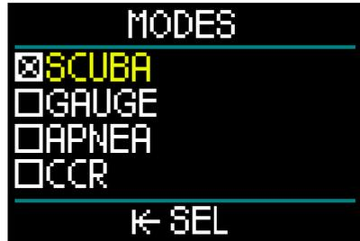
您的 HUD 为您提供 SCUBA ( 水肺潜水 )、Gauge ( 仪表 )、Apnea ( 闭气潜水 ) 和 CCR ( 密闭循环呼吸器 ) 模式的选择。
