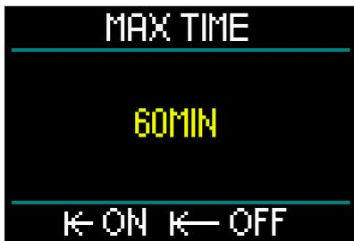
👉 注意：警报设置开启后，顶行将显示 MAX TIME 60MIN (最长时间60分钟)。警报关闭时，顶行将仅显示 MAX TIME (最长时间)。
