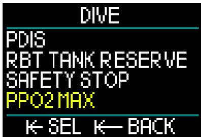
在Dive Settings (潜水设定) 菜单下，通过选择ppO<sub>2</sub>max (氧分压最大值) 和按下并释放推轮，您将进入调整氧分压最大值设置的屏幕。
