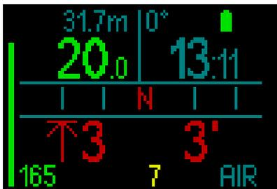
**减压信息。** HUD计算强制性减压停留的必要时，会显示您最深的停留深度（屏幕左下方，在3米旁显示一个箭头，为红色）。还会显示总上升时间（3分钟，显示于右下方）。
