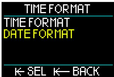
在Time Format（时间格式）菜单下，旋转推轮以切换至Date Format（日期格式），然后按下并释放。
