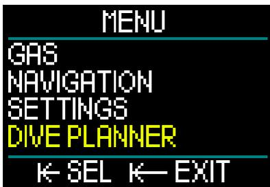
您可以根据您体内的氮饱和，使用潜水计划表计划下次的潜水。它还能帮助您了解 HUD 在潜水过程中是如何工作的。潜水计划表可以根据您的不同深度水平模拟潜水。模拟以 10 倍加速运行。因此 6 秒的模拟时间对应了 1 分钟的潜水时间。
