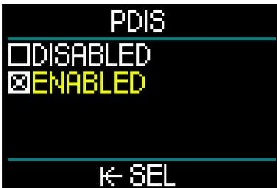
HUD的Profile Dependent Intermediate Stops (动态中间深度停留) 功能根据您的身体承受的氮吸入量计算一个中间停留，并考虑您的当前潜水、此前潜水和呼吸混合气。只有当您使用ZHL-ADT算法潜水时才能启用PDIS功能。通过按下推轮保存选择，您还会自动转回至Dive Setting (潜水设定) 菜单屏幕。
