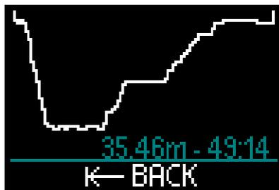
按下并释放推轮将带您前往Profile (潜水曲线图) 屏幕，显示带有深度和潜水总时长的潜水曲线。通过按下并释放推轮可退出Profile (潜水曲线图) 屏幕。
