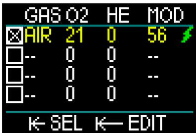
同时，Gas（气体）菜单屏幕上会显示一个绿色闪电符号，表示传感器与气体已配对。如需配对另一个传感器，从第3步开始并重复该过程。
