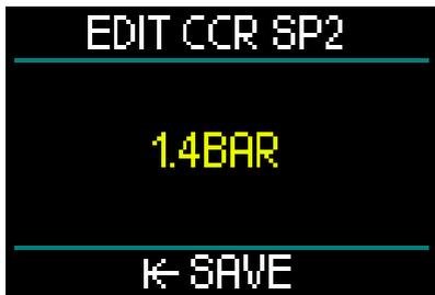
此屏幕显示了一项设定点2设置的样本。设定点2的可选范围是1.0-1.6巴。这一子菜单在潜水过程中可用，您可以随时随地通过它转换为逃生气体。您可以在Surface（水面）屏幕左下方的数据框中查看CCR设置概要。
