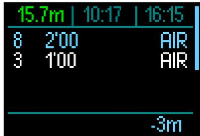
通过旋转推轮，您还可以获取包括PDIS停留在内的全部减压停留的信息显示。
