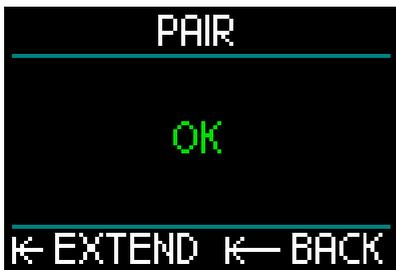
9. 等待直至传感器和HUD建立连接。一旦配对成功，屏幕将显示“OK”，并转回至Tank Pairing（气瓶配对）屏幕。
