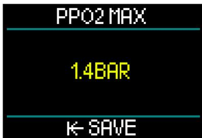
氧分压最大值设定定义了氧分压的最大限定值。所有气体具备相同的值。HUD提供从1.3巴至1.6巴的氧分压最大值设定(出厂设定为1.4巴)。
