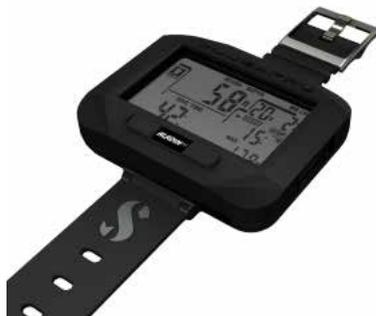
Auf der Oberfläche können über die Knöpfe Funktionen aufgerufen, auf Menüs zugegriffen und Einstellungen geändert werden. Beim Tauchen können Sie damit Markierungen setzen, zusätzliche Daten auf dem Tauchcomputerdisplay abrufen, das Atemgasgemisch ändern und die Displaybeleuchtung aktivieren.
