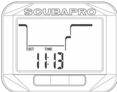
Im Menü Einstellen der Zeit läuft die aktuelle Zeit. Durch Drücken von SEL wird die Zeiteinstellung aktiviert und die Stunden beginnen zu blinken. Sie können durch Drücken des Knopfs rechts oder links durch die Stunden blättern. Durch Drücken von SEL beginnen die Minuten zu blinken und können durch Drücken des Knopfs rechts oder links bearbeitet werden. Durch Drücken von SEL wird die Zeit bestätigt.
