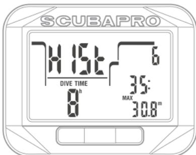
Der oben mit Display angezeigte Computer hat eine tiefste Tiefe von 30,8 Meter und eine längste Tauchzeit von 35 Minuten erreicht. Insgesamt wurden mit diesem Square 8 Stunden getaucht und 6 Tauchgänge durchgeführt. Die History kann nicht gelöscht werden.
