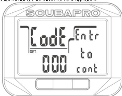
Der Textcode (eingeben, um weiterzufahren) wird angezeigt und das erste Zeichen des Codes beginnt zu blinken. Durch Drücken des Knopfs rechts oder links kann die Zahl geändert werden und mit SEL wird sie bestätigt. Die nächste Zahl beginnt zu blinken. Der Freigabecode für „Signalton aus“ lautet: 313.
