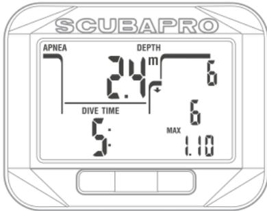
Durch Drücken von SEL wählen Sie den Tauchgang aus und kommen zur Unteranzeige, die im Apnoe-Modus die Startzeit und das Datum anzeigt:
