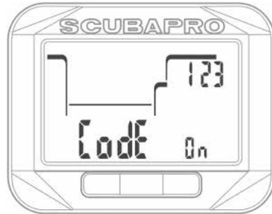
**HINWEIS:** Beim Ersetzen der Batterie wird die Pinnummer zurückgesetzt und die Sperre deaktiviert.
