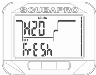
Durch Drücken von SEL in diesem Menü beginnt die Einstellung Salt oder Fresh auf der unteren Zeile zu blinken. Sie können durch Drücken des Knopfs rechts oder links zwischen diesen zwei Werten wechseln und die Auswahl mit SEL bestätigen.
