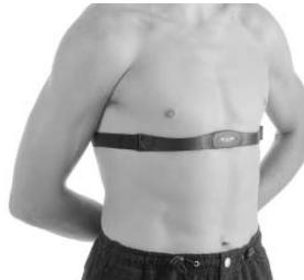
El transmisor codificado Polar T31 tiene una batería que dura aproximadamente 2500 horas. El transmisor se activa por la humedad. Si lo deja, por ejemplo, en una toalla mojada, la tensión de la batería se irá consumiendo. Si cree que la batería se ha agotado, póngase en contacto con un centro de reparaciones autorizado de Polar para que sustituyan el transmisor. Polar recicla los transmisores usados.
