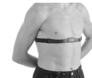
L'émetteur codé Polar T31 possède une pile dont la durée de vie est d'environ 2500 heures. L'émetteur est activé par le contact de l'humidité, par conséquent le laisser sur une serviette humide, par exemple, utilisera de l'énergie de la pile. Si vous pensez que la pile est épuisée, contactez un Centre d'entretien agréé Polar pour obtenir un émetteur de remplacement. Polar recycle les émetteurs usagés.
