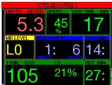
如果在进行必要的减压停留时，您上升至所需停留深度以上超过0.5米/2英尺处，G2将激活警报。当前深度值及信息：“错过减压停留！”将被加以显示，并且可听到一连串哔哔声。若您继续停留在0.5米/2英尺以上的深度，警报会持续。
