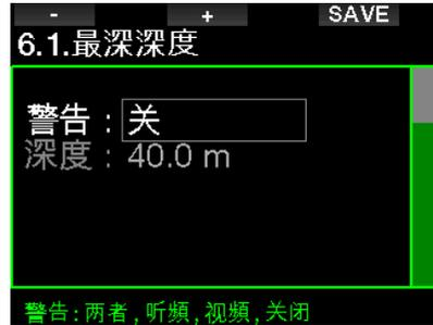
通过选择“关”可以禁用警告。在警告情况发生时，视觉警告选择将进行警告显示。在警告情况发生时，听觉警告选择将进行警告发生。通过选择两者，您将收到听觉和视觉结合警告。
