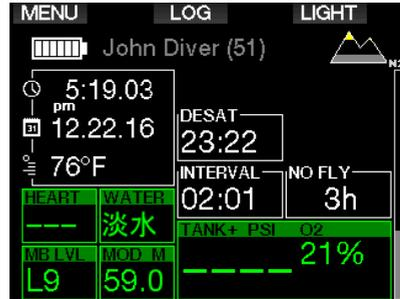
禁止的海拔高度等级在程式化的高山图标中以黄色（出厂设定颜色）部分加以显示。该部分可同灰色（出厂设定颜色）部分结合，后者标示当前海拔高度。在上图示例中，司机当前位于海拔高度1级处，不应到达海拔4级或更高处。
