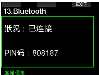
另一设备接受该PIN码后，通信连接建立，G2将显示以下屏幕。
