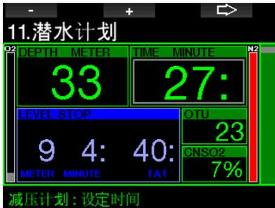
通过按下箭头按钮更改计划深度，可编辑潜水时间。起点（现在为最低）是免减压潜水时间。可以按每次1分钟的增加量增加时间。最深的减压或微气泡等级停留同样以总上升时间显示。
