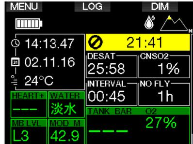
上次潜水所积累的氧气量CNS%在脱饱和和时间旁边加以显示，倒计时至零时消失。
