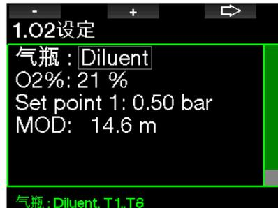
可在1.0-1.6巴之间选择设定点2。由于在水面无法达到更高的值，将为设定计算一个绝对最小深度。
