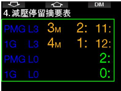
通过按下向上箭头按钮，会显示潜水概述（蓝色是已潜记录，灰色标识当前时间，绿色为预计上升概述），以及根据最大操作深度的规定气体转换深度（白线）。
