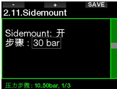
当G2侧挂气瓶启用（“ON”）时，两个气瓶的压力将同时显示。参看章节：**侧挂气瓶** 以了解更多关于此模式下的显示配置方式。
