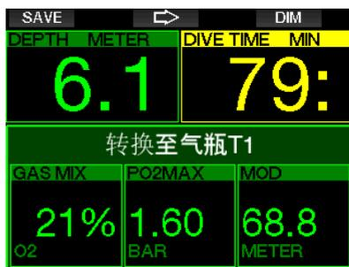
G2会显示文字“成功转换至气瓶T1”长达4秒，并采用相应的减压行程。
