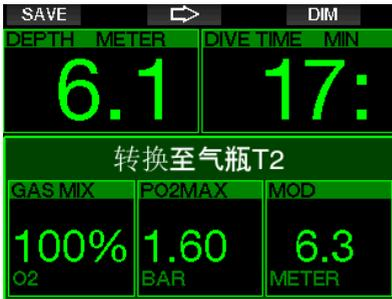
在上升时，当您到达当前使用气体以外气体对应的最大操作深度时，G2会建议您进行转换。电脑会播放一个音频序列，并且显示信息“转换至气瓶T2”。您有30秒钟的时间回应这一信息，否则G2会认定您将不会使用气体2（文字“排除气瓶T2”将显示），并对减压行程做出相应调整。
