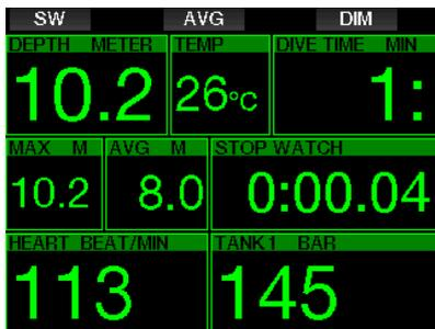
当G2设定在仪表模式时，仅会监测深度、时间及气温，不会进行减压计算。您只能在电脑完全脱饱和后才可以转为仪表模式。除以下内容外的音频和视频警告和警报将全部关闭：低电量、瓶压储备、半气瓶压力、最大深度、最大潜水时间和压力信号警报。
