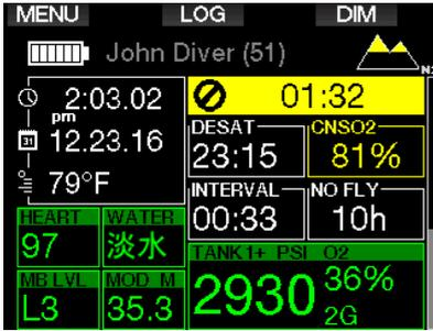
当氧分压超过0.5巴时，CNS O<sub>2</sub>时钟会加值，氧分压低于0.5巴时会减值。因此，在水面吸入空气时，您必定会减低CNS O<sub>2</sub>。潜水时不同混合气达到0.5巴时的深度如下所示：
