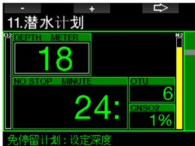
当该深度处的中毒指数达到1%时，最长免停留时间以及CNS%和OTU值将在屏幕上加以显示。
