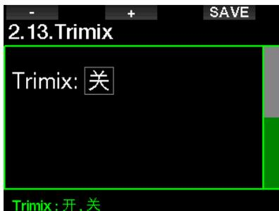
Trimix为开启时，气体含量展示将位于标准氧气/氦气之后。同时显示每种气体的绝对最小深度（AMD）。参看章节：[使用多种混合气潜水](#) 以了解更多此功能相关信息。
