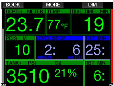
当计算的PDIS深过8米/25英尺时，G2会将其持续显示（左中部窗口），直至您上升至显示的深度。潜水时显示的数值会变更，因为G2会跟踪氮在16个部分的吸收并相应更新PDIS的深度，随时反映最佳的深度。
