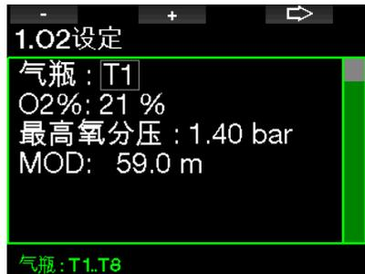
T1总是开始潜水时的默认气瓶。气瓶2至8的值与气瓶1的调整方式一致。
