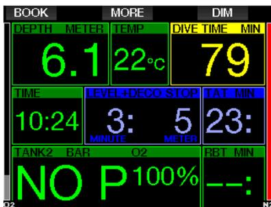
G2将显示信息转换至气瓶T1。这时按下“保存”按钮以确认转换，并可通过箭头按钮选择另一种气体。
