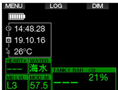
屏幕上还会显示您的G2按钮功能。作为示例，上方屏幕显示按下左侧按钮将前往主菜单，按下中间按钮将前往潜水记录，按下右侧按钮将调暗显示灯光。但是，请注意这些功能标签可能根据您当前的操作模式而有所变化。
