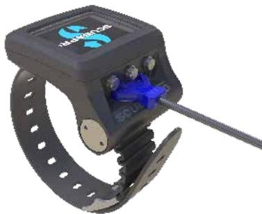
然后将电缆的另一端与USB充电器或可提供充电电能的USB设备连接。此时，下图中所示的“电池充电中”状态符号将现于G2显示屏上。
