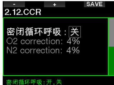
启用密闭循环呼吸器会将默认开放式气体含量设定更改为设定点设定。同时，潜水显示也将变化，同时显示氧气和稀释气瓶压力。参看章节：**密闭循环呼吸器** 以了解更多关于此模式下的显示配置方式。
