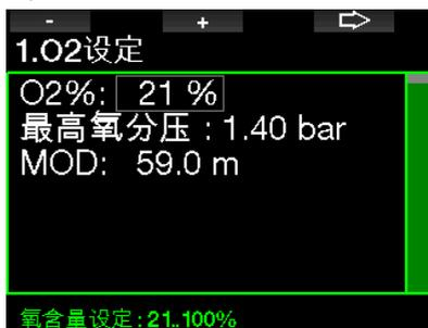
在此情况下，左侧和中间按钮的功能用“-”和“+”加以标注（方便您编辑当前选择）。按下右箭头按钮可选择下一字段，按下“SAVE”可存储输入值。位于屏幕右侧的导航条以模拟仪表形式指示当前值。
