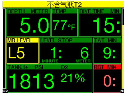
按下“保存”按钮，以确认气体转换。在您确认转换后，信息“成功转换至气瓶T2”将在屏幕上持续显示4秒。
