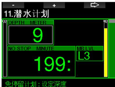
若提供了水面停留时间或您不再有剩余的脱饱和，计划表会显示以3米/10英尺为增加量的深度。并显示在该深度处的免减压潜水时间。
