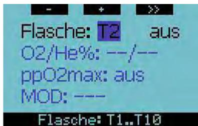
Wenn die Tanknummer hervorgehoben ist (T2..T10) können Sie mit den Knöpfen +/- zwischen den Tanks hin und her wechseln. Der Knopf >> dient zur Auswahl des aktuell zu verändernden Tanks.
