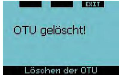
Dieser Bildschirm zeigt an, dass die OTUs zurückgesetzt worden sind. Durch Drücken von **EXIT** (verlassen) werden die OTU-Einstellungen angezeigt.
