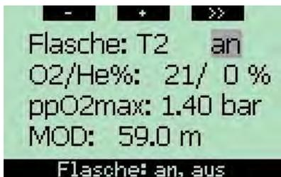
Wenn das Feld On/Off (An/Aus) hervorgehoben ist, können Sie mit den Knöpfen +/- den betreffenden Tank aktivieren und deaktivieren. Wenn On (An) eingestellt ist, wechseln die weiteren Einstellungen für dieses Gas von Grau auf Schwarz. Durch Drücken von >> kann das Gas bearbeitet werden.
