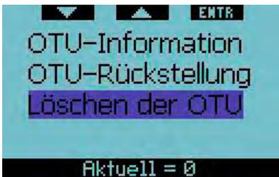
Durch Drücken von **ENTER** (Eingabe), wenn Clear OTUs (OTUs löschen) hervorgehoben ist, können Sie die OTU-Zähler manuell löschen.
