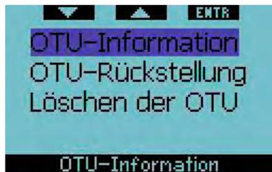
Durch Drücken von „nach oben“ oder „nach unten“ können Sie zwischen der OTU-Information, der Rückstellung der OTU-Zeit wechseln oder die OTUs löschen. Durch Drücken von **Enter** (Eingabe) auf der OTU-Information kommen Sie auf die nachfolgende Auswahl.
