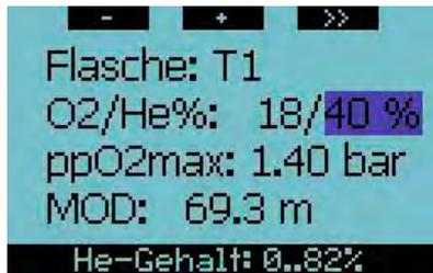
Wenn der Cursor den Heliumbereich hervorhebt, können Sie den Heliumanteil des Gemisches mit den Knöpfen +/- verändern. Der mögliche Bereich für die Heliumeinstellung wird unten auf dem Bildschirm auf schwarzem Hintergrund angezeigt. Durch Drücken von >> wählen Sie den aktuellen Wert und fahren mit der ppO<sub>2</sub>-Einstellung fort.
