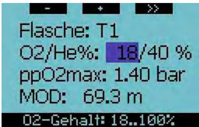
Wenn der Cursor den O<sub>2</sub>-Bereich hervorhebt, können Sie den Sauerstoff-Prozentanteil des Gemisches mit den Knöpfen +/- verändern. Der mögliche Bereich für die O<sub>2</sub>-Einstellung wird unten auf dem Bildschirm auf schwarzem Hintergrund angezeigt. Durch Drücken von >> wählen Sie den aktuellen Wert und fahren mit dem Heliumanteil fort.
