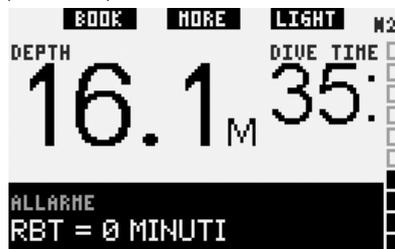
Nel formato **FULL**, il messaggio di allarme **RBT = 0 MINUTI** viene visualizzato per 12 secondi al posto dei dati di no-stop o decompressione; durante questo intervallo viene attivato anche il segnale sonoro. Inoltre, il valore dell'RBT viene visualizzato a colori invertiti (bianco su sfondo nero). Il segnale sonoro si arresta solo quando l'RBT risale a 1 minuto o oltre oppure quando il sub raggiunge una profondità pari o inferiore a 6,5m.
