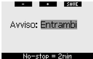
Se nel corso dell'immersione il tempo di no-stop raggiunge i 2 minuti e l'avviso è impostato su **VISIVO** o **ENTRAMBI**, Galileo visualizza per 12 secondi il messaggio **NO STOP = 2 MINUTI**. Le immagini seguenti mostrano la schermata visualizzata nei diversi formati (**CLASSIC**, **LIGHT** e **FULL**).
