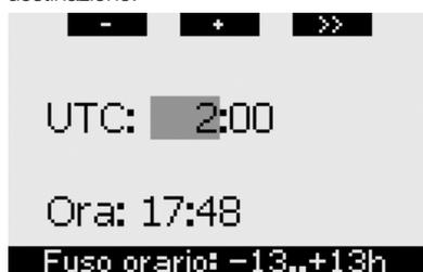
Il numero di ore utile per il cambiamento del fuso orario può variare da -13 ore a +13 ore, ad incrementi di 15 minuti.
