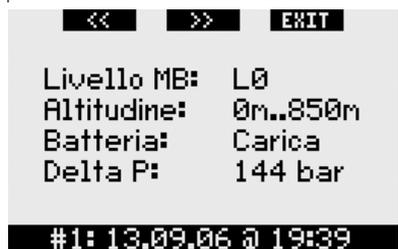
La quarta pagina visualizza il livello MB con cui l'immersione è stata iniziata e, in caso di riduzione del livello MB, il livello MB finale. Mostra inoltre la classe di altitudine, il livello minimo di carica della batteria raggiunto nel
