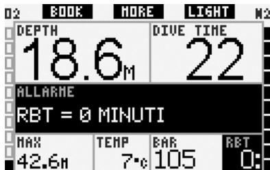
Nel formato **LIGHT**, il messaggio di allarme **RBT = 0 MINUTI** viene visualizzato per
