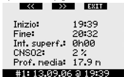
La terza pagina visualizza l'ora di inizio dell'immersione, l'ora di conclusione dell'immersione, l'intervallo di superficie precedente all'immersione, il livello di CNS O<sub>2</sub> al termine dell'immersione e la profondità media dell'immersione.
