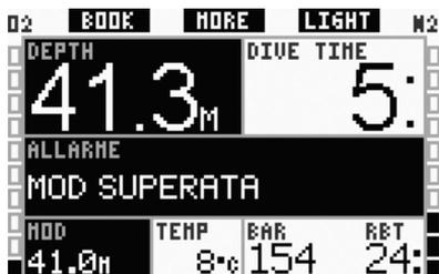
Nel formato **LIGHT**, il messaggio di allarme **MOD SUPERATA** viene visualizzato al posto dei dati di no stop per 12 secondi e poi ripetuto a intervalli di 4 secondi. Inoltre, la profondità attuale viene visualizzata a colori invertiti (bianco su sfondo nero) e resta visualizzata fino a quando il subacqueo non risale superando la MOD di almeno 1 metro. Anche il segnale sonoro persiste fino a quando il subacqueo non risale superando la MOD di almeno 1 metro.
