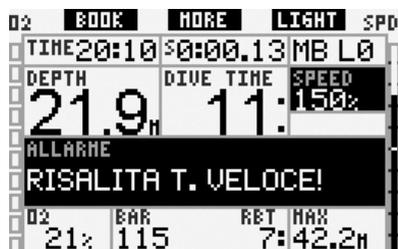
Galileo può inoltre fornire un allarme sonoro in caso di velocità di risalita superiore al 110%. L'intensità del segnale sonoro aumenta in maniera direttamente proporzionale allo scostamento dalla velocità ideale.
