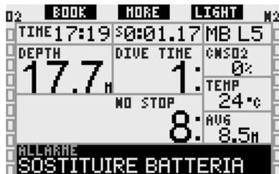
Oltre a monitorare le condizioni della propria batteria, Galileo può controllare anche la batteria della sonda Smart e avvisare il sub quando questa è scarica e necessita la sostituzione. Sulla riga centrale del display, a intervalli di 4 secondi, appare il
