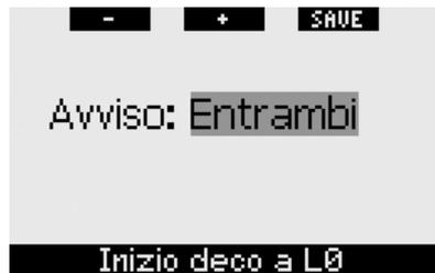
Nel corso dell'immersione, se ci si avvicina alla fase di decompressione e l'avviso è impostato su **VISIVO** o **ENTRAMBI**, Galileo visualizza per 12 secondi il messaggio **INIZIO DECO A L0**. Le immagini seguenti mostrano la schermata visualizzata nei formati **CLASSIC** e **FULL**.
