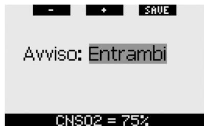
Durante l'immersione, se il valore della CNS O<sub>2</sub> calcolato raggiunge il 75% e l'avviso è impostato su **VISIVO** o **ENTRAMBI**, Galileo visualizza per 12 secondi il messaggio **CNS O<sub>2</sub> = 75%** invece dei dati di no-stop o decompressione.
