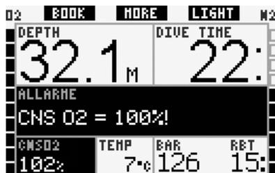
Nel formato **LIGHT**, il messaggio di allarme **CNS O<sub>2</sub> = 100%** viene visualizzato per 12 secondi al posto dei dati di no-stop; durante questo intervallo viene attivato anche il segnale sonoro. Inoltre, una volta scomparso il messaggio di testo, il valore della CNS O<sub>2</sub> viene visualizzato a colori invertiti (bianco su sfondo nero)
