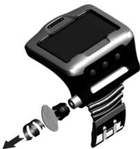
3. Ispezionare l'O-ring sul coperchio del vano batteria. In presenza di tracce di infiltrazioni di acqua, danni o difetti dell'O-ring, sostituire l'O-ring con un ricambio originale UWATEC (PN 06.202.693). L'O-ring è fornito in dotazione con il kit batteria UWATEC per Galileo (PN 06.202.872). Al momento della sostituzione, verificare che il nuovo O-ring sia in perfette condizioni e ben lubrificato e che l'O-ring stesso, la relativa sede e le superfici di tenuta siano privi di polvere e impurità.
