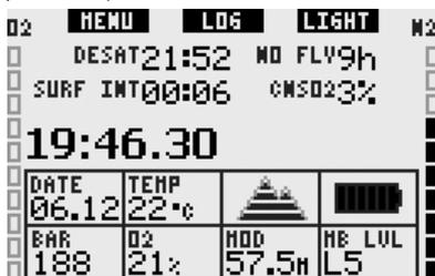
Il tempo di desaturazione (DESAT) residuo viene calcolato dal modello di
