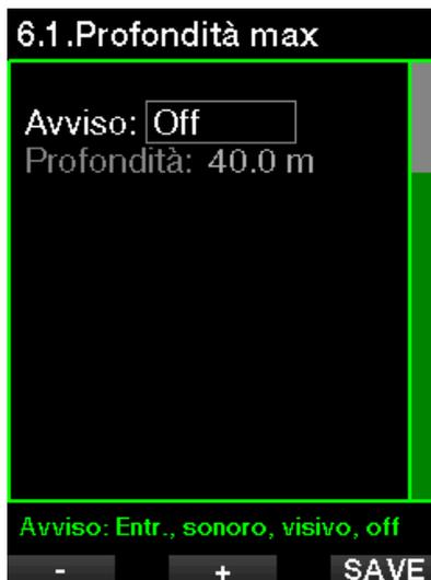
Gli avvisi possono essere disattivati selezionando OFF. La selezione di avviso visivo determina la visualizzazione dell'avviso quando si verifica la situazione correlata. La selezione di avviso sonoro determina l'emissione di un suono quando si verifica la situazione correlata. Selezionando Entrambi, si avrà una combinazione di avvisi sonori e visivi.
