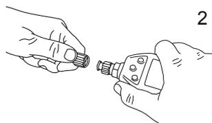
2. Allineare G2C allo sgancio rapido e verificare che i perni di blocco si allineino alle scanalature guida.
