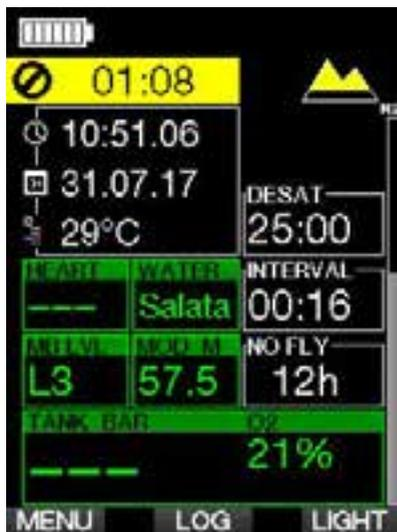
Non effettuare altre immersioni fino a quando l'avviso di non immergersi non scompare dallo schermo del computer. Se l'avviso è indotto da accumulo di microbolle (in contrapposizione a un valore di CNS O<sub>2</sub> superiore al 40%) e ci si immerge in ogni caso, si avranno limiti di non decompressione (NO STOP) più brevi o tempi di decompressione più lunghi. Inoltre, la durata dell'avviso relativo alle microbolle alla fine dell'immersione può aumentare notevolmente.
