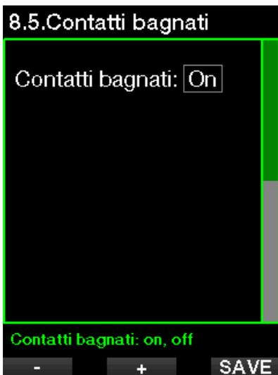
👉 **NOTA:** se la funzione contatti bagnati è disattivata e il sub dimentica di accendere manualmente il computer, questo si attiverà comunque in maniera automatica entro un minuto dall'inizio dell'immersione. In tal caso il calcolo di durata e decompressione risulterà impreciso mentre l'accuratezza della misura della profondità non verrà compromessa.
