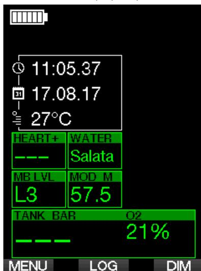
Le funzioni dei pulsanti di G2C sono disponibili a schermo. A titolo di esempio, la schermata qui sopra mostra che premendo il pulsante sinistro si passa al menu principale, premendo quello centrale si accede al logbook (LOG) e premendo quello destro si attenua (DIM) la luce del display.
