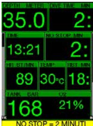
Se si desidera evitare di effettuare involontariamente un'immersione con decompressione, G2C può attivare un avviso quando il limite di non decompressione raggiunge i 2 minuti. Questo vale sia per il limite di non decompressione di livello L0 sia per le soste di livello MB (consultare il capitolo: Per maggiori informazioni in merito alle **immersioni con livello**
