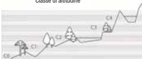
Le altitudini consentite sono indicate con il simbolo della montagna nell'angolo superiore destro della schermata dell'ora del giorno. Le altitudini proibite (che G2C ha rilevato come incompatibili con il proprio attuale livello di saturazione di azoto) sono rappresentate come segmenti pieni colorati all'interno del simbolo della montagna. Per maggiori dettagli, consultare il capitolo: **Altitudine e algoritmo di decompressione.**
