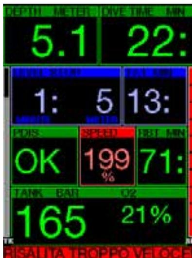
G2C attiva anche un allarme sonoro per velocità di risalita superiori al 110%: l'intensità dell'allarme aumenta in proporzione diretta al grado di superamento della velocità di risalita ideale.
