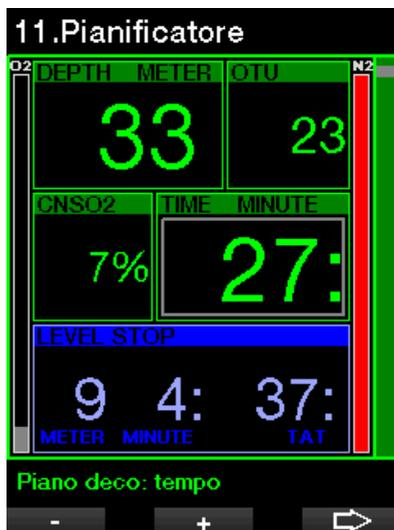
Premendo il pulsante FRECCIA per la profondità pianificata, è possibile modificare il tempo di immersione. Il punto di partenza (per ora minimo) è il limite di non decompressione. Tale tempo può essere aumentato a incrementi di 1 minuto. La sosta più profonda di decompressione o di livello MB è anche visualizzata come tempo totale di risalita.
