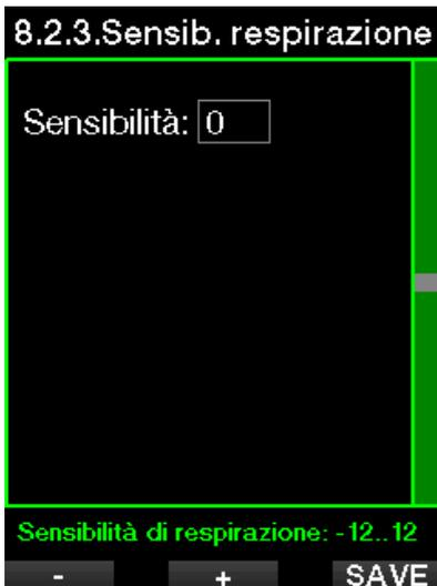
Il valore 0 corrisponde a una sensibilità di respirazione neutra. Con il valore -12 la respirazione influisce in modo minimo sul carico di lavoro nell'algoritmo di immersione.
