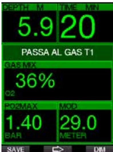
G2C visualizza il messaggio **PASSAGGIO AL GAS T1 RIUSCITO** per 4 secondi e adatta il profilo di decompressione di conseguenza.
