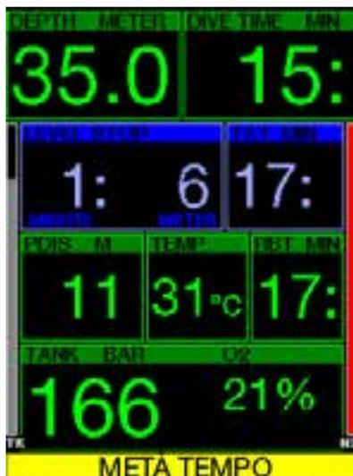
L'avviso di metà tempo di immersione (configurazione precedente 30 minuti = 15 minuti) visualizza il messaggio: **METÀ TEMPO**.
