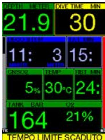
Quando si raggiunge il tempo di immersione impostato (vedere l'esempio sopra: 30 minuti) il messaggio di avviso è: **TEMPO LIMITE SCADUTO**.
