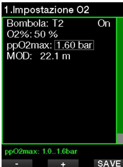
Il limite massimo di ppO<sub>2</sub> può essere modificato nel menu **2.4. ppO<sub>2</sub>max**.
