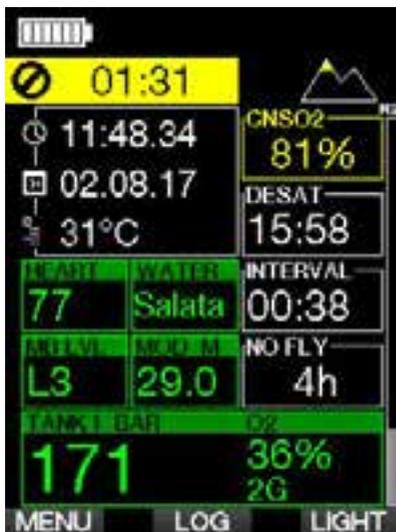
L'«orologio» CNS O<sub>2</sub> aumenta quando la pressione parziale dell'ossigeno è superiore a 0,5 bar e diminuisce quando questa è inferiore a 0,5 bar. Quindi, mentre si respira aria in superficie si ha sempre una diminuzione dell'«orologio» CNS O<sub>2</sub>. Durante l'immersione, la profondità alla quale si raggiunge la pressione parziale dell'ossigeno di 0,5 bar secondo le varie miscele è indicata di seguito.
