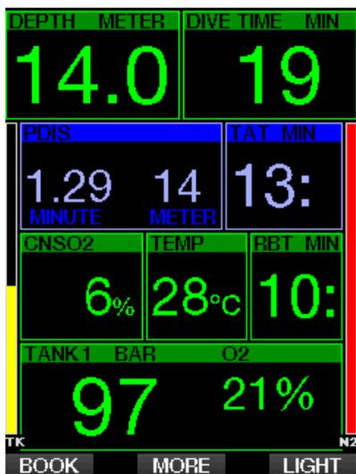
La profondità della PDIS è visibile a destra della riga centrale. Durante un'immersione in curva di sicurezza, non appena si raggiunge tale profondità durante la risalita, appare un conto alla rovescia di 2 minuti. Sono possibili tre situazioni:
