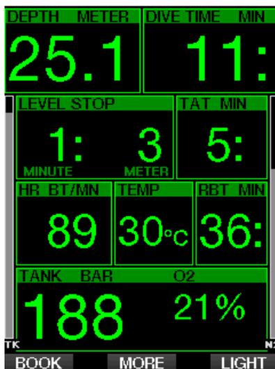
Tenendo premuto il pulsante MORE, viene visualizzata la tabella del riepilogo gas. Premendo il pulsante MORE, appaiono le soste di decompressione previste con tutti i gas attivati in uso (PMG) e presumendo che sarà utilizzato solo il gas attuale (1G). Sono indicati anche i profili di livello MB e livello MB 0 attualmente selezionati.
