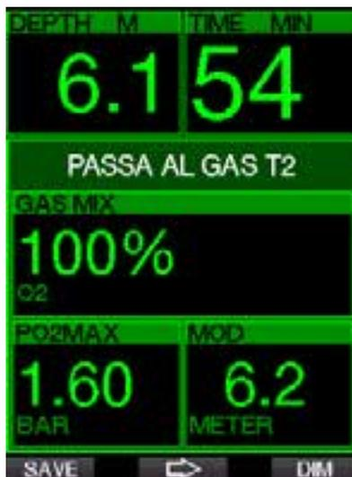
Durante la fase di risalita, quando si raggiunge una profondità corrispondente alla MOD di un gas diverso da quello attualmente in uso, G2C suggerisce l'esecuzione del cambio gas. Viene emessa una sequenza sonora e sul display appare il messaggio **PASSA AL GAS T2**. Si dispone di 30 secondi per rispondere a questo messaggio, altrimenti G2C considera il gas 2 disattivato (viene visualizzato il messaggio: **ESCLUSO GAS T2**) e adatta il profilo di decompressione di conseguenza.
