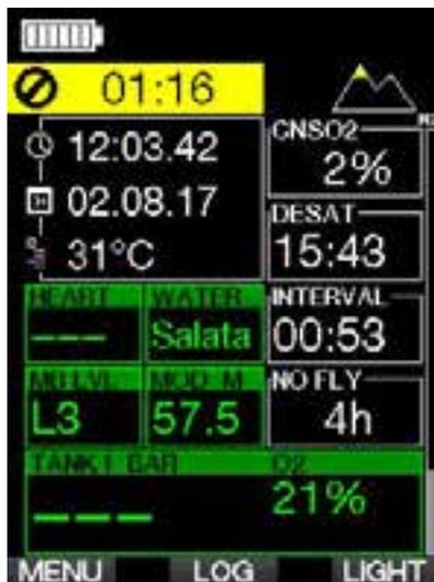
Il valore CNS% di ossigeno accumulato dall'ultima immersione si trova accanto al tempo di desaturazione ed è un conto alla rovescia che viene eliminato quando si azzerà.
