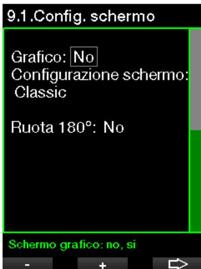
☞ **NOTA:** il formato *Light* non supporta le immersioni con stop MB o di decompressione. Se è stato scelto il formato *Light*, quando ci si avvicina alla fase di stop MB o decompressione, la configurazione schermo passa al formato *Classic* fino a quando non vengono effettuati tutti gli obblighi di stop MB e/o decompressivi.
