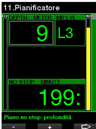
Una volta inserito l'intervallo di superficie, oppure se non è presente desaturazione residua, il pianificatore può visualizzare la profondità a incrementi di 3 m. Per quella profondità viene mostrato il limite di non decompressione.
