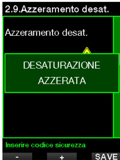
☞ **NOTA:** dopo un azzeramento della desaturazione il cambio tra le modalità scuba e profondità è immediatamente possibile. Tuttavia, poiché la modalità profondità non monitora la saturazione di azoto nei tessuti, si raccomanda di mantenere gli intervalli iniziali previsti per i cambi di modalità.
