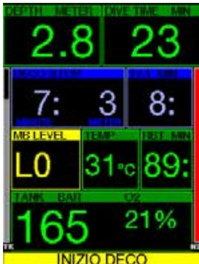
Durante le immersioni con un livello MB superiore a L0, le informazioni del livello L0 latente non sono direttamente visibili sul display (anche se rimangono accessibili come informazioni alternative). È possibile impostare G2C affinché avvisi il sub quando si avvicina a una sosta di decompressione durante un'immersione con un livello MB attivo superiore a L0.
