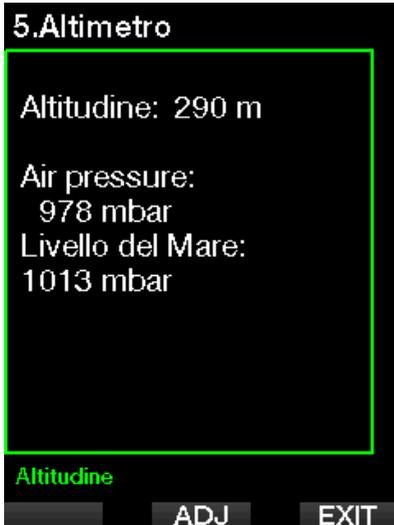
☞ **NOTA:** la pressione barometrica è variabile e si modifica in funzione delle condizioni climatiche e della pressione atmosferica ad ogni quota specifica. Gli algoritmi di immersione utilizzano classi di altitudine che sono direttamente derivate dalla pressione barometrica. L'altitudine visualizzata è determinata in base alla pressione barometrica attuale ed è, pertanto, un valore relativo.
