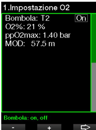
Per i gas di decompressione è possibile impostare una ppO<sub>2</sub> diversa.
