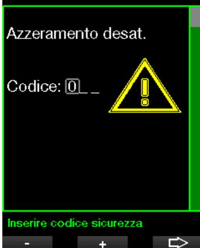
Quando il codice di sicurezza viene immesso correttamente e confermato premendo il pulsante SAVE, l'azzeramento della desaturazione è completo e viene visualizzata la seguente schermata.
