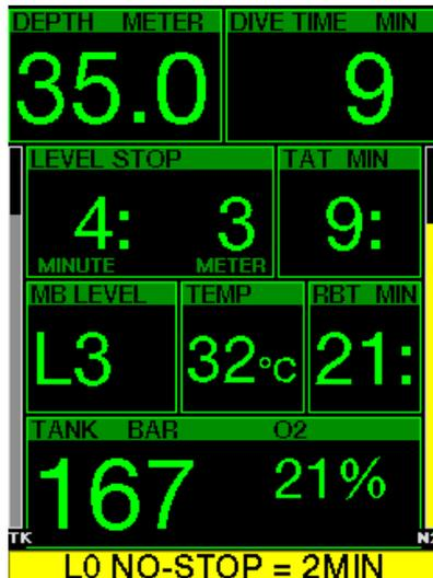
Durante le immersioni con un livello MB superiore a L0, le informazioni del livello L0 latente non sono direttamente visibili sul display (anche se rimangono accessibili come informazioni alternative). È possibile impostare G2C affinché avvisi il sub quando il tempo di no-stop L0 sottostante raggiunge i 2 minuti durante un'immersione con un livello MB attivo superiore a L0.
