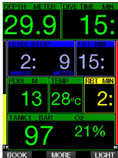
Se la sosta PDI calcolata è più profonda di 8 m, G2C la visualizza sul display (riquadro centrale sinistro) fino a quando non si raggiunge tale profondità durante la risalita. Il valore visualizzato cambia durante l'immersione poiché G2C monitora l'assorbimento di azoto nei 16 compartimenti e aggiorna di conseguenza la profondità della PDIS per riflettere sempre il valore ottimale.
