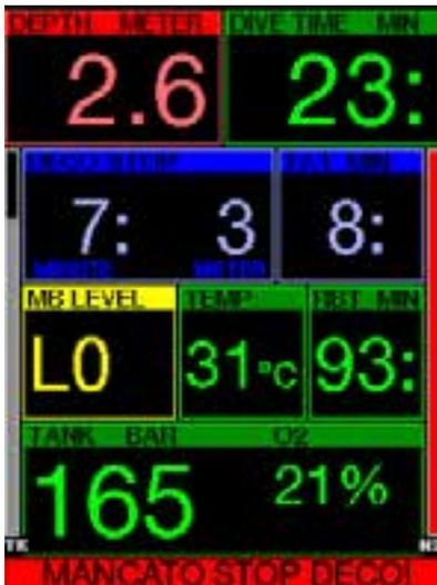
Se, durante una sosta di decompressione obbligatoria, si risale oltre 0,5 m rispetto alla profondità richiesta, G2C attiva un allarme. Viene visualizzato il valore della profondità attuale con il messaggio: **MANCATO STOP DECO!** e viene emessa una sequenza di bip. L'allarme continua per tutto il tempo in cui si rimane a 0,5 m/2 ft o più al di sopra della sosta richiesta.
