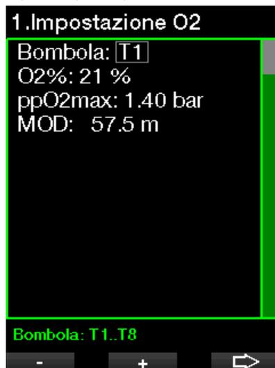
T1 è sempre il gas predefinito all'inizio dell'immersione. I valori delle bombole (TANK) da 2 a 8 possono essere regolati nello stesso modo della bombola 1.
