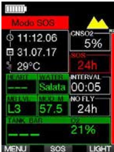
Il display visualizza le stesse informazioni mostrate nel caso della desaturazione con l'aggiunta del messaggio Modo SOS.
