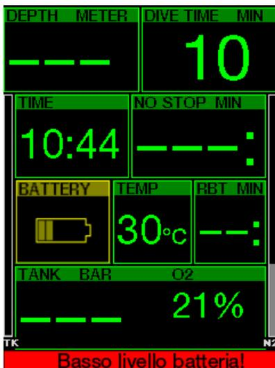
Durante l'immersione, G2C segnala la situazione precaria della batteria nei due modi illustrati di seguito.
