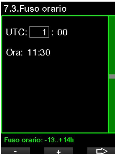
Il numero di ore utile per il cambiamento del fuso orario può variare da -13 ore a +14 ore, a incrementi di 15 minuti.
