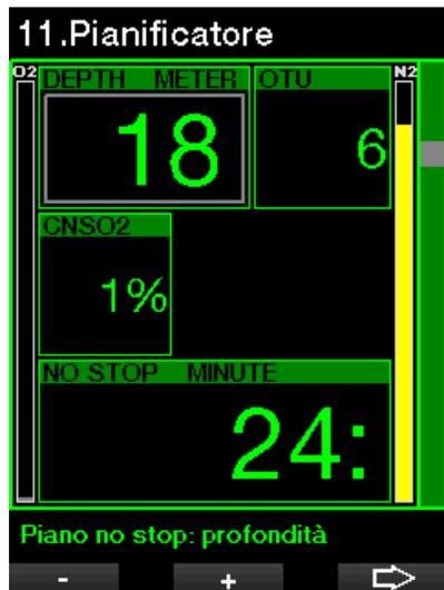
Quando viene raggiunto l'1% per detta profondità, compaiono i valori CNS% e OTU con il limite di non decompressione.
