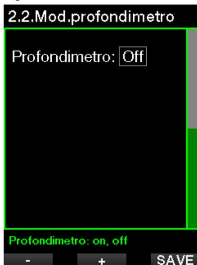
☞ **NOTA:** poiché la modalità profondimetro non monitora la saturazione dei tessuti, deve trascorrere un intervallo di 48 ore tra l'ultima immersione in modalità profondimetro e il passaggio alla modalità scuba. Al contrario, il G2C mostrato sotto è stato usato per un'immersione in modalità scuba e non può passare alla modalità profondimetro finché non è trascorso il tempo di desaturazione.
