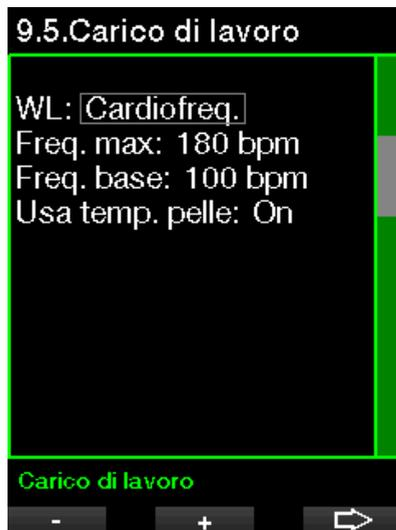
G2C stima il carico di lavoro in base alla frequenza cardiaca (Cardiofreq.) o alle variazioni del modello respiratorio rilevate dal sensore di alta pressione e il calcolo della decompressione nel modello ZH-L16 ADT viene modificato di conseguenza. Questo menu consente di selezionare il criterio di stima del carico di lavoro o di disattivare questa funzione, nel qual caso G2C si comporta come i modelli di computer subacquei SCUBAPRO senza cardiofrequenzimetro o sonda integrata.
