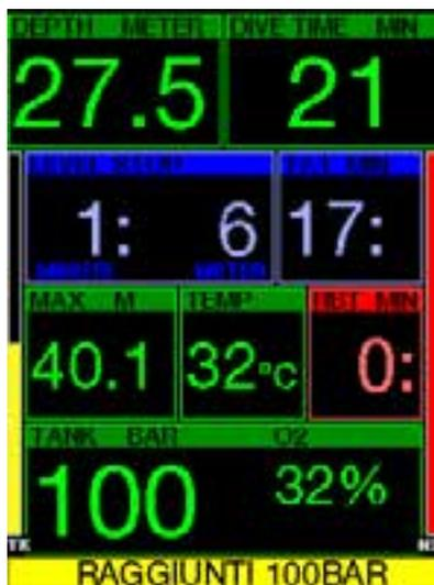
È possibile impostare G2C affinché avvisi il subacqueo quando la pressione della bombola raggiunge un determinato livello. Ad esempio, è possibile far sì che l'avviso segnali il superamento della metà della
