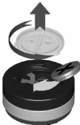
Procedura di sostituzione della batteria
