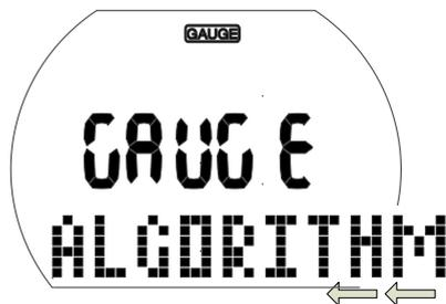
1. Dalla schermata di immersione tenere premuto il pulsante destro (appare il menu "GAS"). Premere il pulsante destro 4 volte per visualizzare il menu "ALGORITHM" (algoritmo) (se Aladin Sport indica "OFF" la modalità Profondimetro non può essere attivata o disattivata senza un azzeramento della desaturazione. Aladin Sport visualizza l'indicazione "OFF" per 48 ore dopo un'immersione in modalità
