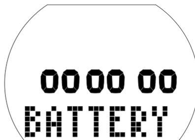
Dalla schermata dell'ora del giorno è possibile controllare la condizione della batteria premendo il pulsante sinistro o destro per scorrere fino al menu dell'orologio. Con una pressione prolungata del pulsante destro si accede alle impostazioni dell'orologio, quindi, premendo il pulsante destro 6 volte si scorre fino alla schermata del livello della batteria, che mostra la carica residua della batteria CR2450. Una batteria nuova è indicata da 6 zeri.
