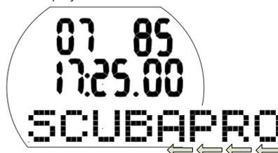
**HINWEIS:** Auf der unteren Matrixzeile auf dem Display werden längere Wörter gescrollt. In diesem Bedienungshandbuch wird dieses Scrollen durch einen nach links weisenden Pfeil, der unten am Display entlang läuft, angezeigt.
