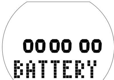
In diesem Menü wird der Batteriestand angezeigt. Eine frische Batterie wird durch 6 Nullen angezeigt, während eine gebrauchte Batterie durch weniger Nullen dargestellt wird, siehe unten:
