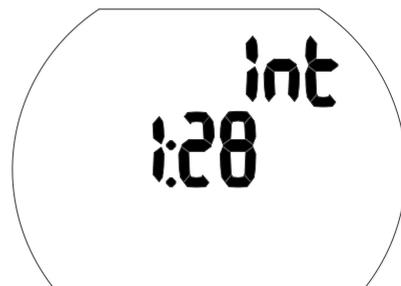
Vom Tageszeitdisplay aus können Sie die Oberflächen-Intervallzeit durch Drücken und Halten des rechten Knopfs (direkt zum Tauchmenü) und durch ein weiteres Drücken und Halten (zum Oberflächenintervall) gelangen.
