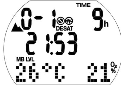
Auf dem Tageszeitdisplay können Sie die Entsättigungszeit\* durch Drücken und Halten des rechten Knopfs einsehen. Die Entsättigungszeit wird entweder durch die Sauerstofftoxizität, die Stickstoffsättigung oder die Rückbildung der Mikroblasen bestimmt, je nach dem, welcher Aspekt länger dauert.
