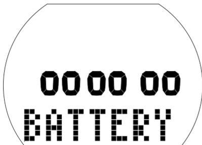
Vom Tageszeitdisplay können Sie den Batteriestand durch Drücken des rechten oder linken Knopfs zum Durchblättern des Uhrmenüs einsehen. Durch Drücken und Halten des rechten Knopfs geben Sie die Uhreinstellungen ein und drücken dann 6x auf den rechten Knopf, um zum Batteriestand-Display zu gelangen.
