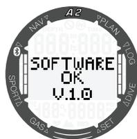
Tras finalizar la actualización, A2 mostrará el mensaje "Software OK". Este mensaje se puede borrar pulsando brevemente el botón SEL/ESC. Una vez finalizado este proceso, A2 volverá a estar listo para el uso normal.
