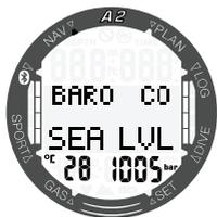
Pulsando los botones +/UP o -/DOWN puede cambiar a otra pantalla en la que se muestra la presión atmosférica al nivel del mar.
