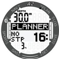
NOTA: La profundidad mínima para la planificación de la inmersión es de 9 m/30 ft. El planificador solo permite profundidades en línea con la  $ppO_2$  máxima. Los ajustes del contenido de oxígeno y la  $ppO_2$  máxima se indican en el menú **GAS**.
