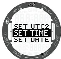
Desde el menú **Watch** (Reloj) navegue hasta **Set time** (Ajuste hora) y pulse SEL/ESC.
