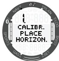
**2. Rotar horizontalmente.** Gire el A2 al menos 180° horizontalmente. Pulse el botón SEL/ESC.
