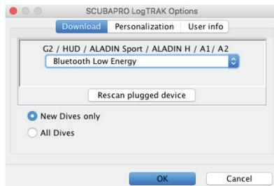
**NOTA:** A2 tiene un tiempo de espera de inactividad de 5 minutos para las conexiones Bluetooth. Después de este intervalo, A2 deshabilitará el Bluetooth y regresará al modo de hora y fecha.
