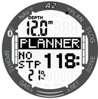
El valor del % del SNC sustituye a la mezcla gaseosa en la parte inferior izquierda de la pantalla en el momento en que se alcanzaría el 1 % de esa profundidad con el tiempo máximo sin paradas.
