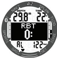
En el caso de una situación de "pérdida de señal", toda la información relacionada con la presión de la botella del A2 dejará de ser válida. De suceder esto, debe utilizar un instrumento de refuerzo para supervisar la presión y realizar un ascenso seguro a la superficie. Quedarse sin gas bajo el agua es peligroso y puede conllevar lesiones graves o la muerte por ahogamiento.
