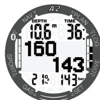
Cuando se alcanza la diferencia seleccionada de presión entre ambas botellas (en la situación por debajo de 20 bar), el A2 propone cambiar a la botella que tiene mayor presión.
