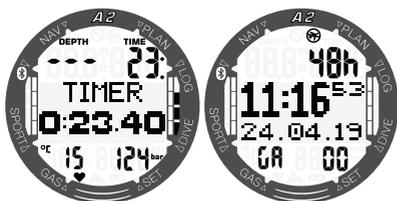
Durante una inmersión en el modo GAUGE, A2 muestra la profundidad y el tiempo de inmersión en la fila superior, un temporizador en el centro y la temperatura del agua en la fila inferior. El temporizador se puede pausar y reiniciar manteniendo pulsado el botón +/UP. Cuando se pause el cronómetro, se puede poner a cero manteniendo pulsado el botón -/DOWN. Puede navegar por las pantallas alternativas del centro pulsando los botones +/UP o -/DOWN.
