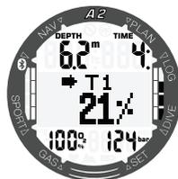
El A2 mostrará el mensaje **-> T1** y su concentración de O<sub>2</sub>. Pulse el botón SEL/ESC para confirmar el cambio o pulse +/UP para seleccionar una mezcla gaseosa diferente.
