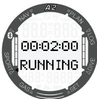
Para detener el tiempo en el cronómetro, vuelva a pulsar el botón +/UP. Para restablecer el tiempo a 0, mantenga pulsado el botón +/UP mientras la pantalla del cronómetro muestra el estado STOPPED.
