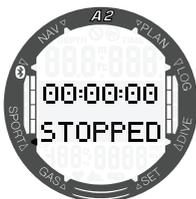
Además del tiempo, las vueltas se pueden marcar pulsando el botón -/DOWN mientras el cronómetro esté contando. Al hacer esto, en la parte inferior de la pantalla se mostrará el número de la vuelta, mientras que en la parte superior de la pantalla se mostrará el tiempo de la vuelta. Cuando se detenga el cronómetro, podrá revisar los tiempos de las vueltas desde la memoria pulsando repetidamente el botón -/DOWN.
