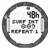
La pantalla de superficie del modo GAUGE tras una inmersión muestra el tiempo de inmersión en la fila superior. En la fila central, el cronómetro corre desde el inicio de la inmersión o desde el último reinicio manual. En la fila inferior, se muestra la temperatura del agua. Tras un tiempo de espera de 5 minutos, la pantalla cambia al menú del modo GAUGE.
