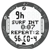
El reloj de  $O_2$  del SNC aumenta cuando la presión parcial de oxígeno es superior a 0,5 bar y disminuye cuando la presión parcial de oxígeno es inferior a 0,5 bar. Por tanto, mientras esté respirando aire en la superficie, el reloj de  $O_2$  del SNC disminuirá siempre. Durante la inmersión, la profundidad a la que se alcanzan los 0,5 bar con distintas mezclas es la siguiente:
