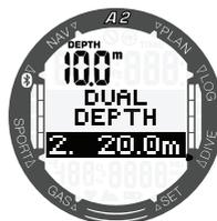
El valor de la segunda alarma se puede definir del mismo modo que el de la primera. En la sección superior izquierda de la pantalla se muestra la profundidad de la primera alarma.
