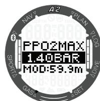
El punto de ajuste de fondo (SP2) tiene un intervalo de  $ppO_2$  entre 1,0 y 1,4 bar y se suele activar de camino al fondo o cuando se alcance la profundidad de fondo. El punto de ajuste 2 (SP2) está dedicado a la botella de oxígeno y el procedimiento de ajuste es igual al del punto de ajuste 1 (SP1).
