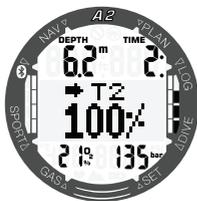
Para confirmar el cambio de gas, pulse el botón SEL/ESC. Tras confirmar el cambio, el mensaje **SWITCH TO T2** permanecerá en la pantalla durante 5 segundos.
