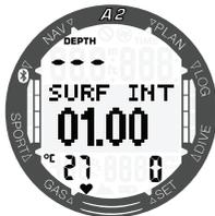
No obstante, después de una inmersión la pantalla de superficie muestra la última profundidad máxima, el intervalo de superficie, la temperatura del agua y el número de inmersiones repetitivas durante la sesión de APNEA.
