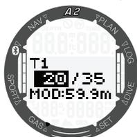
Pulsando el botón SEL/ESC en esta pantalla, se puede fijar la concentración de oxígeno de la botella diluyente en un rango que va del 21% al 40%:
