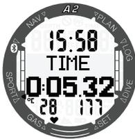
Die Informationen auf der mittleren Zeile können durch Drücken der Tasten +/UP oder -/DOWN durchgeblättert werden. Einmaliges Drücken der Taste +/UP wechselt die Daten der oberen Zeile in der folgenden Reihenfolge:
