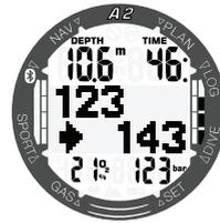
Bestätigen Sie den Tankwechsel durch Drücken der Taste SEL/ESC.
