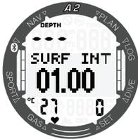
Nach einem Tauchgang zeigt das Oberflächendisplay jedoch die letzte maximale Tiefe, das Oberflächenintervall und die Anzahl der Wiederholungstauchgänge dieser APNOE-Trainingseinheit.
