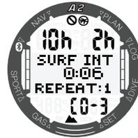
Durch einen weiteren Druck der Taste -/DOWN werden die Nullzeit (10 h), die Flugverbotszeit (2 h) und die verbleibende Entsättigungszeit angezeigt (13:50).
