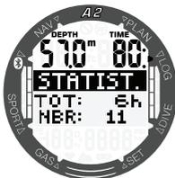
Durch Drücken der Taste SEL/ESC öffnen Sie das Archiv der Logs. Sie können mit den Tasten +/UP oder -/DOWN durch Ihre Tauchgänge blättern. Das Display unten zeigt folgende Daten: Tauchgangsnummer, Tauchmodus, Startzeit und Datum des Tauchgangs.
