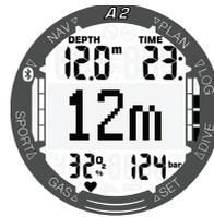
Die aktuelle Tiefe wird in Fuß oder ganzen Metern ohne Dezimalstelle angezeigt. Das ist die großformatige Wiederholung der auf der ersten Zeile angezeigten Tiefe.
