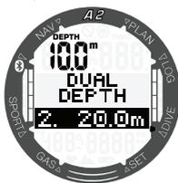
Der Wert des zweiten Alarms kann auf dieselbe Art eingerichtet werden, wie der erste Alarm. Oben links auf dem Display wird die Tiefe des ersten Alarms angezeigt.
