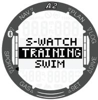
Auf der mittleren Zeile läuft die Zeit. Der Zähler kann gestoppt und neu gestartet werden, indem Sie die Taste +/UP drücken und halten. Die aktuelle Zeit wird oben auf dem Display angezeigt, der Stopp-Timer in der Mitte, die Temperatur unten links und der Puls unten rechts.
