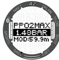
Der Tiefen-Setpoint (SP2) hat einen Einstellbereich von 1 bis 1,4 bar  $ppO_2$ . Normalerweise wird er während des Abtauchens oder bei Erreichen der tiefsten Tiefe aktiviert. SP2 ist für den Sauerstofftank und die Einstellung erfolgt gleich wie für SP1.
