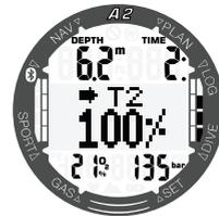
Um den Gaswechsel zu bestätigen, drücken Sie die Taste SEL/ESC. Nachdem Sie den Wechsel bestätigt haben, erscheint die Nachricht **SWITCH TO T2** 5 Sekunden lang im Display.
