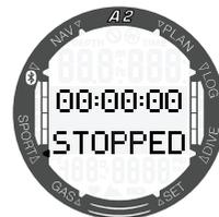
Zusätzlich können durch Drücken von -/DOWN Intervallzeiten festgehalten werden, während die Stoppuhr läuft. Im unteren Teil des Displays wird die Anzahl der Intervalle angezeigt, während die Intervallzeit im oberen Bereich des Displays angezeigt wird. Wenn die Stoppuhr gestoppt ist, können Sie Ihre Intervallzeiten durch wiederholtes Drücken von -/DOWN aus dem Speicher abrufen.
