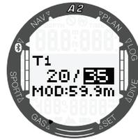
Durch Drücken der Taste SEL/ESC wird der Tankinhalt bestätigt und der  $ppO_2$ -Setpoint zu Tauchbeginn (SP1) wird hervorgehoben. Durch Drücken von +/UP oder -/DOWN können Sie von 0,3 bar bis zu 0,95 bar durch die Werte blättern. Durch Drücken von SEL werden diese Werte bestätigt.
