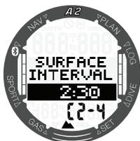
Der verbotene Höhenbereich wird nach der aktuellen Höhe auf der unteren Zeile angezeigt. Für weitere Informationen über das Tauchen in der Höhe mit dem A2 siehe Kapitel: **4.9 Tauchen in Höhenlagen**. Sollte der A2 eine Tauchverbotswarnung anzeigen, wird die verbleibende Dauer des Verbots als empfohlenes Oberflächenintervall angezeigt (aufgerundet auf die nächsten fünfzehn Minuten).
