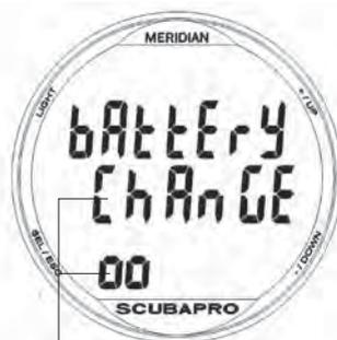
Sostituire la batteria prima dell'immersione successiva.
