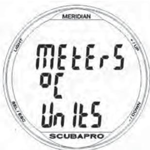
Premendo il pulsante SEL/ESC in questo menu, il formato del valore nel campo delle unità di misura comincia a lampeggiare. Premendo i pulsanti +/UP o -/DOWN, è possibile modificarlo in metri o piedi. Premendo il pulsante SEL/ESC, il valore della temperatura comincia a lampeggiare. Premendo nuovamente +/- è possibile modificarlo. Premendo il pulsante SEL/ESC, entrambe le impostazioni delle unità di misura vengono confermate.
