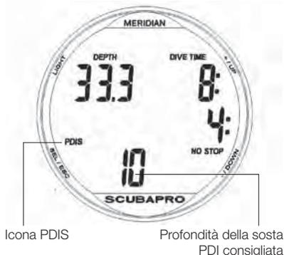
Quando si risale alla quota della sosta PDI e in assenza di soste di decompressione, nella riga centrale vengono mostrati un segnale di sosta, un conto alla rovescia da 2 minuti a 0 e l'icona lampeggiante PDIS.
