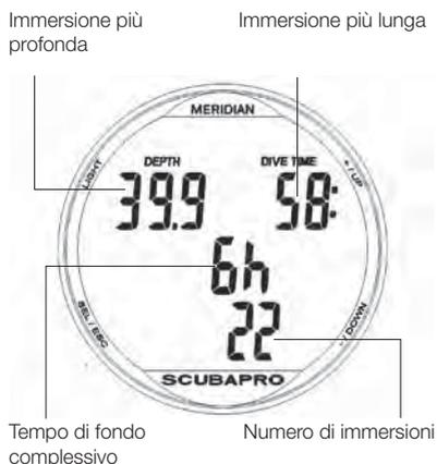
Nella cronologia delle immersioni raffigurata sopra, l'immersione più profonda è di 39,9 metri e il tempo di immersione più lungo è di 58 minuti. In totale, con questo Meridian, sono state trascorse 6 ore in immersione e sono state memorizzate 22 immersioni.
