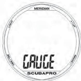
Quando Meridian è impostato in modalità GAUGE, controlla solo profondità, tempo e temperatura. Non effettua alcun calcolo di decompressione. Si può passare alla modalità GAUGE solo se il computer è completamente desaturato. Tutte le avvertenze e gli allarmi sonori e visivi, ad eccezione di quello di batteria scarica, sono disattivati.
