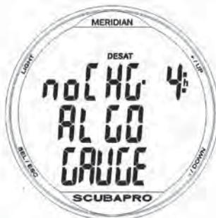
Dopo l'ultima immersione SCUBA, il passaggio alla modalità GAUGE o APNEA è possibile solo dopo che sia trascorso il tempo di desaturazione.
