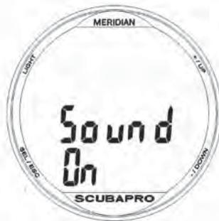
Premendo il pulsante SEL/ESC, l'impostazione 'On' comincia a lampeggiare nella parte inferiore del display. Premendo pulsanti +/UP o -/DOWN, è possibile selezionare 'On' oppure 'Off' per attivare/disattivare la modalità silenziosa di Meridian in relazione ai toni dei pulsanti e degli allarmi. La selezione 'Off' del suono è protetta da un codice.
