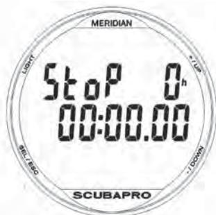
La prima schermata del cronometro mostra lo stato attuale con le alternative possibili: arresto (stop), in funzione (run) e tempo parziale (lap). Quando si attiva il cronometro per la prima volta il display apparirà come indicato sopra.
