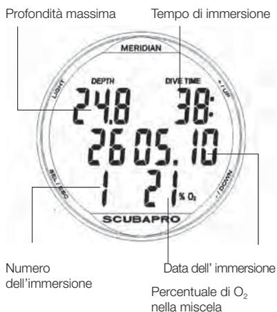
Se l'immersione è stata effettuata in modalità GAUGE (profondimetro) o APNEA, la pagina principale visualizza sulla riga inferiore GA o AP, invece di O<sub>2</sub>%.
