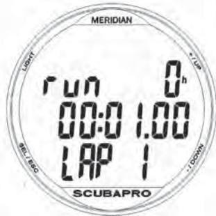
Premendo il pulsante +/UP, il cronometro inizia il conteggio mostrando la dicitura "run". Per arrestarlo, premere nuovamente il pulsante +/UP. Il tempo trascorso rimarrà sul display. Il cronometro si azzerà quando si tiene premuto il pulsante +/UP.
