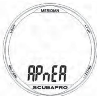
Meridian è dotato di una sofisticata modalità APNEA. Le caratteristiche principali includono intervalli di rilevamento più brevi rispetto alla normale modalità SCUBA e funzioni di allarme specifiche per le immersioni in APNEA.
