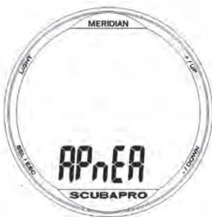
Meridian tiene un modo avanzado de inmersión en APNEA. Las principales funciones comprenden una frecuencia de muestreo más rápida que en el modo SCUBA normal y alarmas personalizadas para la inmersión en APNEA.
