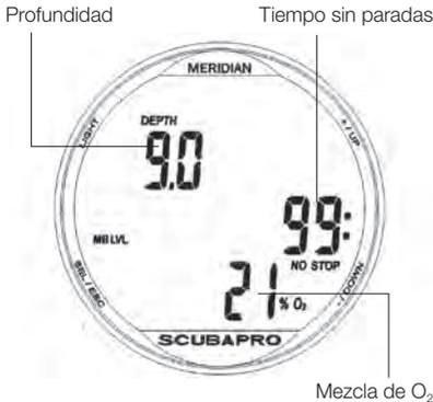
Al proporcionar el intervalo de superficie o si no queda desaturación, la profundidad comenzará a parpadear en el planificador. Pulsando + o -, puede ajustar la profundidad en incrementos de 3 m.
