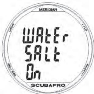
Pulsando el botón SEL/ESC en este menú, el campo on/off de la fila inferior comienza a parpadear. Puede desplazarse entre estos dos ajustes y confirmar pulsando el botón SEL/ESC.
