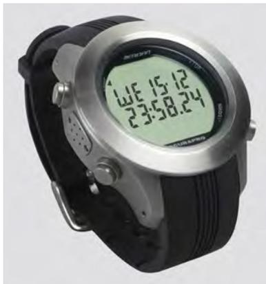
Estos botones le permiten utilizar funciones, acceder a menú y cambiar parámetros en la superficie. Durante la inmersión, los botones sirven para crear marcadores, visualizar datos distintos a los que aparecen en la pantalla del ordenador y activar la retroiluminación.
