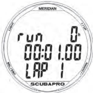
Pulse el botón +/UP y el cronómetro comenzará a contar mostrando: run. Pulse de nuevo el botón +/UP para detener la cuenta. El tiempo contabilizado permanecerá en la pantalla. El cronómetro restablecerá el tiempo contabilizado cuando mantenga pulsado el botón +/UP.
