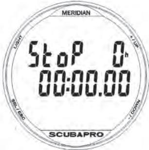
En la primera pantalla del cronómetro, se muestra el estado, que puede ser detenido, en funcionamiento o vuelta. Cuando active el cronómetro por primera vez, la pantalla será como la que se muestra arriba.
