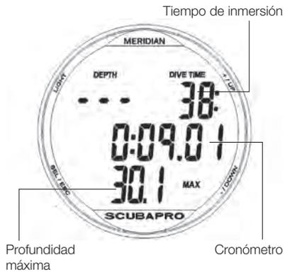
Durante una inmersión en modo GAUGE, Meridian muestra un cronómetro en la fila central. El cronómetro se puede poner a cero y reiniciar **pulsando el botón +/UP**.
