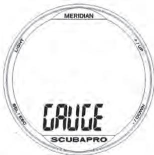
Cuando Meridian está configurado en modo GAUGE, sólo monitoriza la profundidad, la hora y la temperatura, y no realiza ningún cálculo de descompresión. Sólo podrá cambiar a modo GAUGE si el ordenador de buceo está completamente desaturado. También se desactivarán todas las advertencias y alarmas sonoras y visuales, a excepción de la alarma de batería baja.
