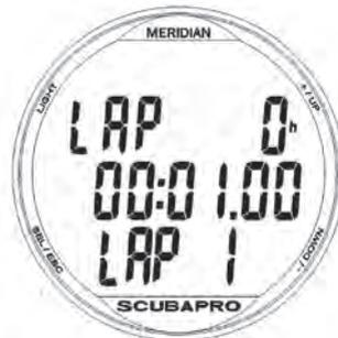
La contabilización proseguirá automáticamente y el contador de vueltas mostrará el número de vueltas en la parte inferior de la pantalla.
