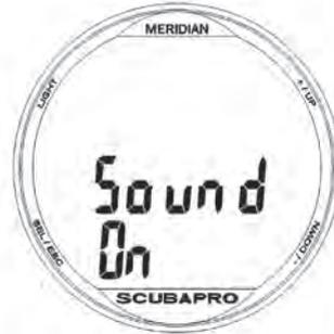
Pulsando el botón SEL/ESC, el ajuste 'on' comenzará a parpadear en la parte inferior de la pantalla. Pulsando los botones +/UP o -/DOWN, podrá seleccionar 'on' (activado) u 'off' (desactivado) para el modo silencioso de las alarmas y tonos de los botones de Meridian. La selección del sonido desactivado está protegida con un código.
