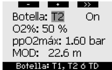
Cuando aparezca en pantalla el mensaje **BOTELLA**, utilice los botones - y + para escoger la botella para la que desea ajustar la concentración de oxígeno. **Pulse >>** para escoger **ON** u **OFF**, y utilice los botones - y + para cambiar de uno a otro. **Pulse >>** de nuevo para bajar una línea, hasta la concentración de oxígeno. Luego de ajustar la concentración de oxígeno, **si pulsa >>** se moverá una línea abajo
