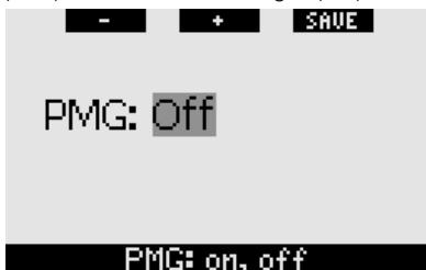
Lorsque **PMG** est sur **OFF**, Galileo se comporte exactement comme la version monogaz. Lorsque **PMG** est sur **ON**, Galileo changera de plusieurs façons :
