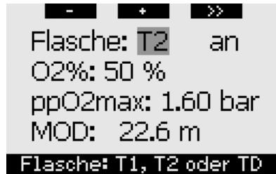
Markieren Sie **FLASCHE** und nutzen Sie die Knöpfe - und +, um den Tank auszuwählen, für den Sie die Sauerstoffkonzentration einstellen möchten. **Drücken Sie >>**, um **AN** oder **AUS** zu markieren und nutzen Sie die Knöpfe - und +, um zwischen beiden Optionen zu wechseln. **Drücken Sie >>** noch einmal, um zur nächsten Zeile, der Sauerstoffkonzentration, nach unten zu wechseln. **Drücken Sie nach**
