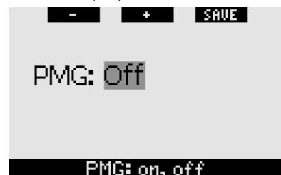
Quando il menu **PMG** è disattivato (**OFF**), Galileo si comporta esattamente come un computer a miscela singola. Quando il menu **PMG** è attivato (**ON**), l'aspetto di Galileo subisce alcune modifiche:
