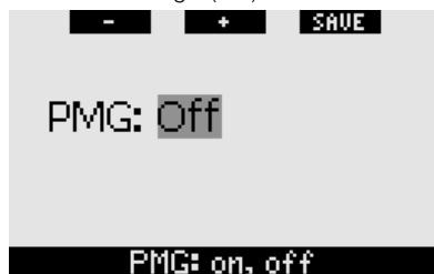
Cuando el **PMG** está **Apagado (OFF)**, Galileo se comporta de la misma manera que la versión para un solo gas. Cuando el **PMG** está **Encendido (ON)**, Galileo cambiará en varios aspectos:
