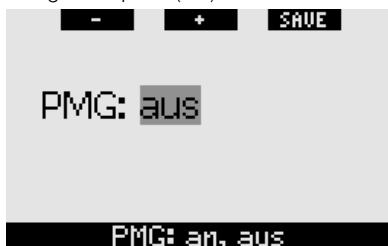
Wenn **PMG AUS** ist, funktioniert Galileo genauso wie die Eingas-Version. Wenn **PMG AN** ist, ändert sich die Funktionsweise von Galileo in folgenden Aspekten:
