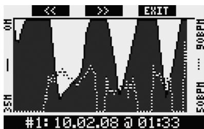
**Premendo >>**, si visualizza il profilo della profondità insieme al profilo della temperatura. Se il cardiofrequenzimetro era attivato (**ON**) durante l'immersione, **premendo >>** si richiama il profilo della profondità insieme al profilo della frequenza cardiaca\*.
