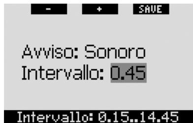
Analogamente al precedente, questo avviso consente il monitoraggio del tempo trascorso in superficie. L'avviso può essere impostato in incrementi di 15 secondi fino a un massimo di 14 minuti e 45 secondi. Allo scadere di ogni intervallo impostato, Galileo attiva una sequenza sonora di 3 secondi di durata, composta da tre brevi bip.
