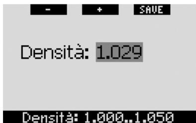
Esiste una relazione diretta tra il peso di una colonna d'acqua e la pressione che essa esercita; inoltre il peso è definito dalla profondità moltiplicata per la densità dell'acqua. Pertanto, la profondità visualizzata dai computer subacquei si ottiene mediante la misurazione della pressione assoluta.
