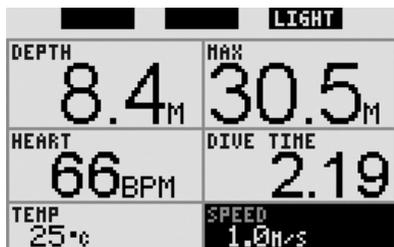
La velocità di risalita durante le immersioni in apnea viene calcolata come media su un intervallo di 4 secondi e può essere visualizzata in m/s o ft/s. Il relativo allarme può essere impostato tra 0,1 e 5,0m/s, a incrementi di 0,1m/s. Se durante la risalita la velocità supera il valore impostato, si attiva una sequenza sonora continua e la velocità viene visualizzata a colori invertiti (bianco su sfondo nero).
