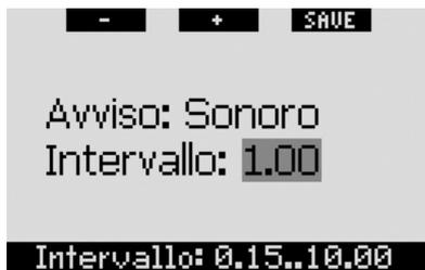
Galileo permette di impostare un avviso relativo all'intervallo del tempo di immersione, che consente il monitoraggio del tempo trascorso sott'acqua, senza dover consultare il display. L'avviso può essere impostato in incrementi di 15 secondi fino a un massimo di 10 minuti. Allo scadere di ogni intervallo impostato, Galileo attiva una sequenza sonora di 3 secondi di durata, composta da tre brevi bip.
