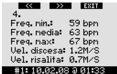
**Premendo >>** un'altra volta, si visualizzano le informazioni dettagliate relative a ogni singola immersione: il numero sequenziale che identifica l'immersione; la frequenza cardiaca\* minima, media e massima; la massima velocità di discesa e la massima velocità di risalita.
