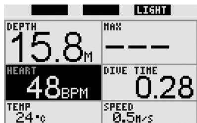
Galileo prevede l'attivazione di un allarme in caso di calo della frequenza cardiaca\* oltre un determinato livello. Questo allarme può essere impostato tra 35 e 100 bpm, in incrementi di 1 bpm. Se la frequenza cardiaca\* del sub raggiunge il livello selezionato nell'impostazione dell'allarme, si attiva una sequenza continua di bip e la frequenza cardiaca\* viene visualizzata a colori invertiti (bianco su sfondo nero).
