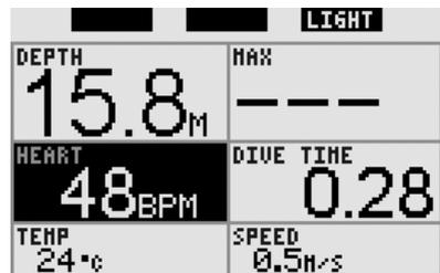
Galileo kann einen Alarm ausgeben, wenn Ihre Pulsfrequenz\* unter einen eingestellten Wert fällt. Der Alarm kann zwischen 35 und 100 bpm in Schritten von einem bpm eingestellt werden. Wenn Ihre Pulsfrequenz\* auf den im Alarm eingestellten Wert fällt, wird eine kontinuierliche Pieptonsequenz ausgegeben und die Pulsfrequenz\* wird in
