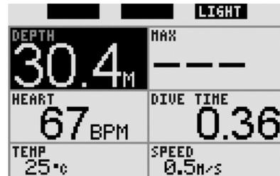
Der Alarm Maximaltiefe kann in Schritten von 1 m zwischen 5 m und 300 m eingestellt werden. Wenn der Taucher tiefer als die eingestellte Tiefe abtaucht, erklingt ein kontinuierlicher Piepton und die aktuelle Tiefe wird in umgekehrten Farben (weiß auf schwarzem Hintergrund) angezeigt. Der Alarm hält an, bis der Taucher mindestens 0,5 m über die eingestellte Tiefe steigt.
