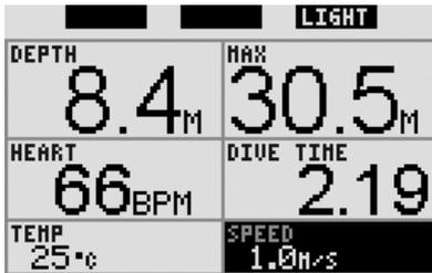
Als Aufstiegsgeschwindigkeit wird beim Apnoetauchen ein Durchschnittswert aus 4 Sekunden ermittelt und in m/sek. angezeigt. Der Alarm Aufstiegsgeschwindigkeit kann zwischen 0,1 und 5,0 m/sek. in Schritten von 0,1 m eingestellt werden. Wenn die Geschwindigkeit bei einem Aufstieg höher ist als der eingestellte Wert, wird eine kontinuierliche akustische Sequenz ausgegeben und die Geschwindigkeit wird in umgekehrten Farben am Display dargestellt (weiß auf schwarzem Hintergrund).
