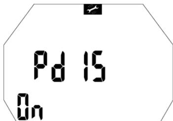
Cuando la parada PDI calculada es más profunda que 8 m, Aladin TEC 3G la muestra en la pantalla y sigue haciéndolo hasta que se alcance la profundidad mostrada durante el ascenso. El valor mostrado cambia durante la inmersión mientras Aladin TEC 3G monitoriza el consumo de nitrógeno en los 8 compartimentos y actualiza la profundidad de la PDIS en consecuencia para reflejar los valores óptimos en todo momento.
