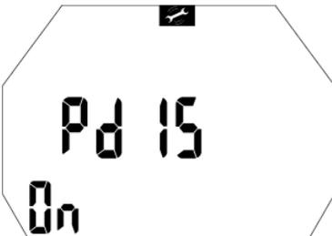
1. Confirme que desea habilitar la PDIS pulsando . "On" u "off" comenzarán a parpadear. "On" indica que el temporizador de PDIS se activará automáticamente durante la inmersión, mientras que "off" indica que la PDIS estará inactiva.
