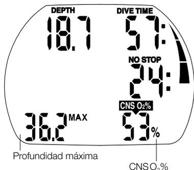
La profundidad máxima sólo se muestra si supera la profundidad actual en más de 1 m (función de indicador máximo). Si la profundidad máxima no se muestra, Aladin TEC 3G muestra la temperatura.
