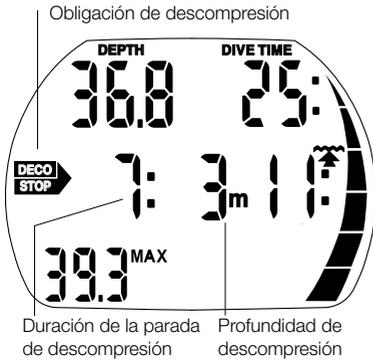
Al entrar en la fase de descompresión, "NO STOP" desaparece, el símbolo aparece y se emite un pitido de atención. La barra de la carga de nitrógeno deja de parpadear y el 6º segmento se ilumina (zona roja). Se muestra la etapa de descompresión más profunda en metros (pies) y la duración de la parada de descompresión de la etapa mostrada aparece en minutos. La pantalla "7: 3 m" significa que se debe realizar una parada de descompresión de 7 minutos a una profundidad de 3 m.
