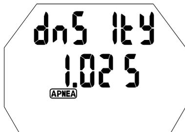
Con este ajuste, puede optimizar la precisión de la lectura de la profundidad si conoce la salinidad del agua.
