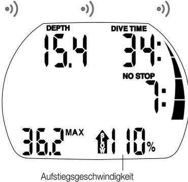
Die optimale Aufstiegsgeschwindigkeit beträgt abhängig von der Tiefe 7 bis 20 m/Min. Sie wird in Prozent der variablen Aufstiegsgeschwindigkeit angezeigt. Ist die Aufstiegsgeschwindigkeit höher als 100% des eingestellten Werts, wird der schwarze Pfeil „SLOW“ (langsam) angezeigt. Wenn die Aufstiegsgeschwindigkeit 140 % übertrifft, beginnt der Pfeil zu blinken.
