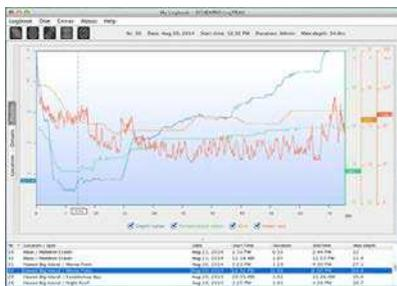
Dettagli (details) fornisce dati sull'immersione, fra i quali è possibile modificare, per esempio, le informazioni sull'attrezzatura e sulla bombola.
