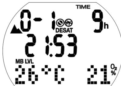
Dalla schermata dell'ora del giorno, è possibile controllare il tempo di desaturazione\* tenendo premuto il pulsante destro. Il tempo di desaturazione è determinato dalla tossicità da ossigeno, dalla saturazione di azoto o dalla regressione delle microbolle, a seconda di quale di tali fattori richieda il tempo più lungo.
