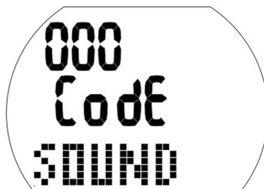
☞ **NOTA:** L'impostazione dell'opzione "sound" (suoni) su "off" si applica anche alle funzioni di superficie (allarme di altitudine e cambio della classe di altitudine).
