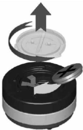
Procedura di sostituzione della batteria
