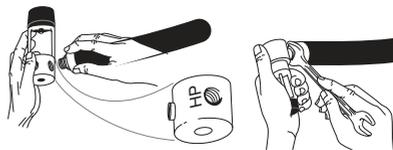
Apriete la conexión con la llave apropiada. Conexión del ordenador de buceo con el mecanismo de desconexión rápida (opcional).
